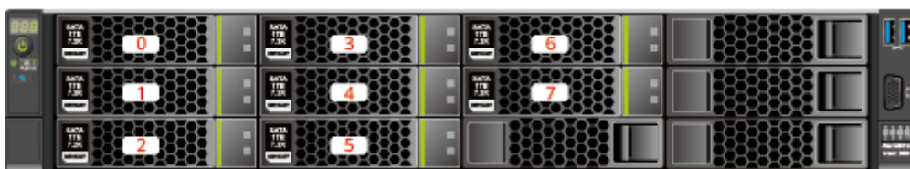
图2-9 8x3.5 英寸硬盘直通配置
