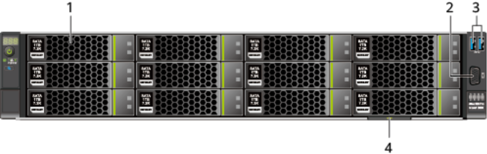
图2-1 12x3.5 英寸硬盘配置前面板组件
