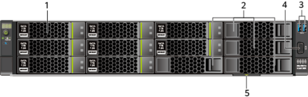
图2-2 8x3.5 英寸硬盘配置前面板组件
