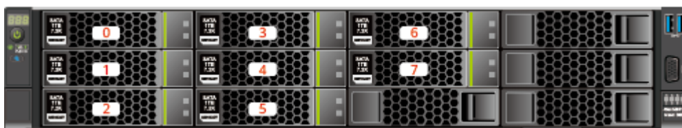
图2-9 8x3.5 英寸硬盘直通配置
