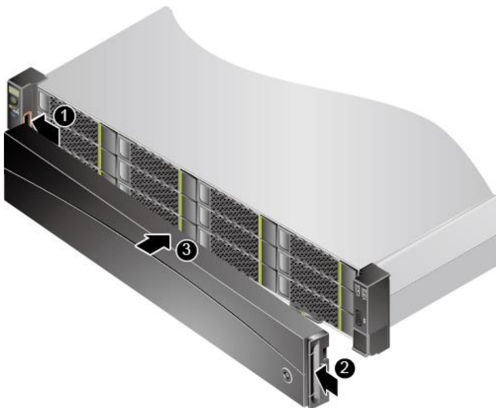
图5-18 安装安全面板
