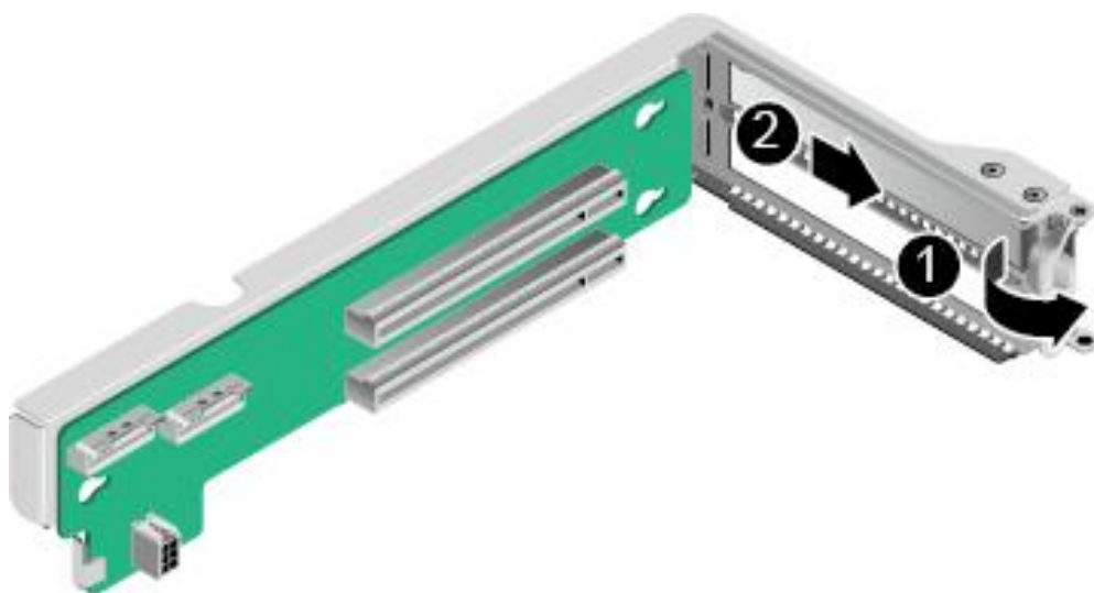
图 5-55 拆卸 PCIe 空闲挡板
