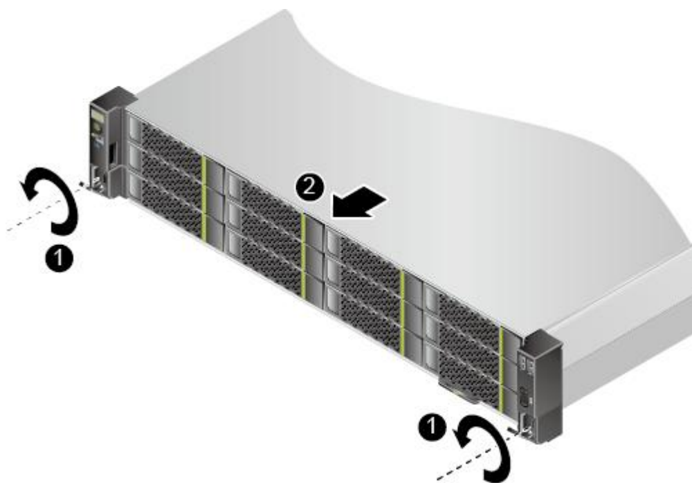
图 5-13 拆卸服务器
