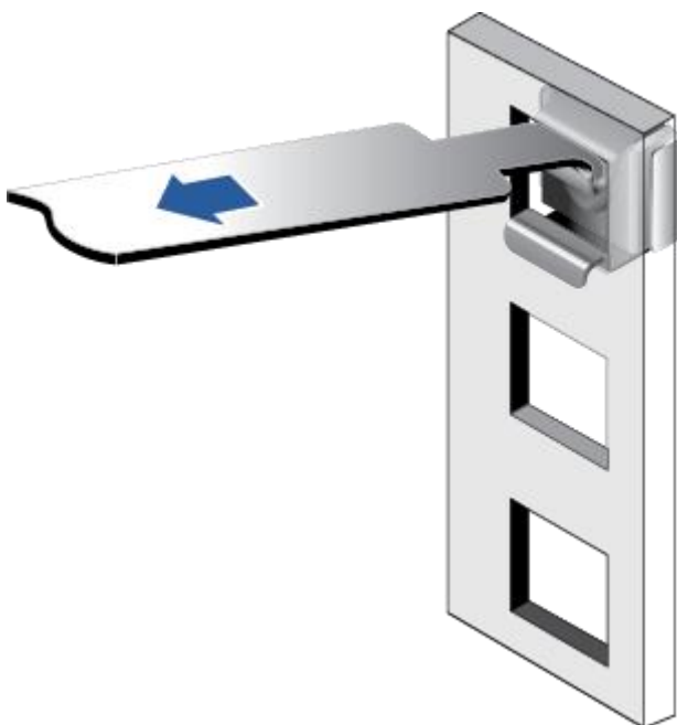
图 5-8 在机柜中安装浮动螺母
