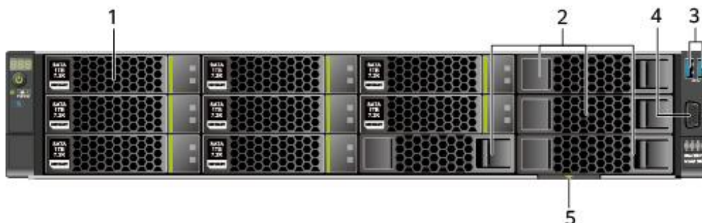
图 2-2 8x3.5 英寸硬盘配置前面板组件
