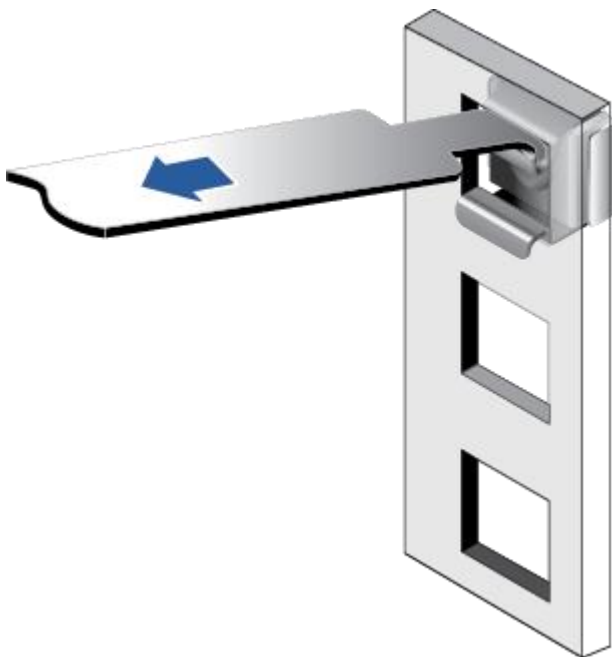
图 5-5 在机柜中安装浮动螺母
