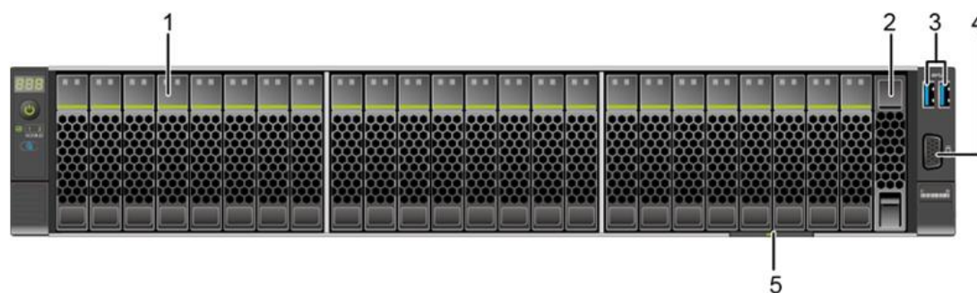
图 2-4 24x2.5 SAS/SATA 直通硬盘配置前面板组件
