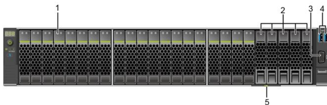
图 2-3 8x2.5 SAS/SATA+12x2.5 NVMe 硬盘配置前面板组件
