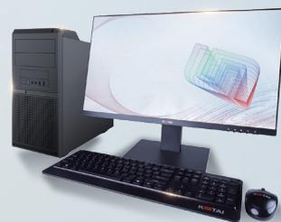
神州数码KunTai F500是基于飞腾D2000处理器推出的国产化商用台式机,8核,主频2.3GHz,搭配高性能独立显卡,具备多个显示输出接口。23L大容积机箱,预留扩展空间,同时采用顶置提手,免工具拆卸等人性化设计。产品兼容业界主流内存、硬盘、网卡等硬件,支持KOS/UOS桌面操作系统,具有高性能、高可靠性、高易用性等特点。适用于党政、金融、能源、电信等重点行业信息化领域,满足用户日常固定办公、OA、事务处理等需求。
