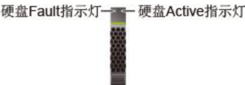
图 5-8 NVMe 硬盘指示灯示意图
