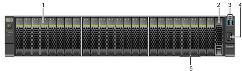
图4-4 24x2.5 SAS/SATA 直通硬盘配置前面板组件
