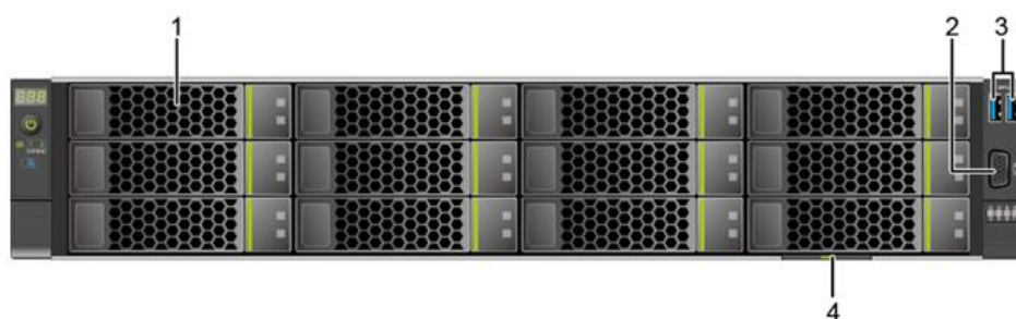
图4-1 12x3.5 英寸硬盘配置前面板组件
