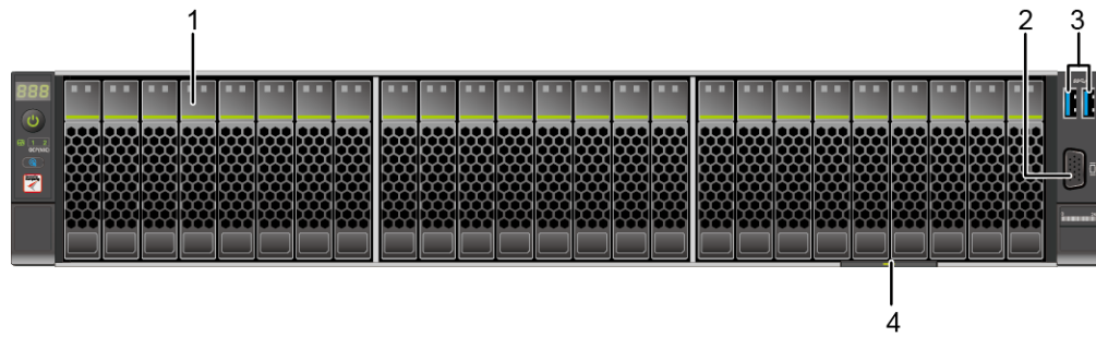
图4-2 25x2.5 英寸硬盘配置前面板组件
