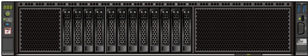
图5-3 4x2.5 SAS/SATA+8x2.5 NVMe 硬盘配置的前面板
