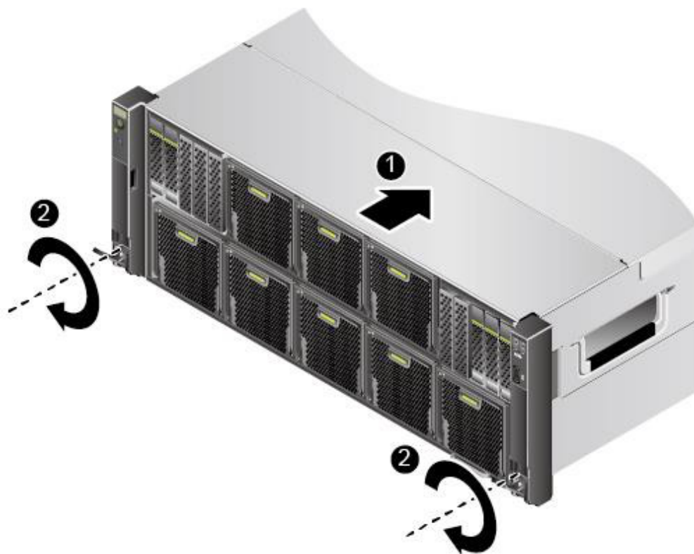
图5-11 安装服务器
