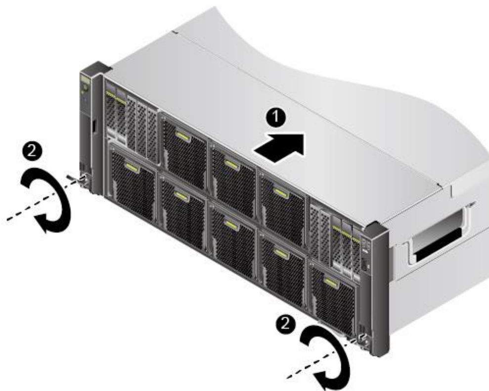
图5-7 安装服务器
