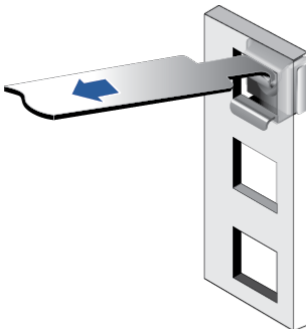
图5-5 在机柜中安装浮动螺母
