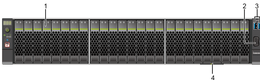
图4-2 25x2.5 英寸硬盘配置前面板组件
