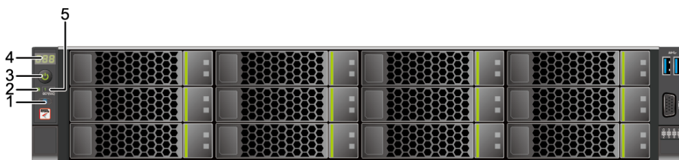
图4-5 12x3.5 英寸硬盘配置前面板指示灯和按钮
