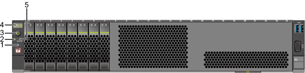
图4-8 8x2.5 英寸硬盘配置前面板指示灯和按钮
