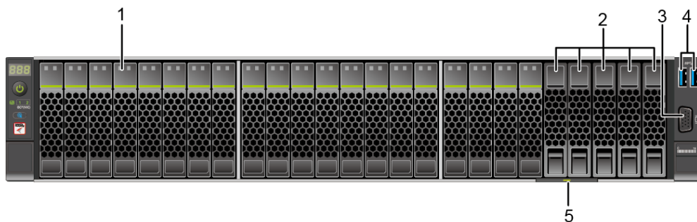
图4-3 8x2.5 SAS/SATA+12x2.5 NVMe 硬盘配置前面板组件
