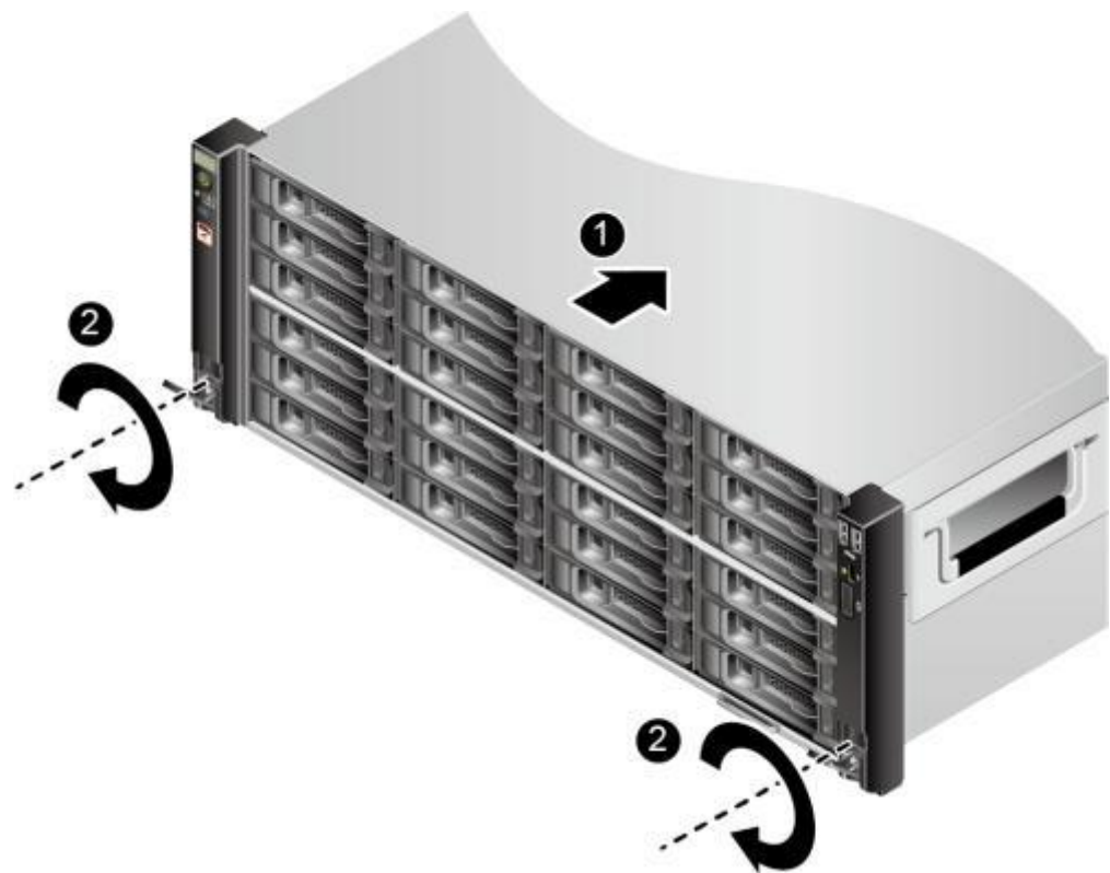
图 9-9 安装服务器
