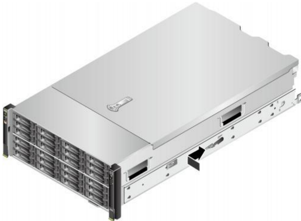
图 9-12 将服务器固定在内轨上（1）
