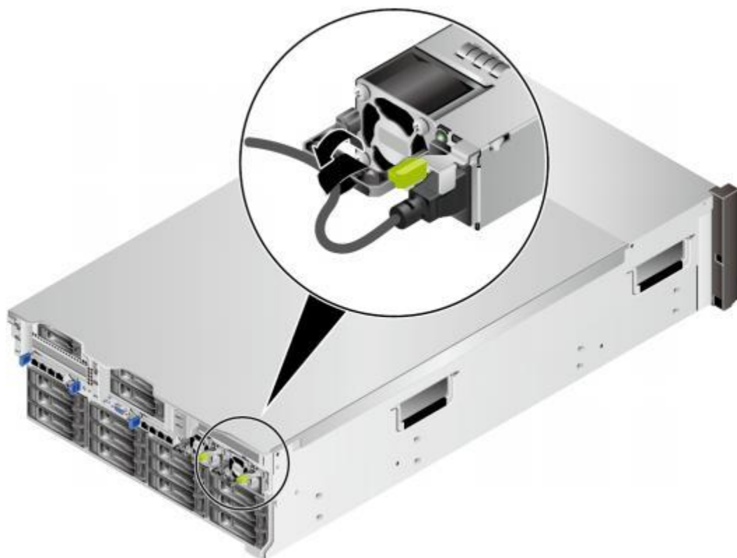
图 9-26 固定电源线缆
