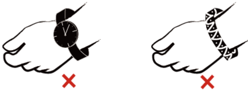
图5-1 去除易导电的物体
