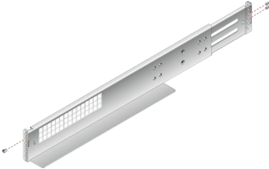
图5-9 安装限位销钉
