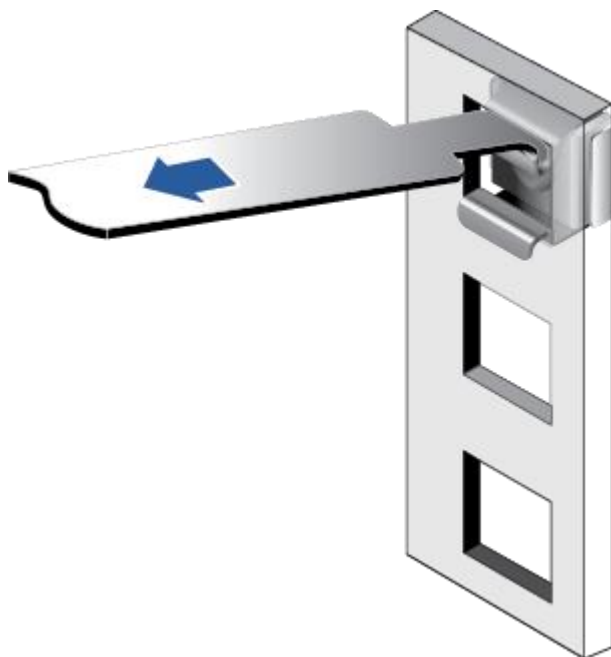
图 6-4 在机柜中安装浮动螺母
