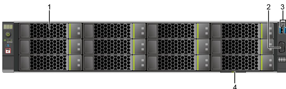
图 3-1 12x3.5 英寸硬盘配置前面板组件
