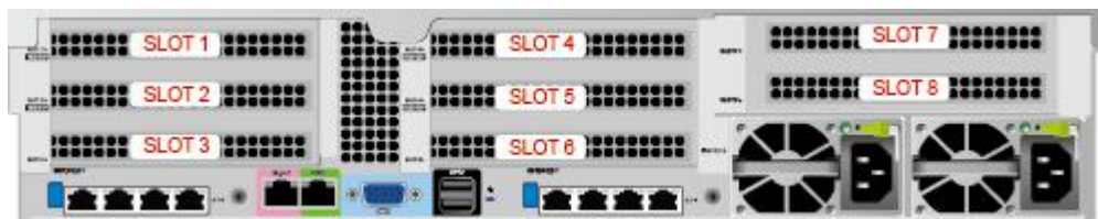
图 3-37 PCIe 插槽
