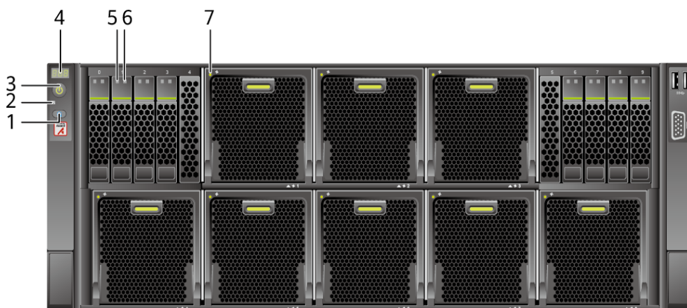
图6-5 8x2.5 英寸硬盘配置的前面板指示灯和按钮
