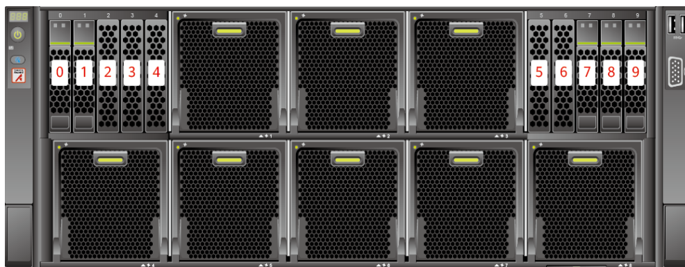
图6-23 5x2.5 英寸硬盘配置及硬盘编号
