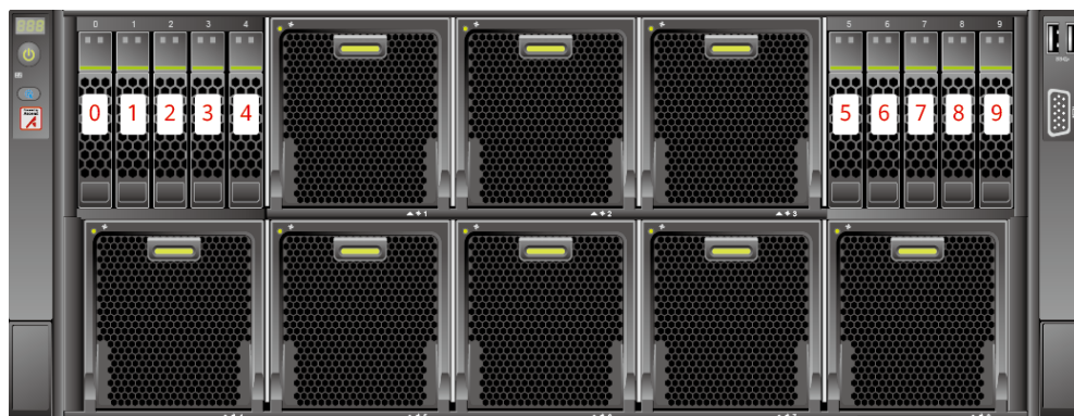
图6-25 10x2.5 英寸硬盘配置及硬盘编号
