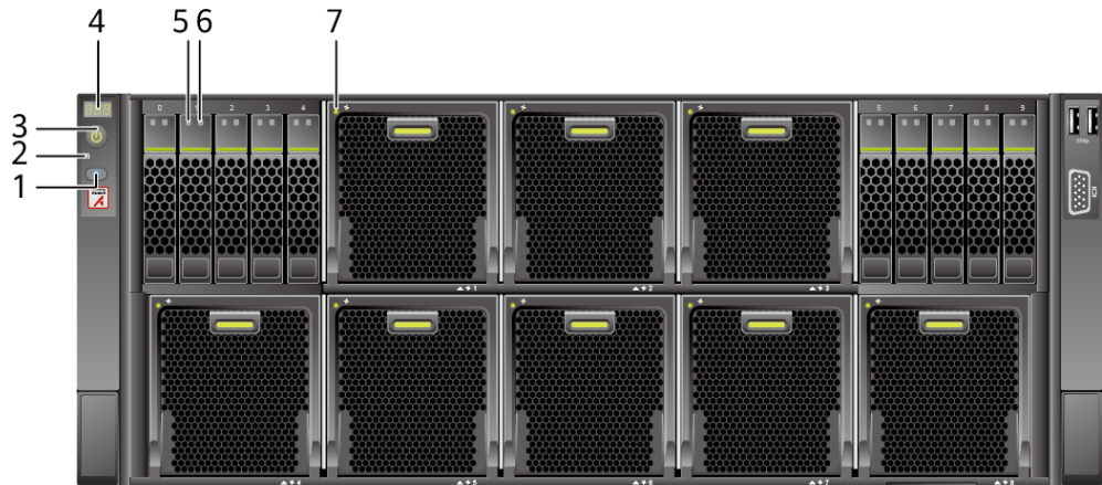
图6-6 10x2.5 英寸硬盘配置的前面板指示灯和按钮
