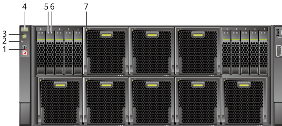
图2-6 10x2.5 英寸硬盘配置的前面板指示灯和按钮
