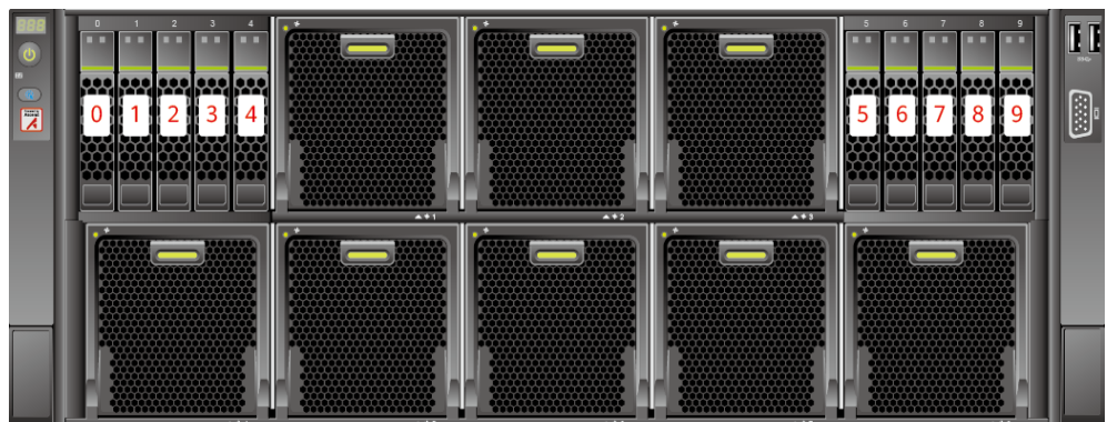
图2-15 10x2.5 英寸硬盘配置及硬盘编号
