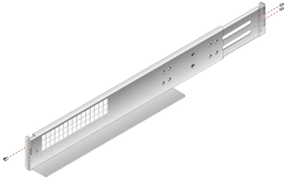
图5-9 安装限位销钉
