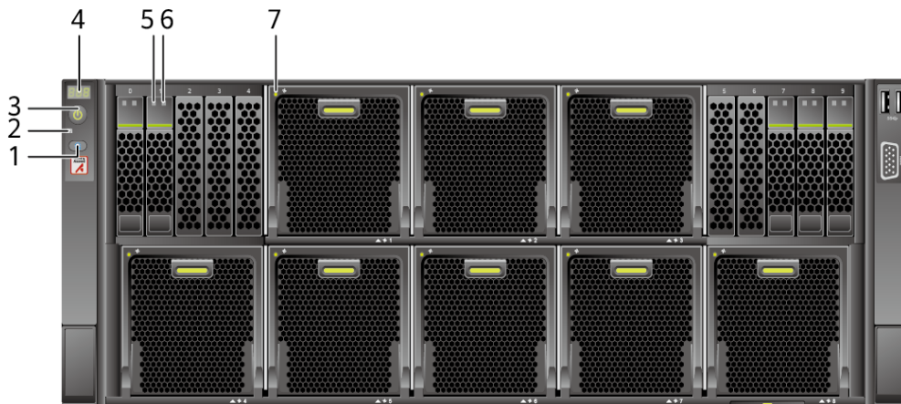
图2-4 5x2.5 英寸硬盘配置的前面板指示灯和按钮
