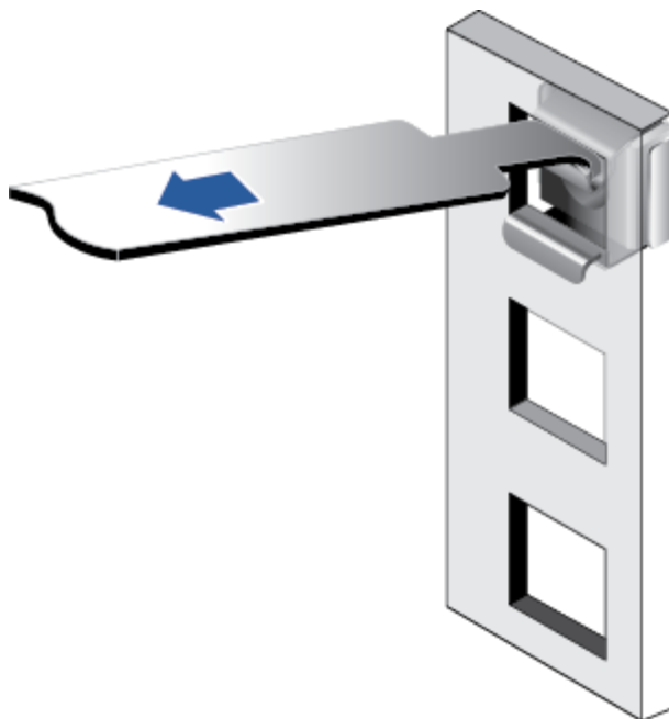
图5-5 在机柜中安装浮动螺母
