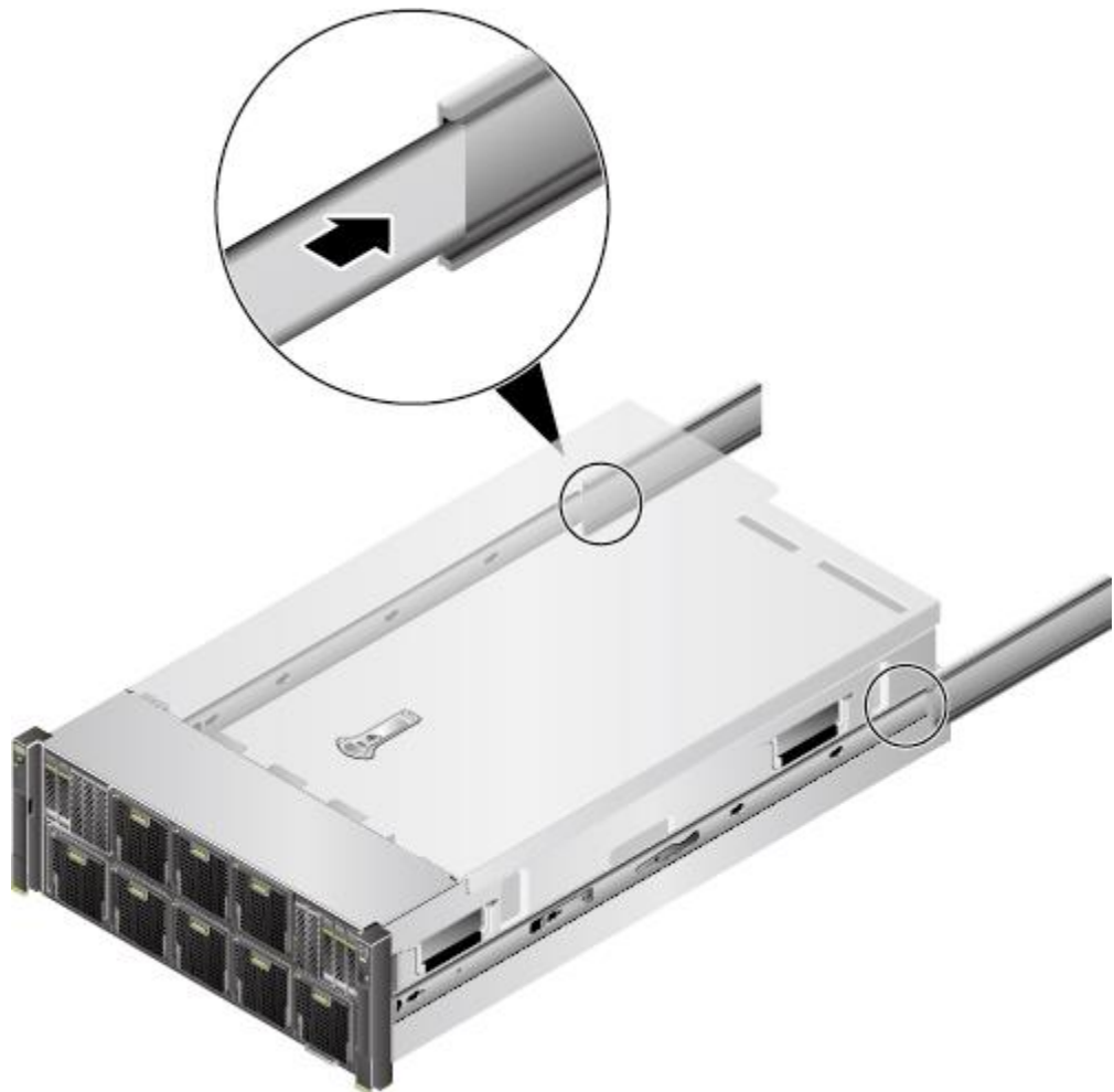
图5-15 内轨上安装服务器
