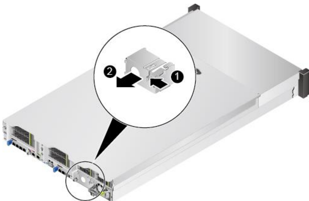
图5-30 拆卸电源空闲挡板
