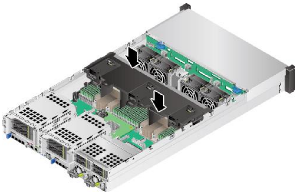
图5-37 安装导风罩
