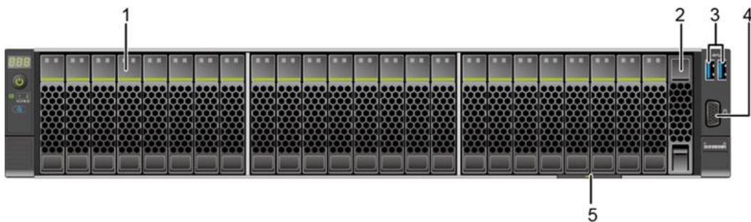
图2-4 24x2.5 SAS/SATA 直通硬盘配置前面板组件
