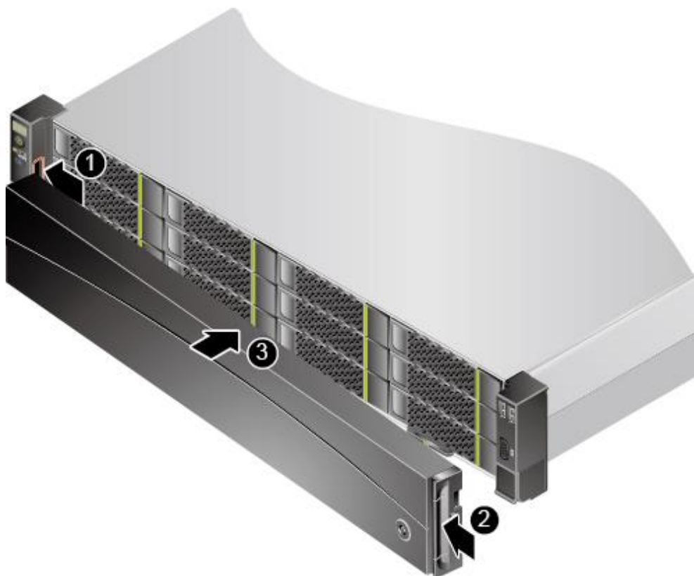
图5-15 安装安全面板
