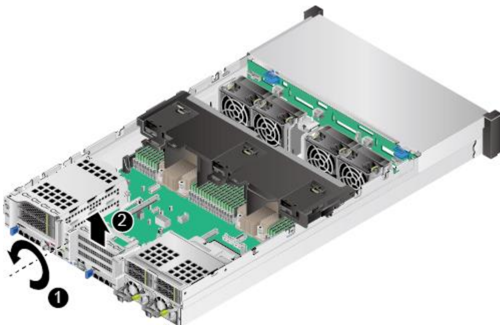
图5-49 拆卸空闲挡板 (2)
