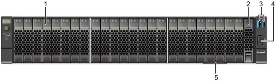
图4-4 24x2.5 SAS/SATA 直通硬盘配置前面板组件
