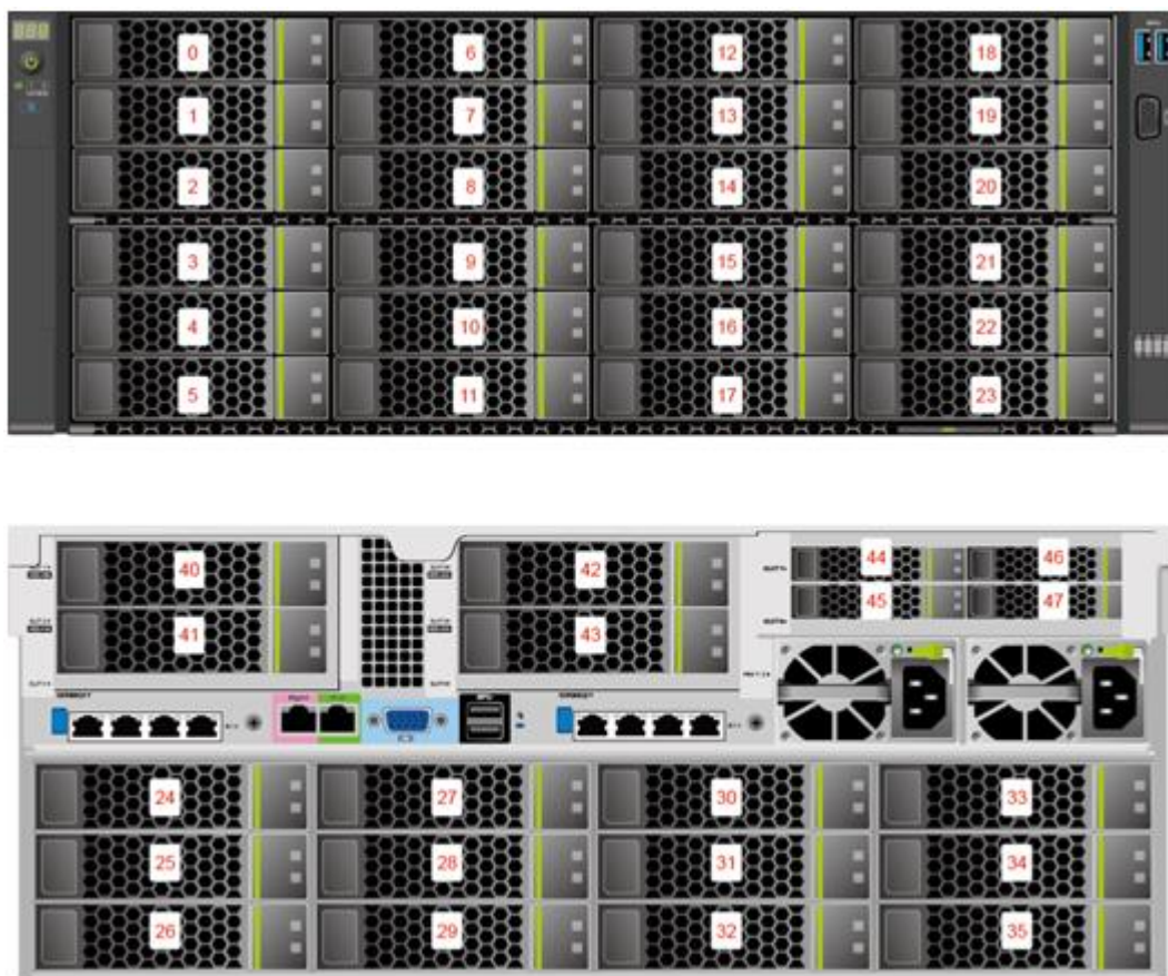
图2-8 36x3.5 英寸 EXP 机型的硬盘编号
