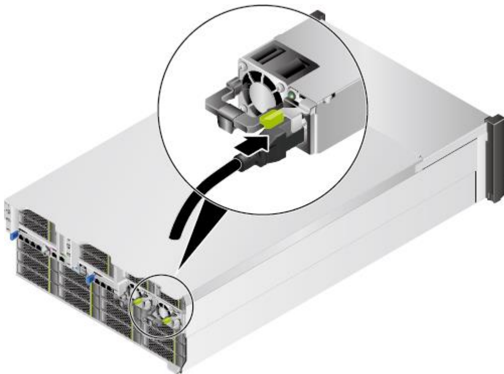
图5-19 连接电源线缆
