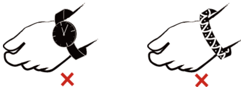
图5-1 去除易导电的物体
