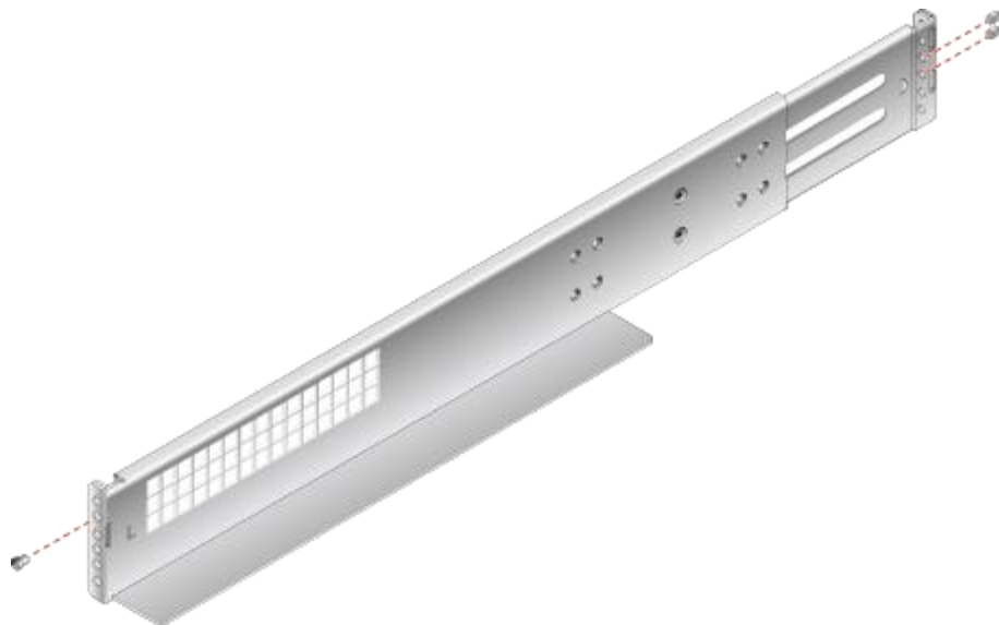
图5-9 安装限位销钉
