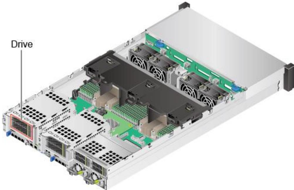
图5-151 36x3.5 英寸硬盘机箱硬盘位置
