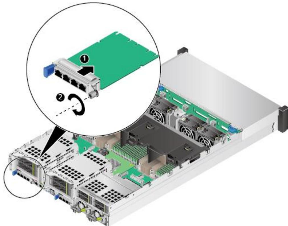
图5-135 36x3.5 英寸硬盘机箱安装灵活 IO 卡
