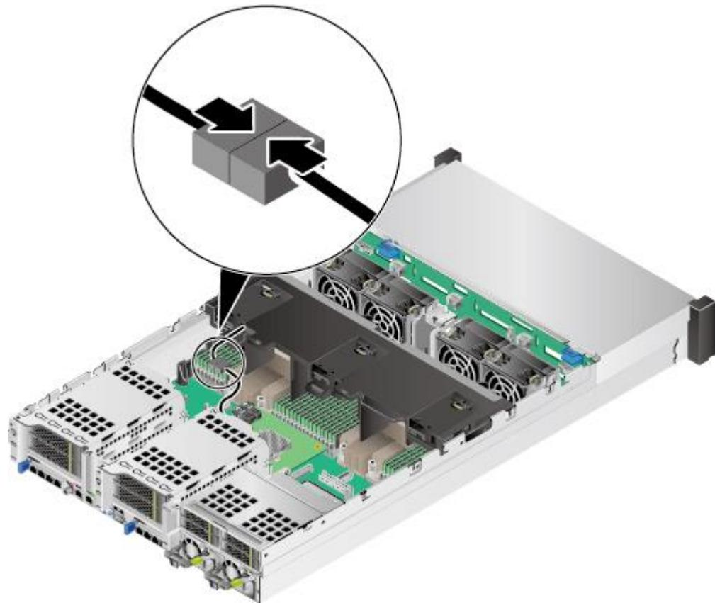
图5-66 36x3.5 英寸硬盘机箱连接超级电容线缆
