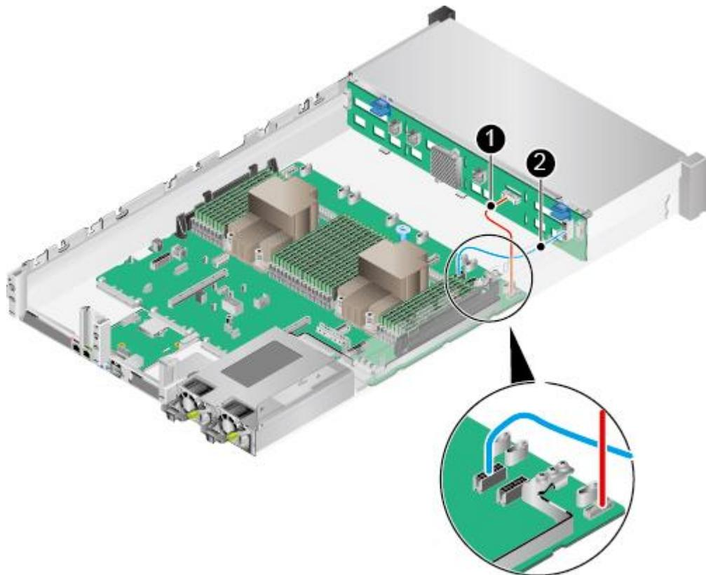
表3-3 前置硬盘背板的电源线和低速信号线连线
