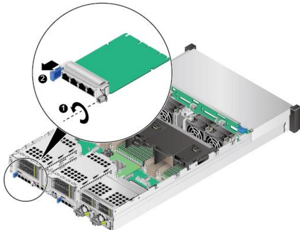
图5-129 36x3.5 英寸硬盘机箱拆卸灵活 IO 卡
