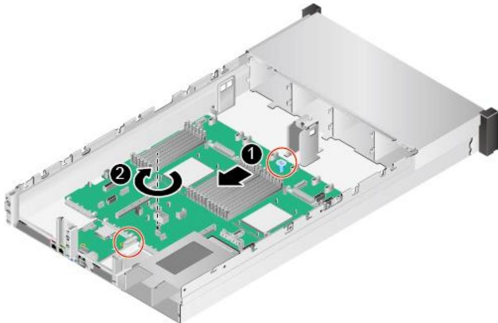
图5-192 36x3.5 英寸硬盘机箱安装主板
