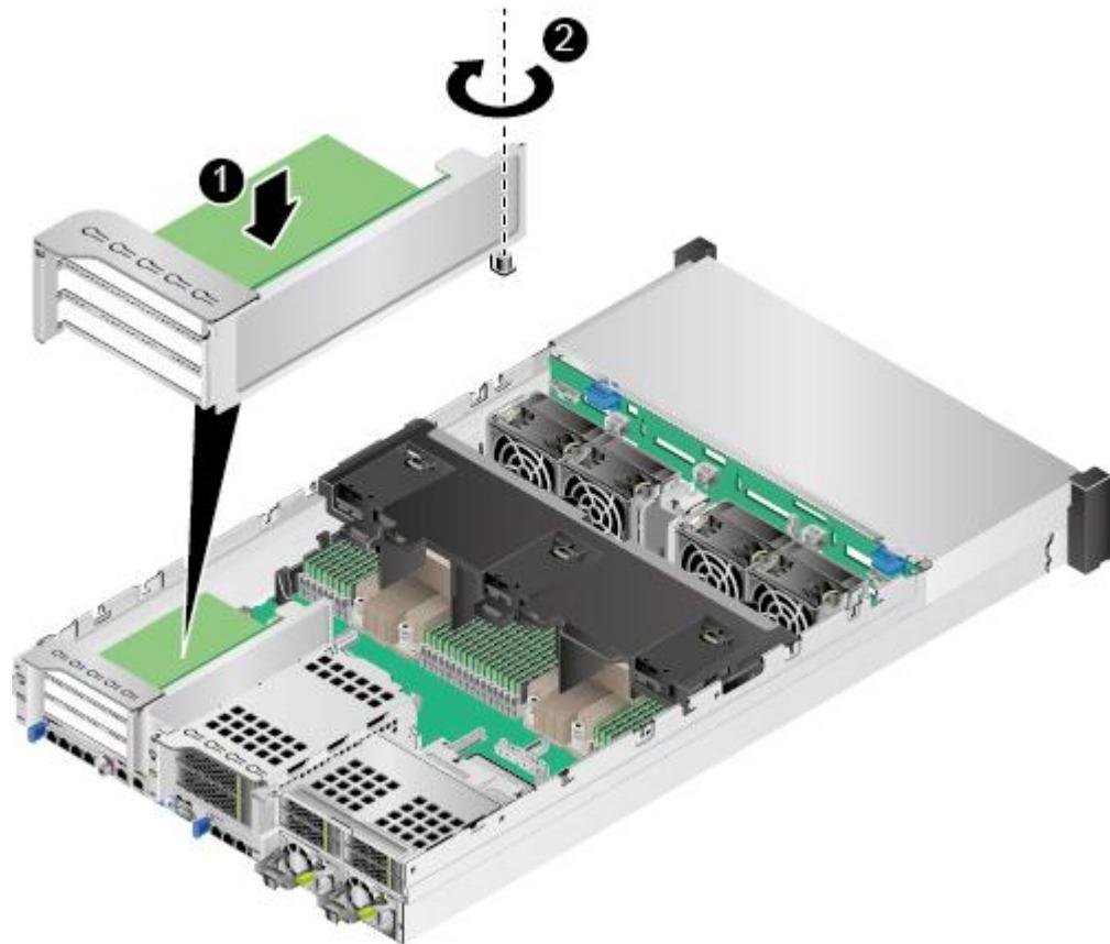
图5-92 36x3.5 英寸硬盘机箱安装 Riser 模组 1
