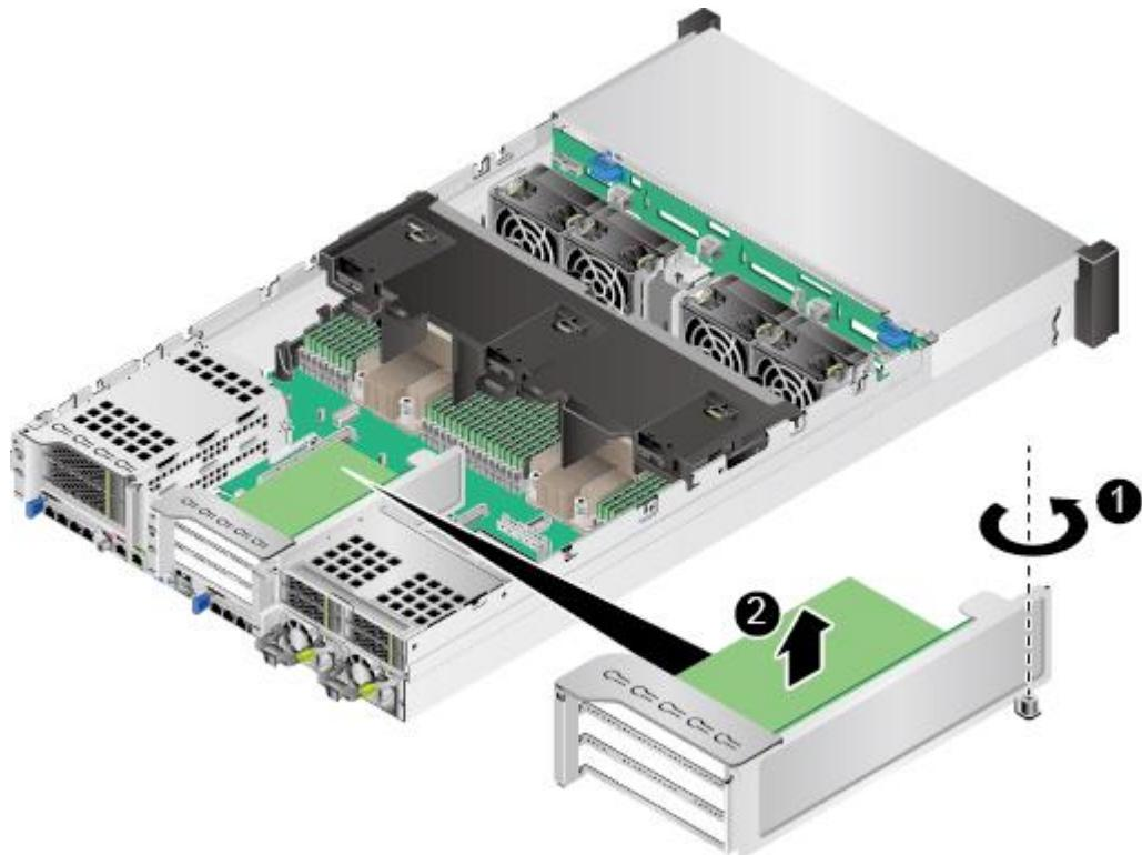
图5-74 36x3.5 英寸硬盘机箱拆卸 Riser 模组 2
