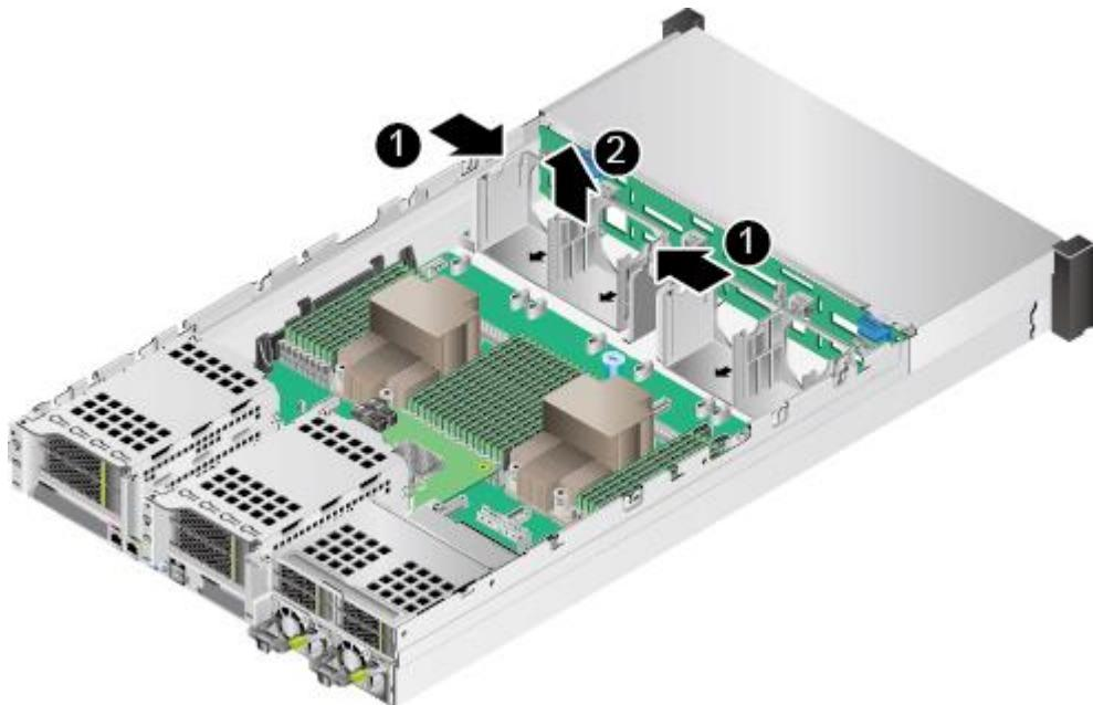
图5-178 36x3.5 英寸硬盘机箱拆卸风扇支架
