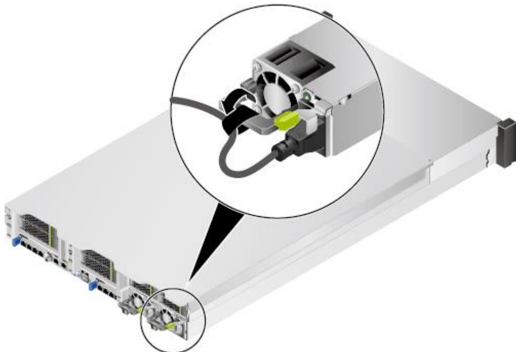
图5-44 36x3.5 英寸硬盘机箱固定电源线缆
