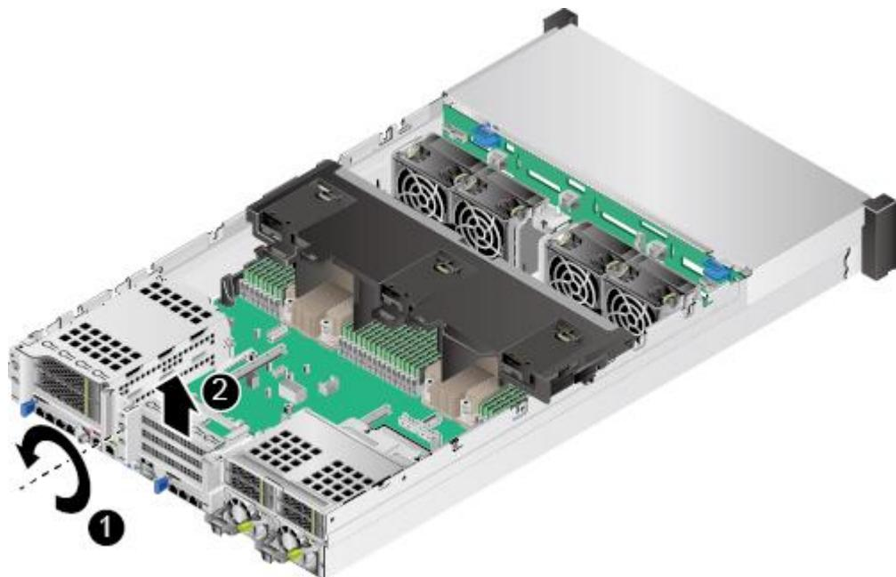
图5-88 36x3.5 英寸硬盘机箱拆卸空闲挡板 (2)
