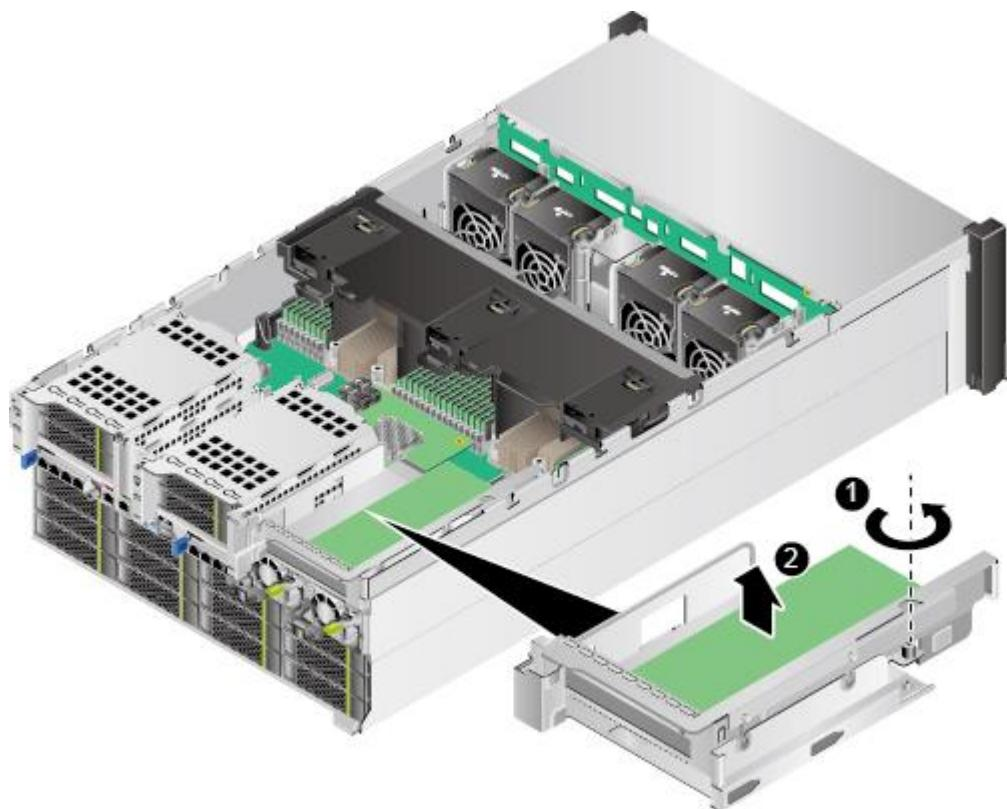
图5-77 25x2.5 英寸或 12x3.5 英寸硬盘机箱拆卸 Riser 模组 3 的下托架
