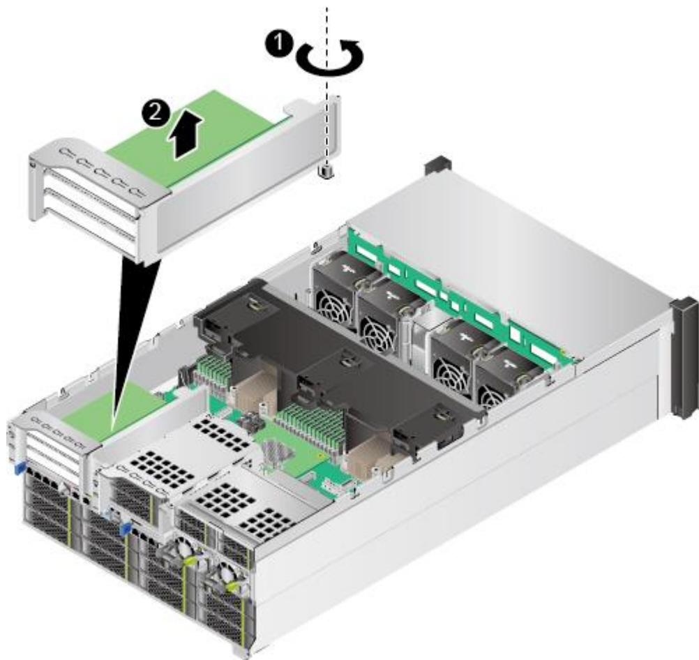
图5-73 25x2.5 英寸或 12x3.5 英寸硬盘机箱拆卸 Riser 模组 2
