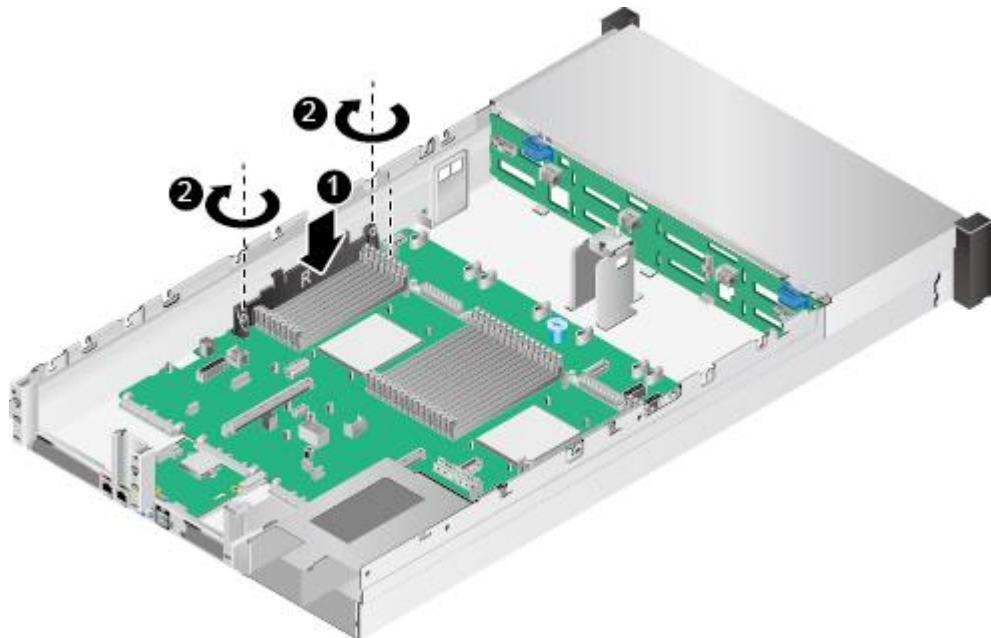
图5-194 36x3.5 英寸硬盘机箱安装理线架
