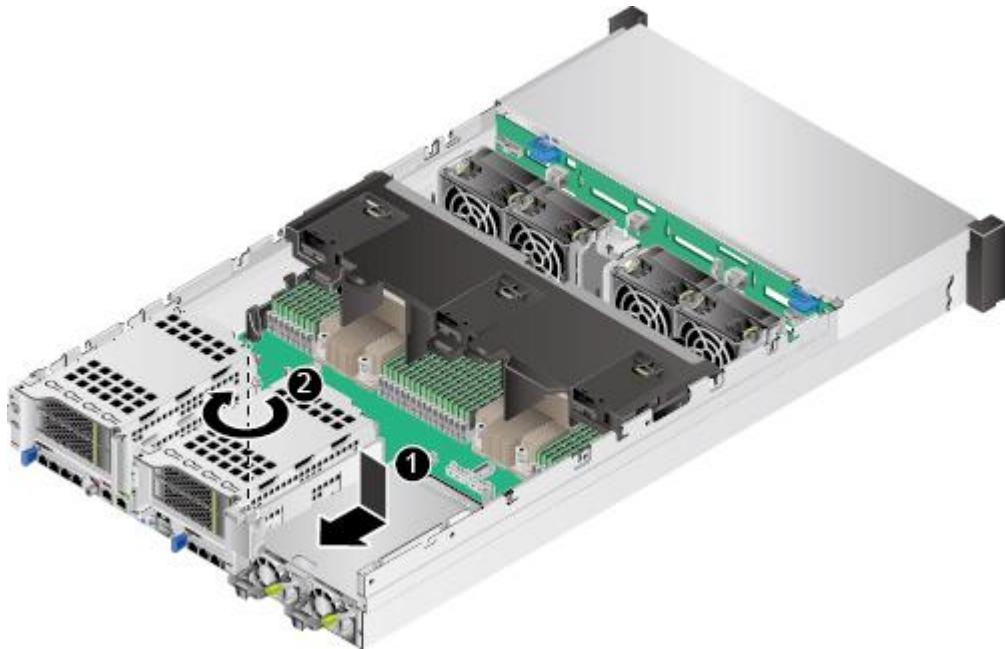
图5-96 36x3.5 英寸硬盘机箱安装 Riser 模组 3 的下托架
