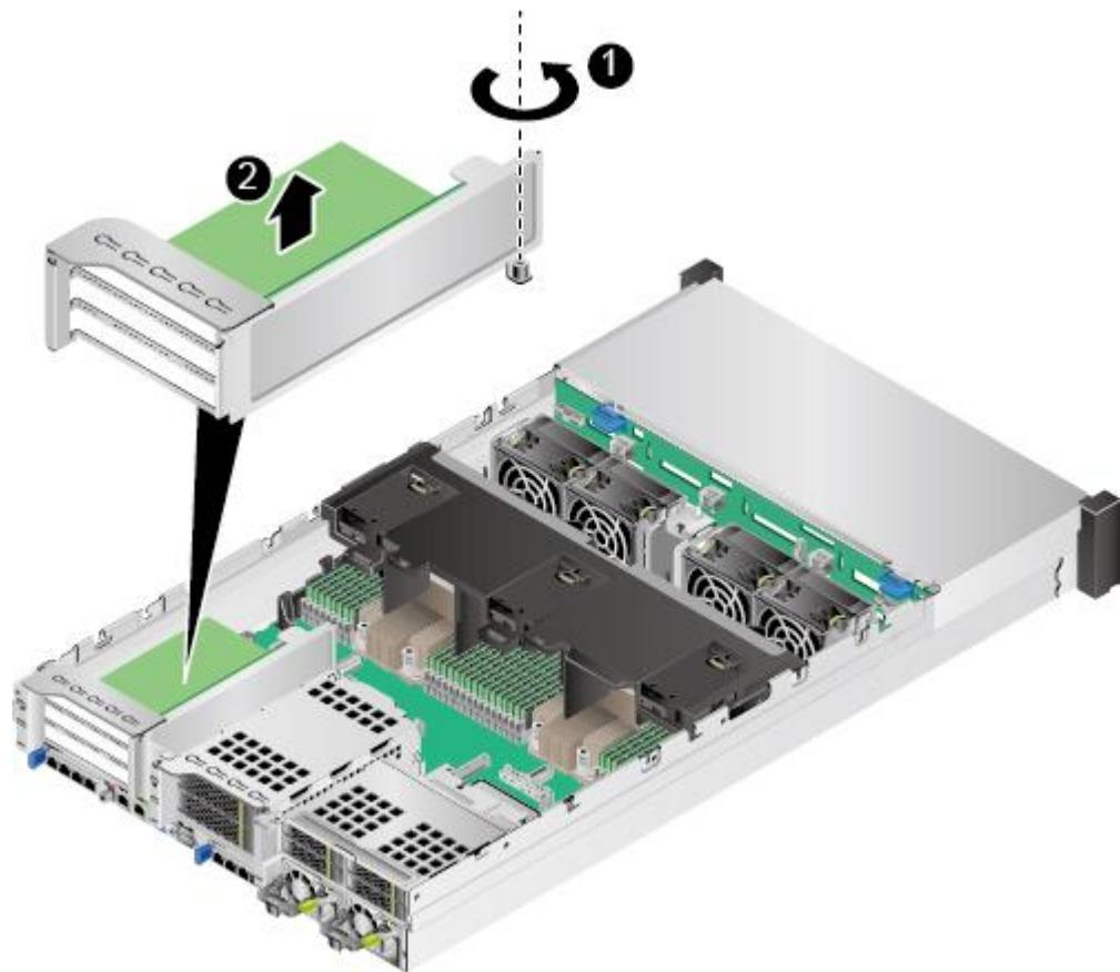
图5-72 36x3.5 英寸硬盘机箱拆卸 Riser 模组 1
