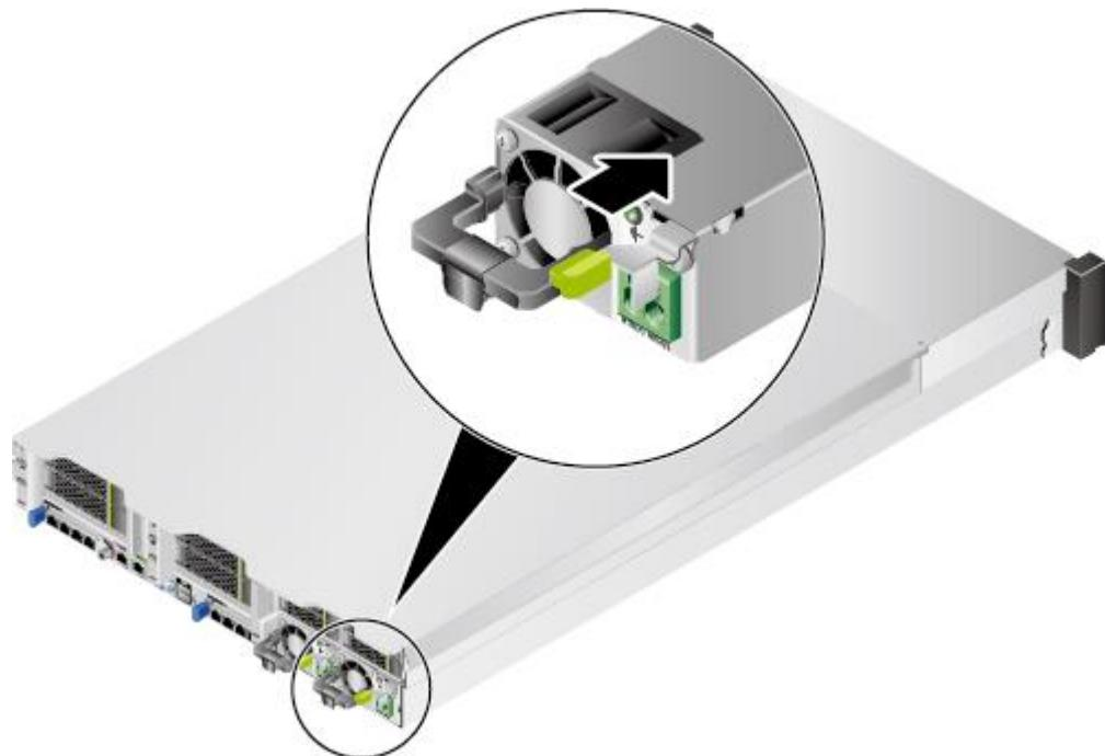
图5-53 36x3.5 英寸硬盘机箱安装电源模块
