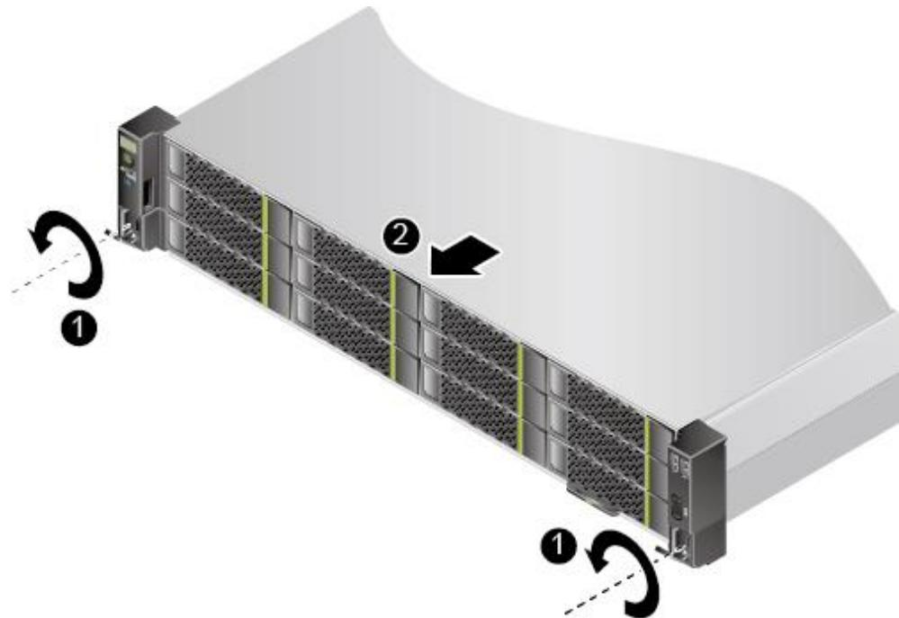
图5-17 36x3.5 英寸硬盘机箱拆卸服务器
