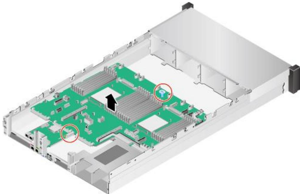
图5-188 36x3.5 英寸硬盘机箱拆卸主板
