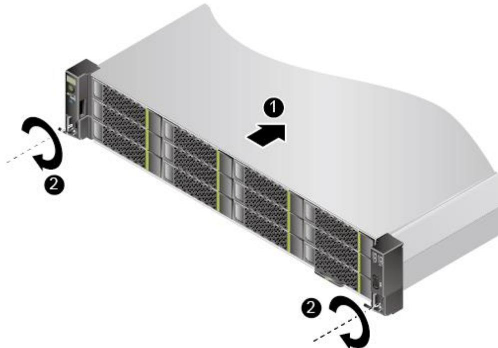
图5-7 36x3.5 英寸硬盘机箱安装服务器
