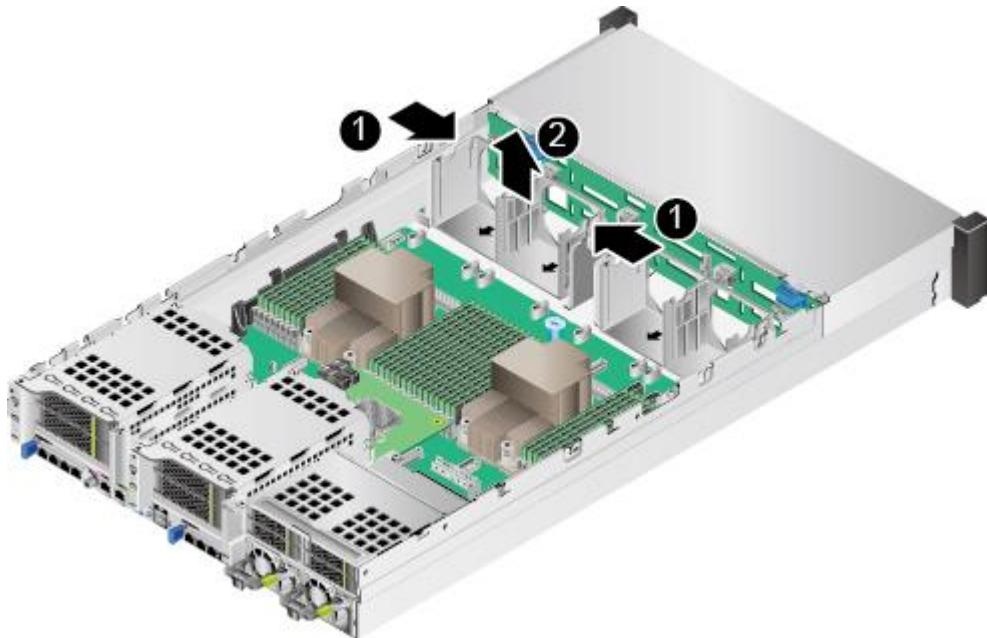
图5-137 36x3.5 英寸硬盘机箱拆卸风扇支架
