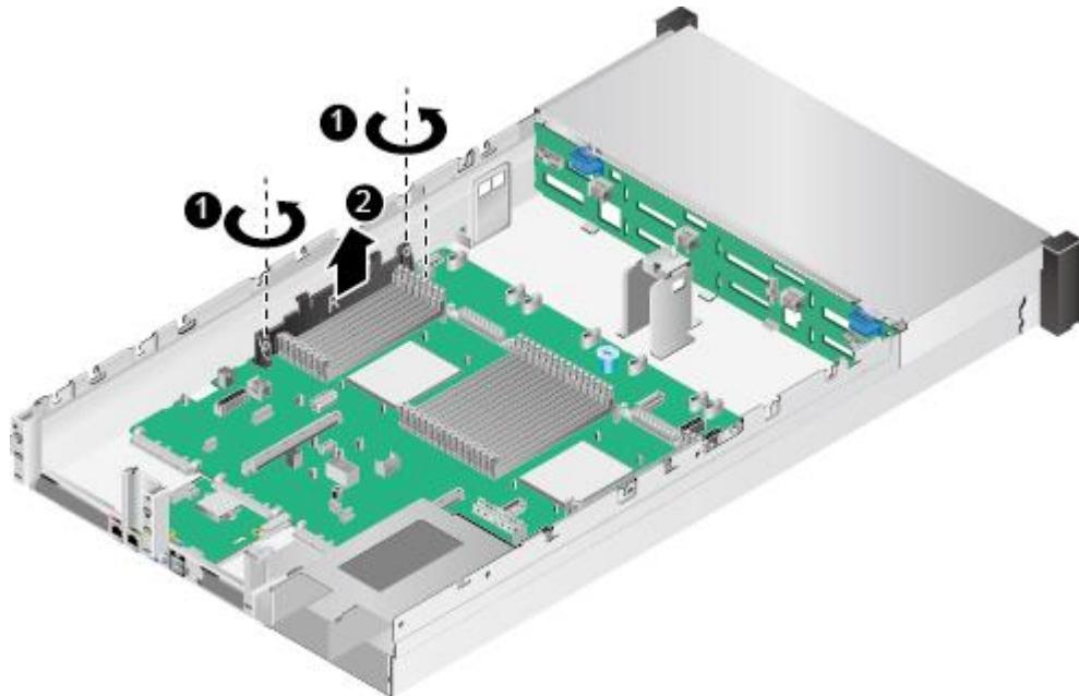
图5-184 36x3.5 英寸硬盘机箱拆卸理线架
