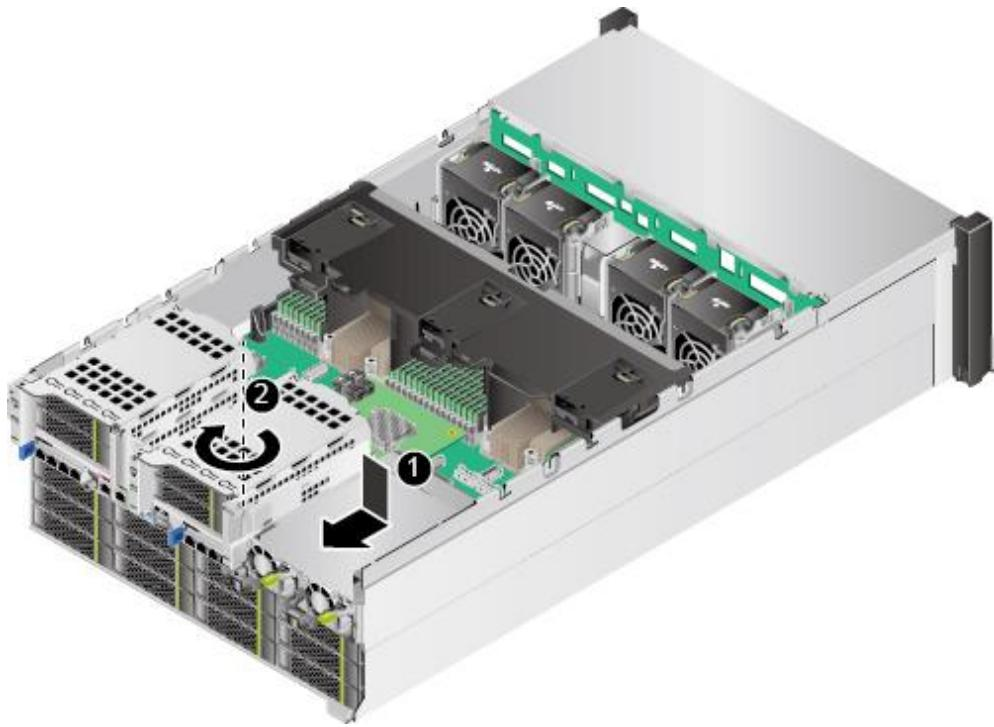
图5-97 25x2.5 英寸或 12x3.5 英寸硬盘机箱安装 Riser 模组 3 的上托架
