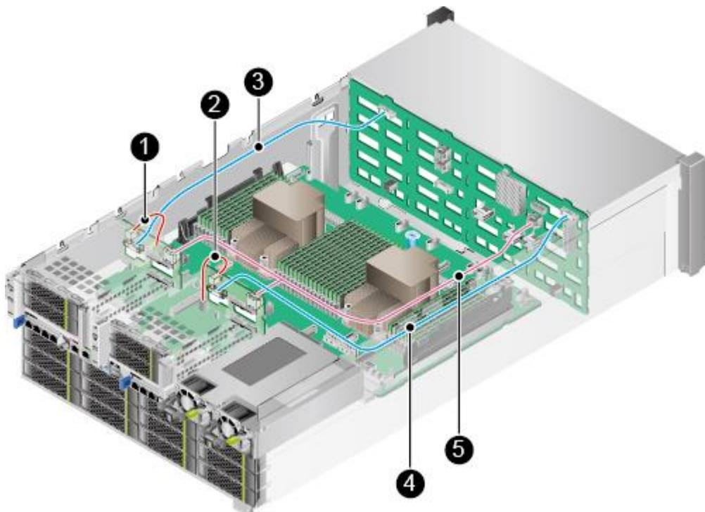
表3-17 IO 模组 1 和 IO 模组 2 硬盘背板连线
