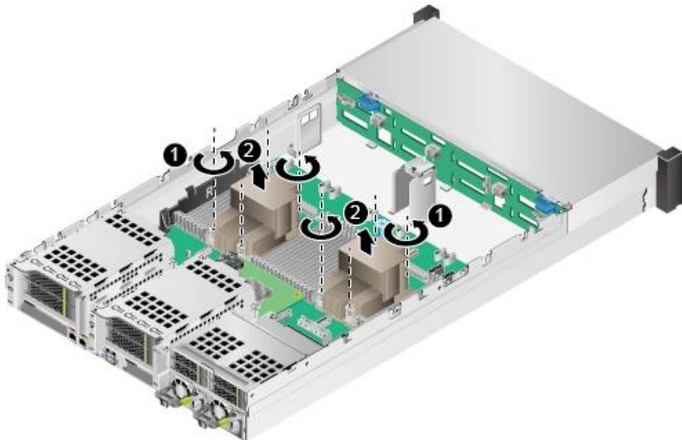
图5-180 36x3.5 英寸硬盘机箱拆卸 CPU 散热器
