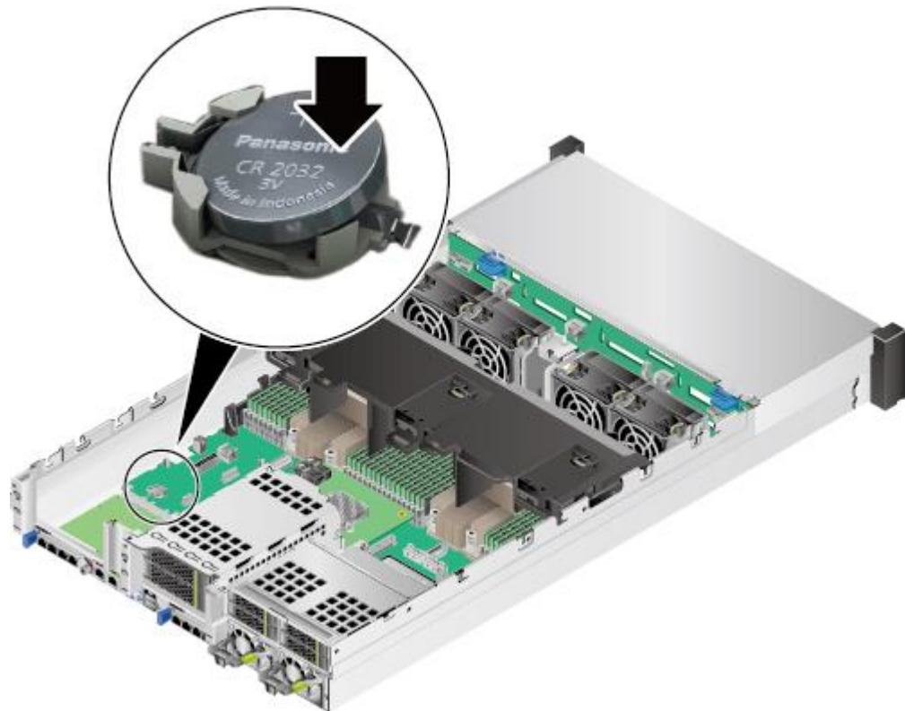
图5-110 36x3.5 英寸硬盘机箱安装电池
