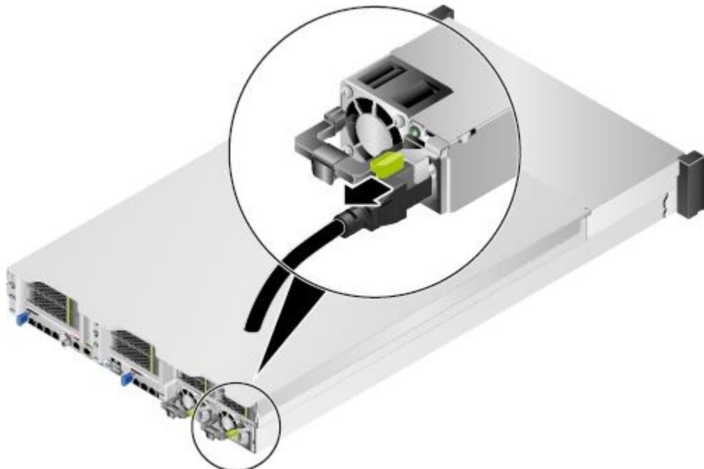
图5-32 36x3.5 英寸硬盘机箱拔出电源线缆
