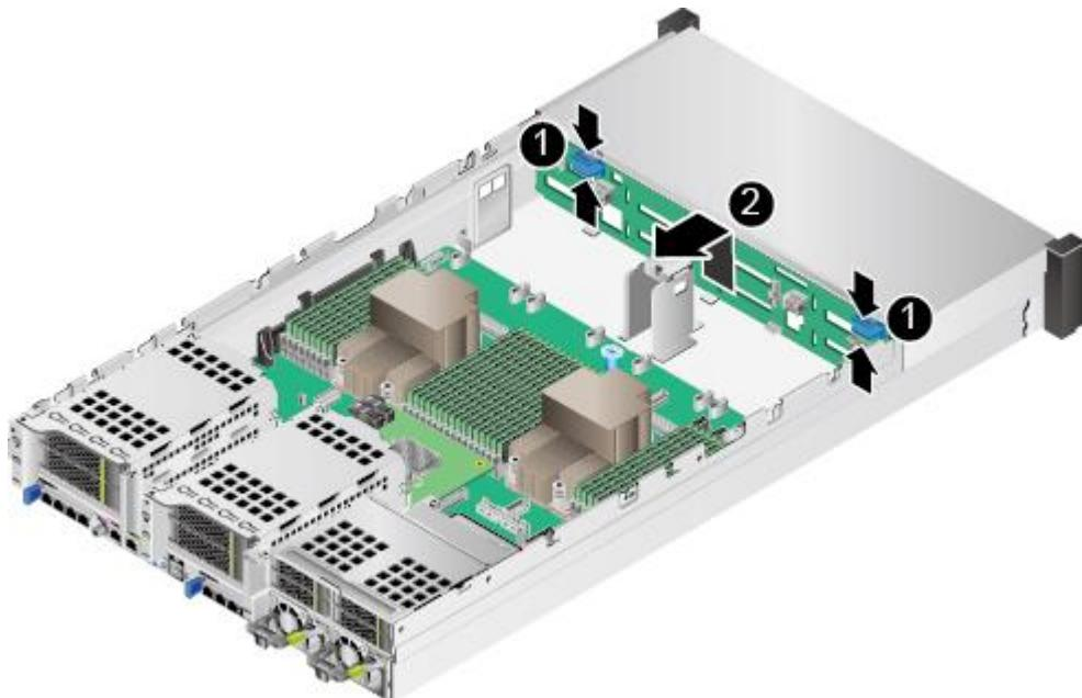
图5-139 36x3.5 英寸硬盘机箱拆卸前置硬盘背板
