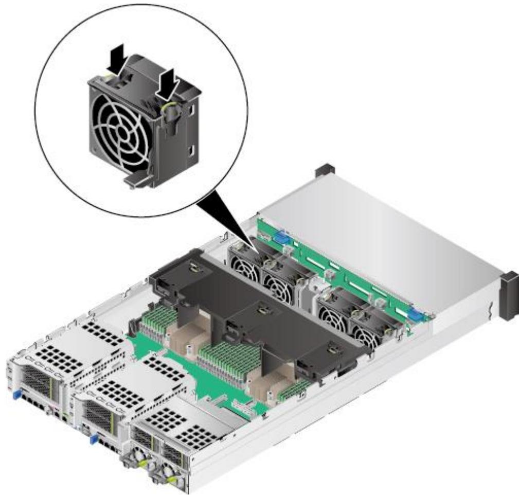
图5-70 36x3.5 英寸硬盘机箱安装风扇模块
