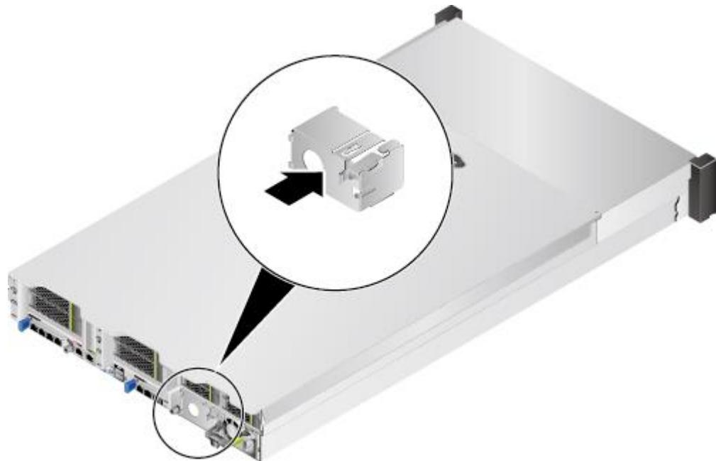
图5-49 36x3.5 英寸硬盘机箱安装电源空闲挡板
