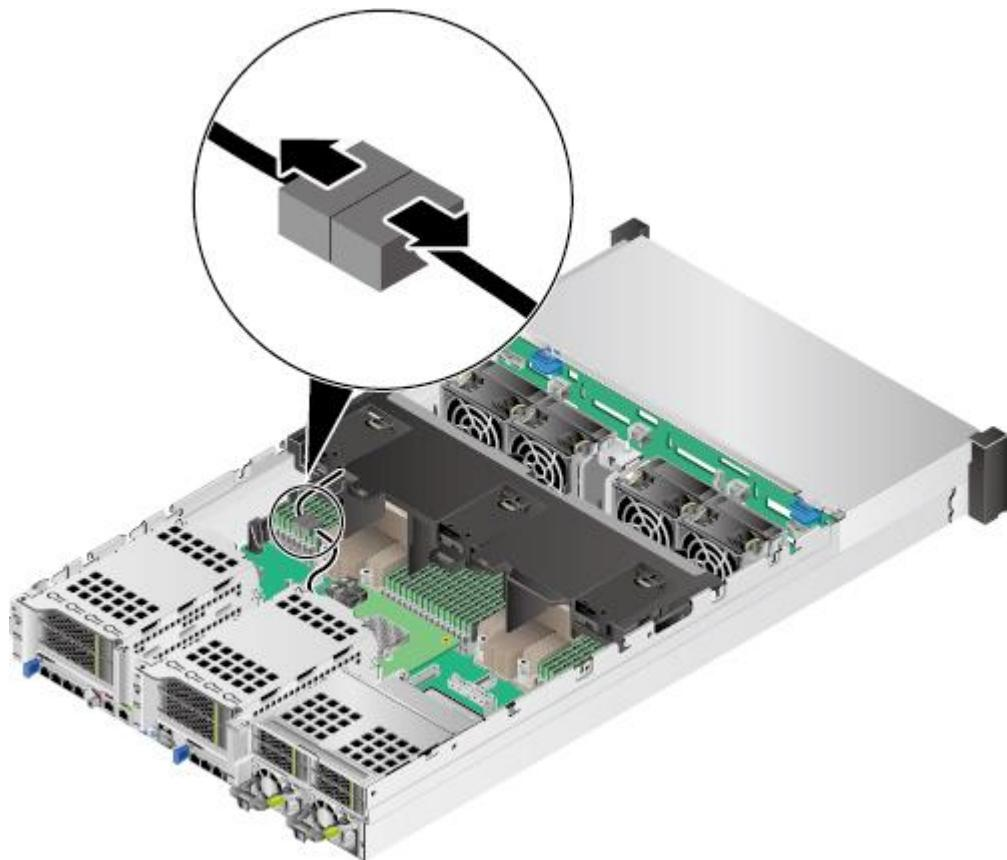
图5-60 36x3.5 英寸硬盘机箱拆卸超级电容线缆
