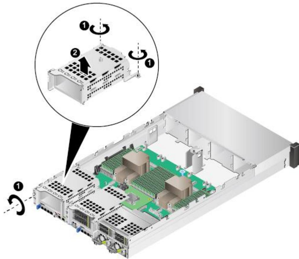
图5-147 36x3.5 英寸硬盘机箱拆卸后置硬盘组件
