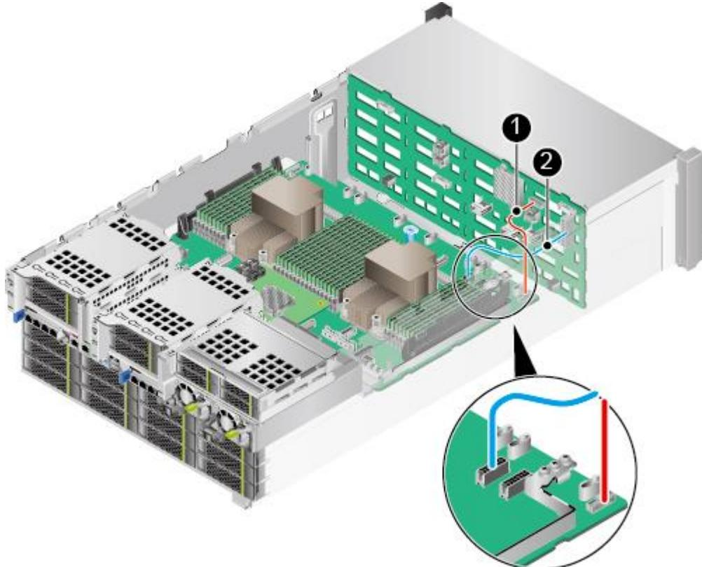
表3-13 前置硬盘背板的电源线和低速信号线
