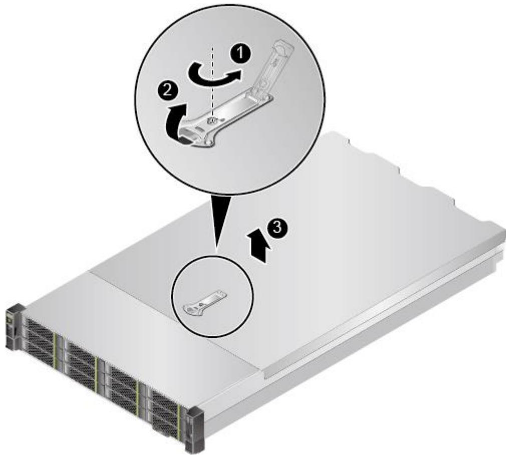
图5-56 36x3.5 英寸硬盘机箱拆卸机箱盖
