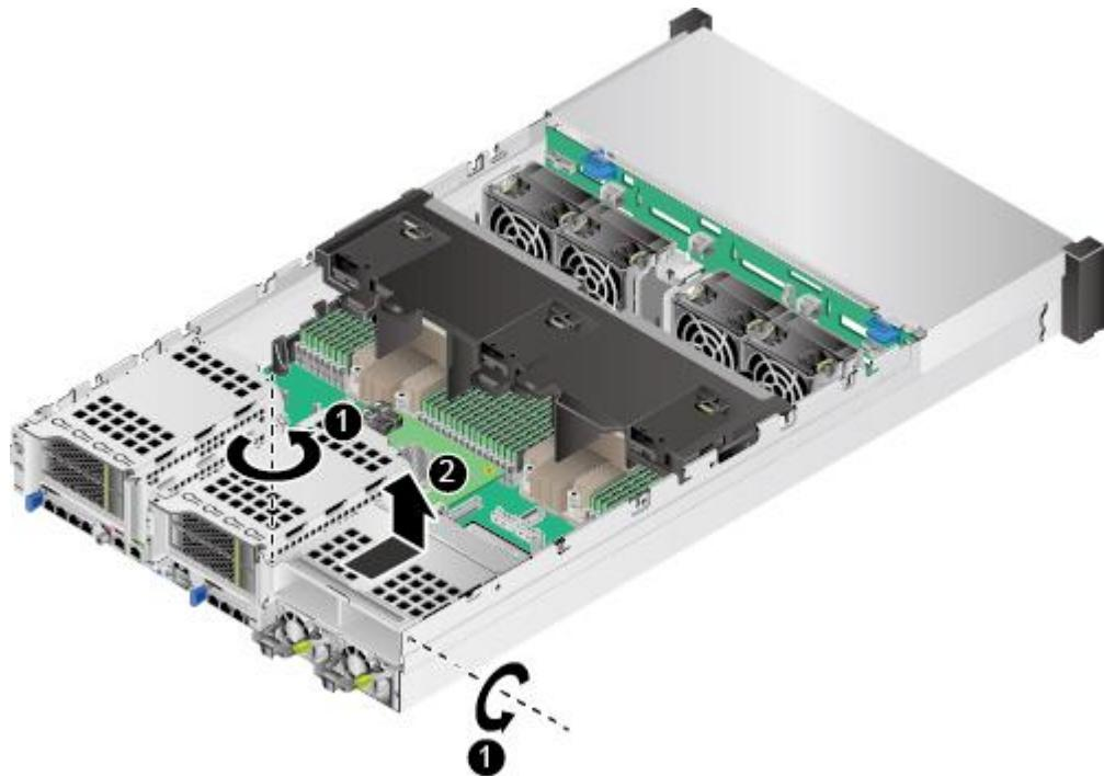
图5-155 36x3.5 英寸硬盘机箱拆卸后置硬盘组件
