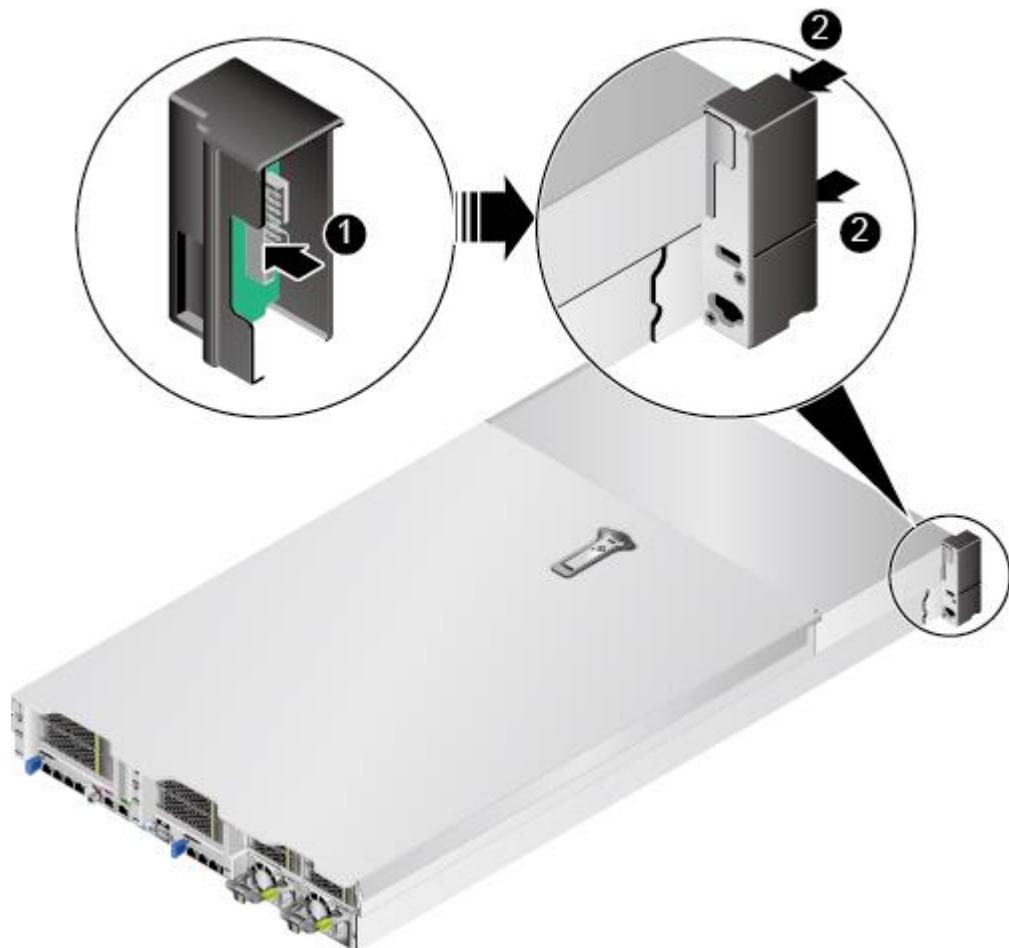
图5-172 36x3.5 英寸硬盘机箱安装左挂耳板
