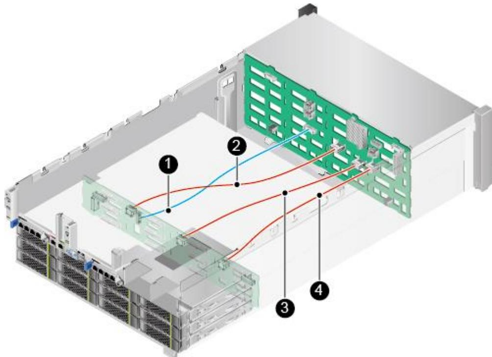
表3-15 后置 12 盘硬盘背板的 SAS 信号线和低速信号线
