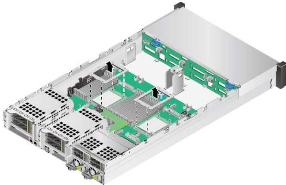
图5-182 36x3.5 英寸硬盘机箱拆卸 CPU 托架
