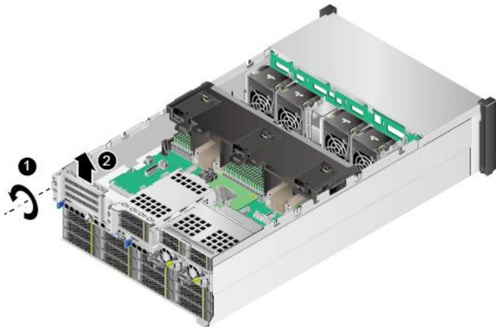
图5-87 25x2.5 英寸或 12x3.5 英寸硬盘机箱拆卸空闲挡板 (2)
