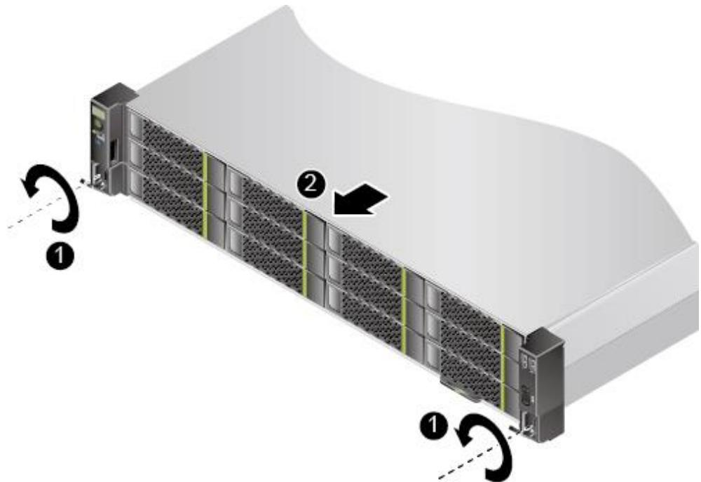
图5-14 36x3.5 英寸硬盘机箱拆卸服务器
