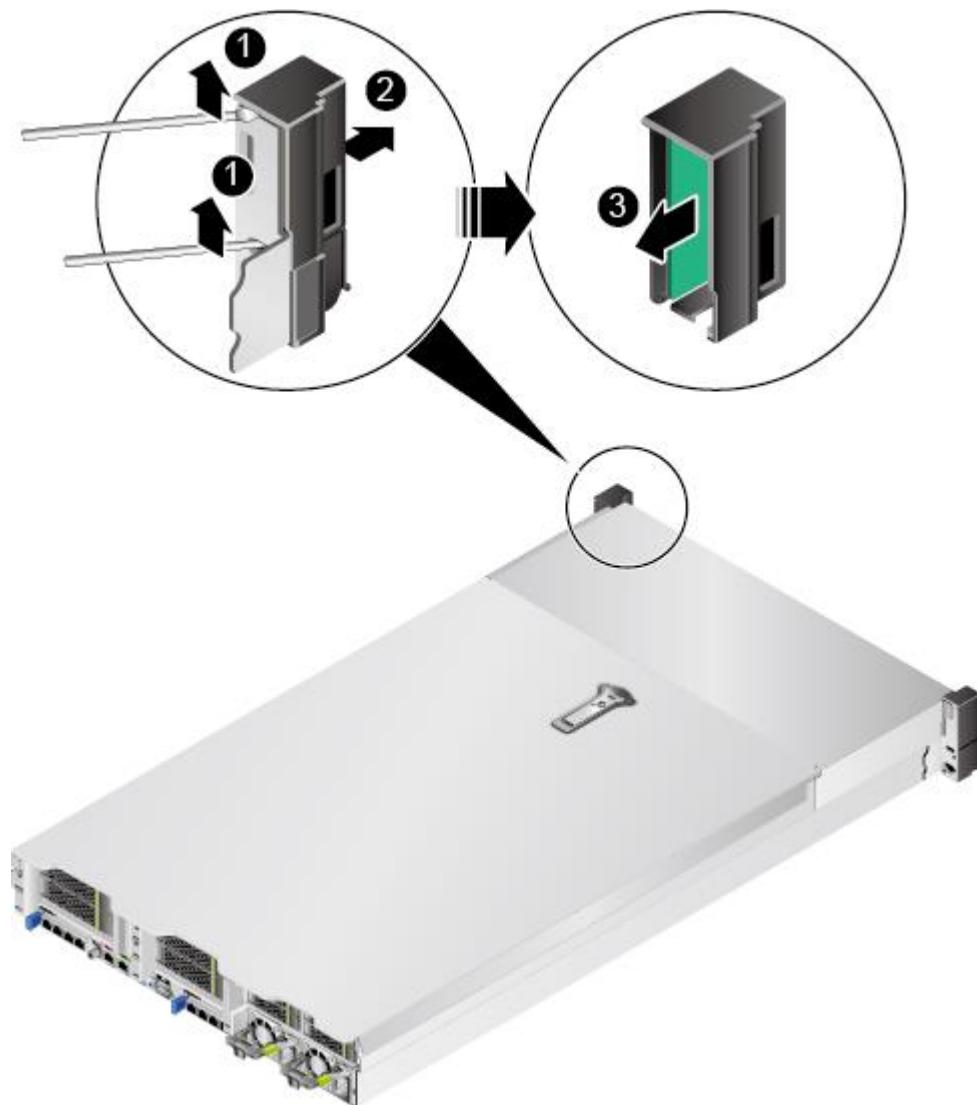
图5-174 36x3.5 英寸硬盘机箱拆卸右挂耳板
