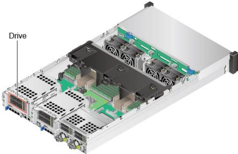
图5-145 36x3.5 英寸硬盘机箱硬盘位置
