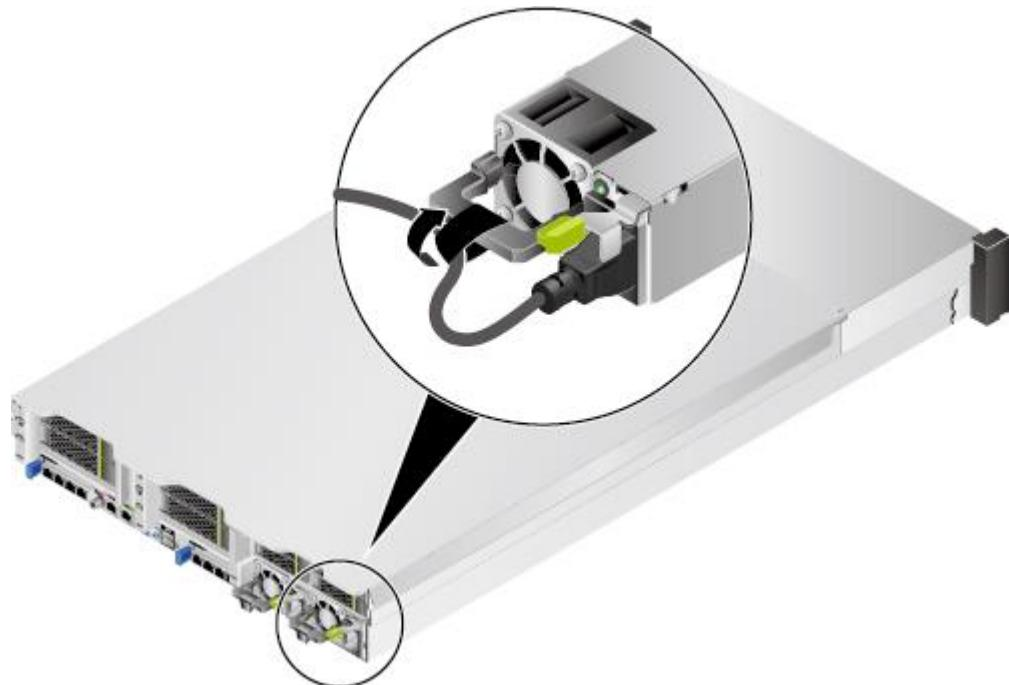
图5-30 36x3.5 英寸硬盘机箱撕开魔术贴
