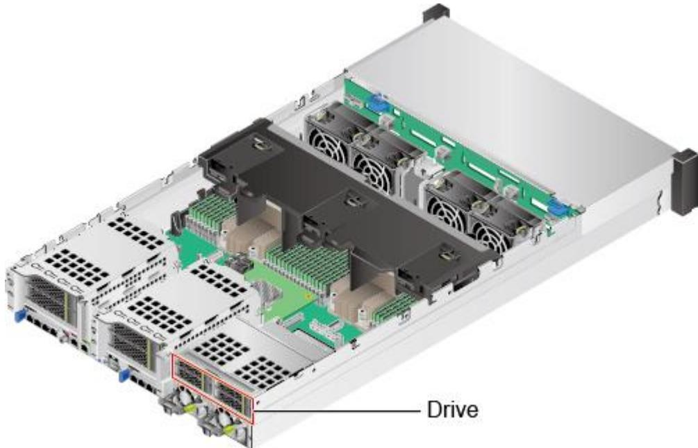
图5-159 36x3.5 英寸硬盘机箱硬盘位置
