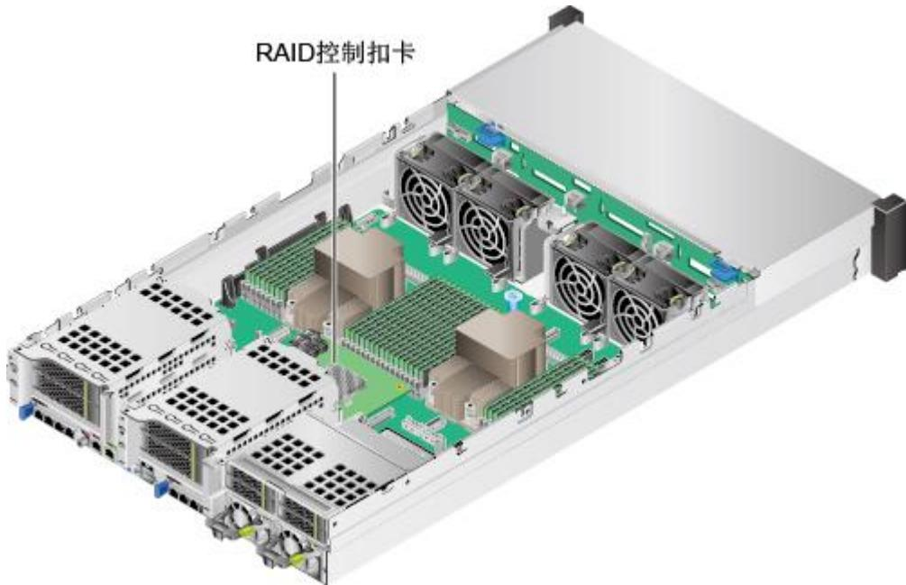
图5-112 36x3.5 英寸硬盘机箱 RAID 控制扣卡的位置
