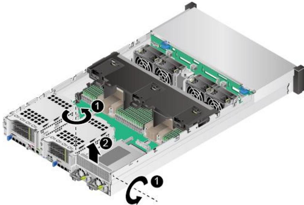
图5-90 36x3.5 英寸硬盘机箱拆卸空闲挡板 (3)
