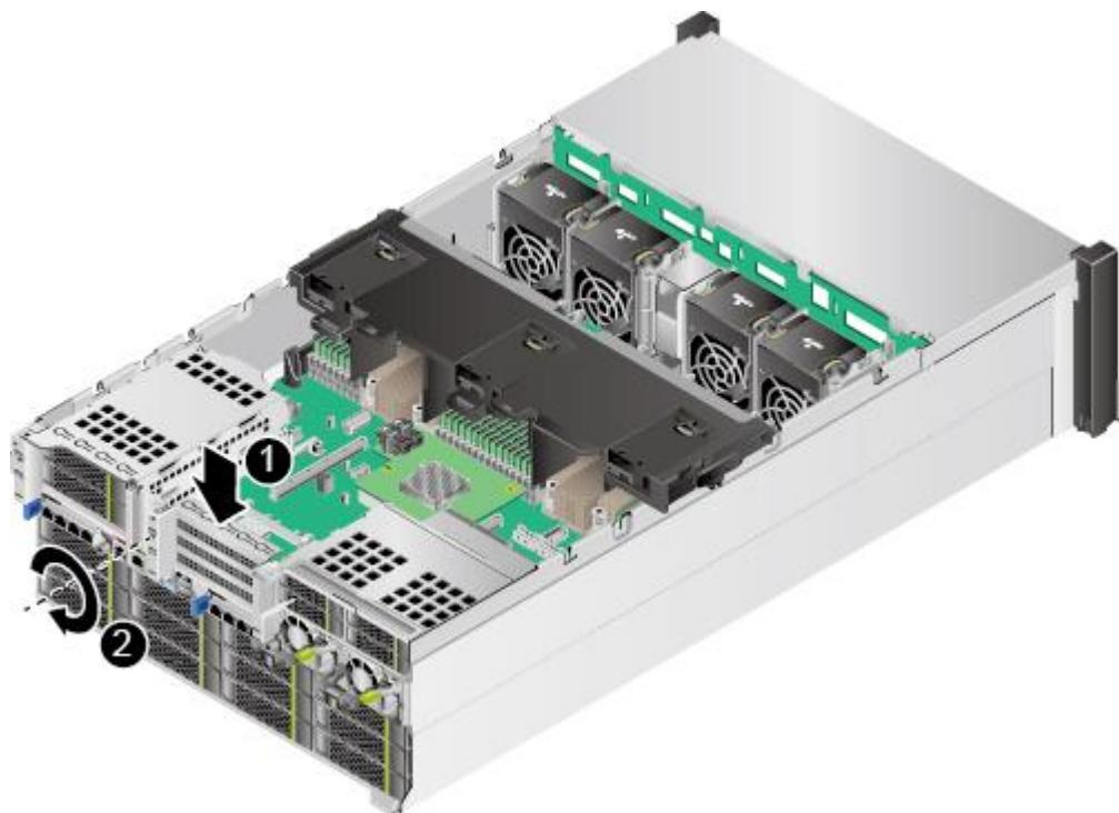
图5-83 25x2.5 英寸或 12x3.5 英寸硬盘机箱安装空闲挡板 (3)
