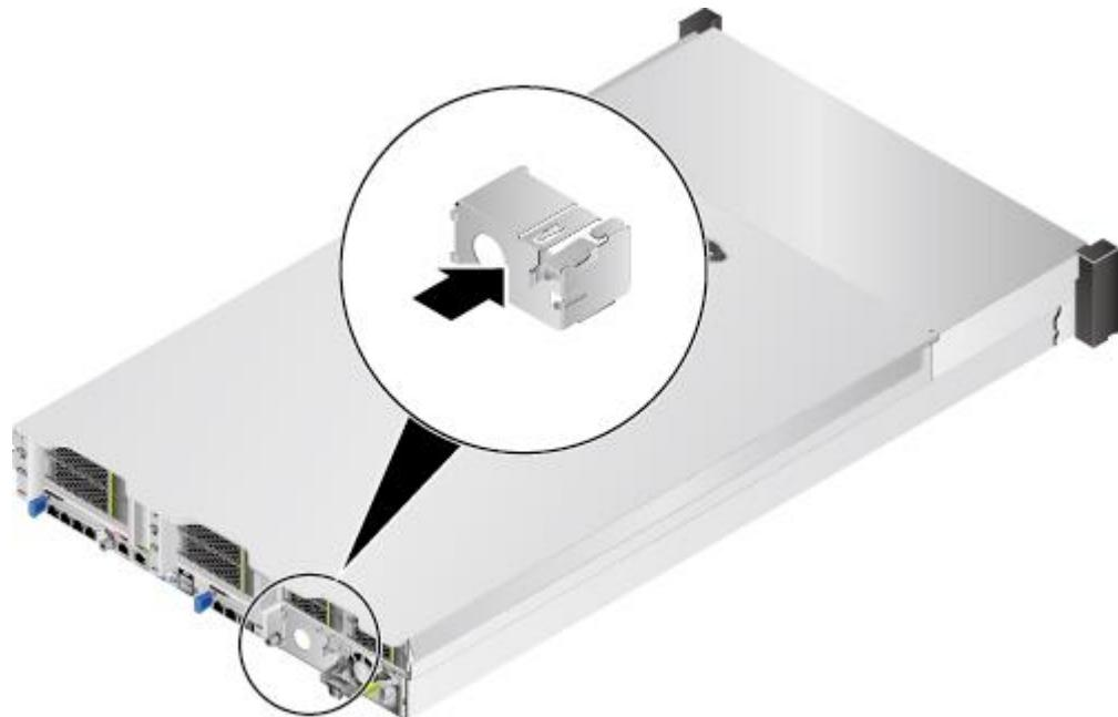
图5-36 36x3.5 英寸硬盘机箱安装电源空闲挡板
