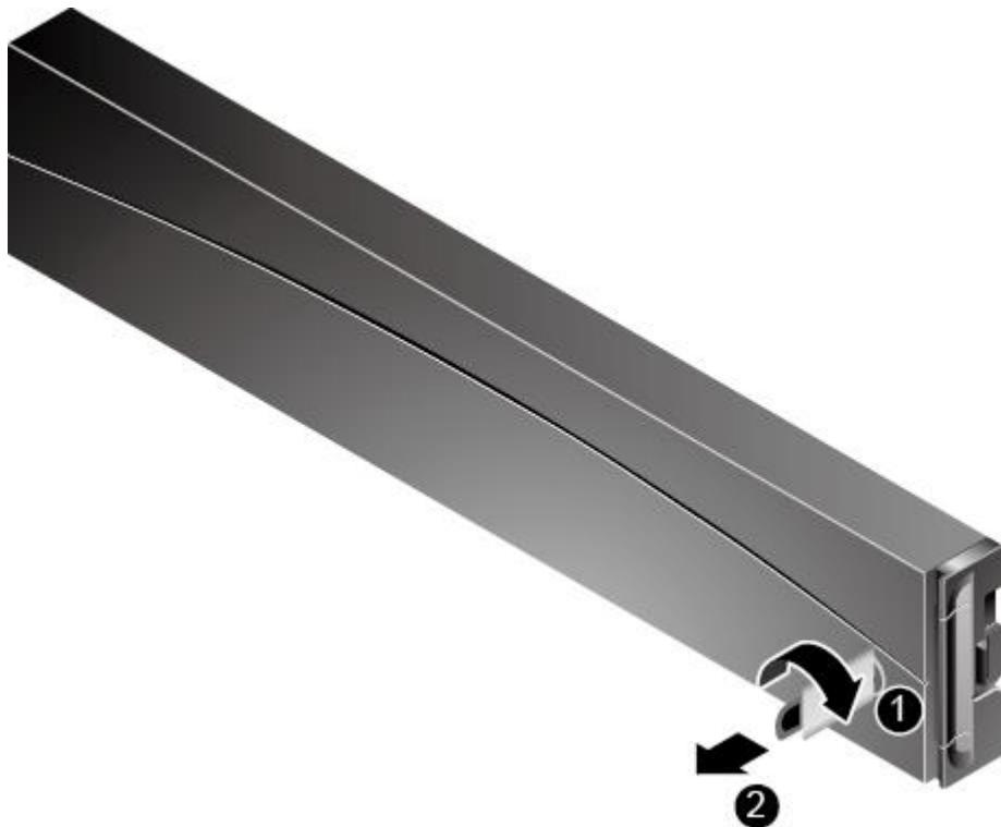
图5-20 36x3.5 英寸硬盘机箱解锁
