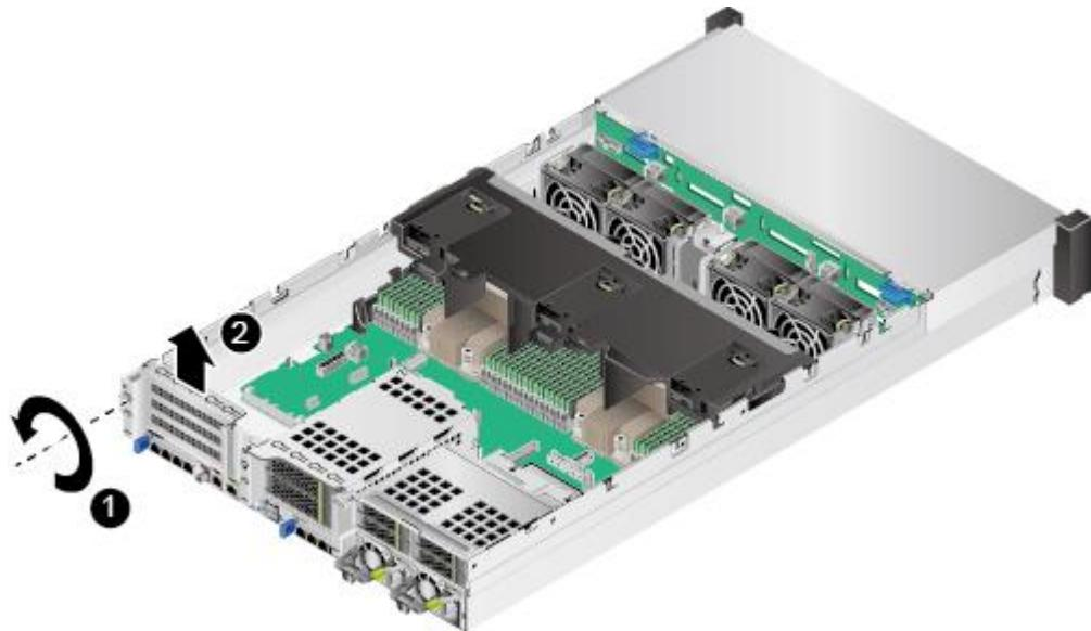
图5-86 36x3.5 英寸硬盘机箱拆卸空闲挡板 (1)
