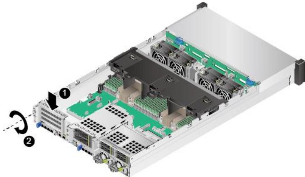
图5-80 36x3.5 英寸硬盘机箱安装空闲挡板 (1)
