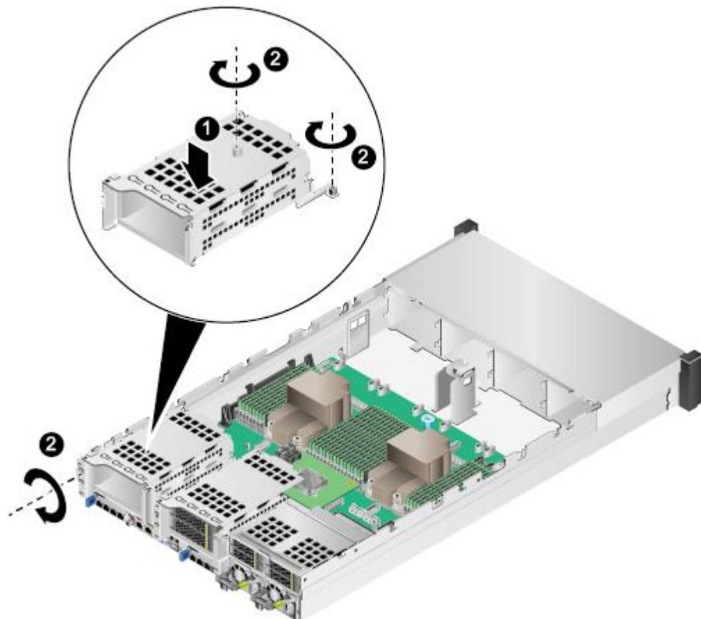
图5-149 36x3.5 英寸硬盘机箱安装后置硬盘组件
