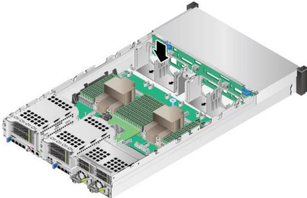
图5-143 36x3.5 英寸硬盘机箱安装风扇支架
