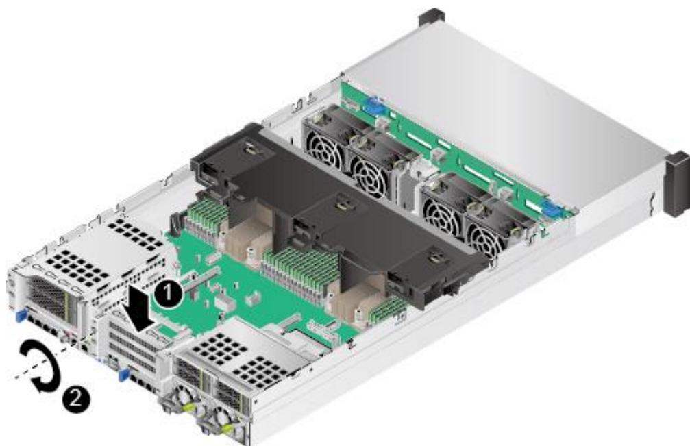
图5-82 36x3.5 英寸硬盘机箱安装空闲挡板 (2)
