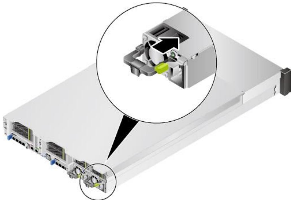
图5-40 36x3.5 英寸硬盘机箱安装电源模块
