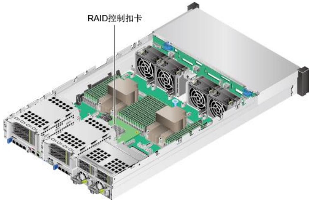
图5-115 36x3.5 英寸硬盘机箱 RAID 控制扣卡的位置
