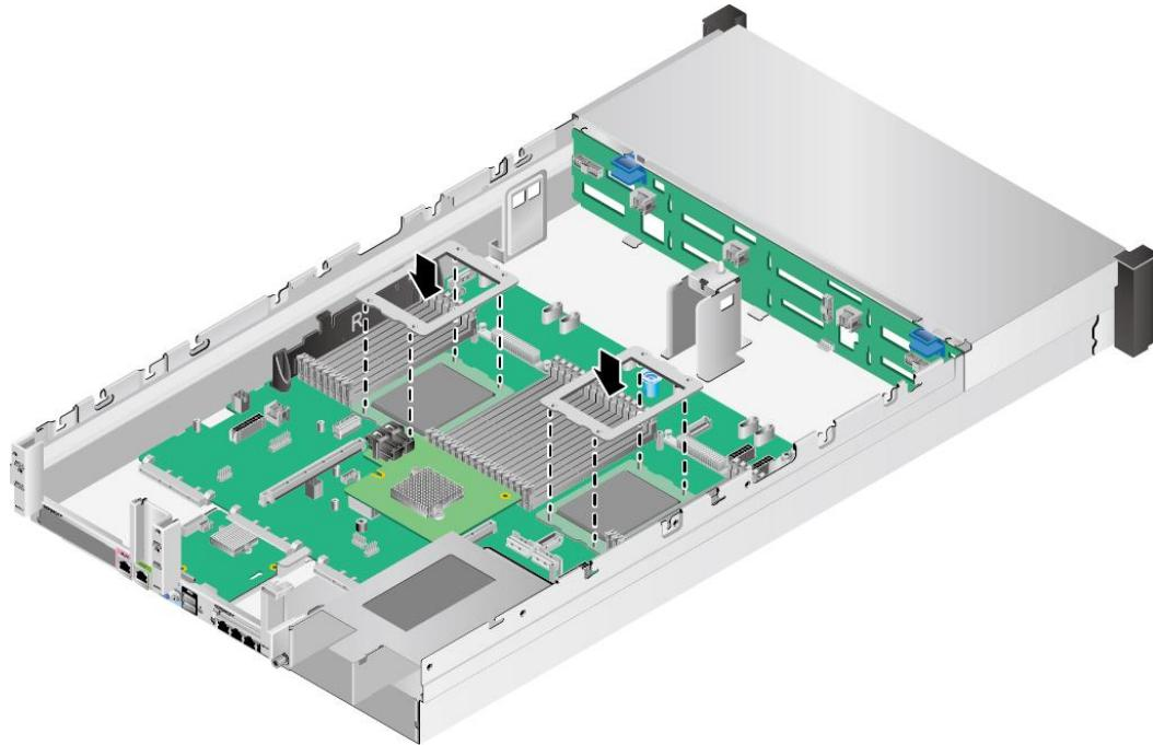
图5-198 36x3.5 英寸硬盘机箱安装 CPU 托架
