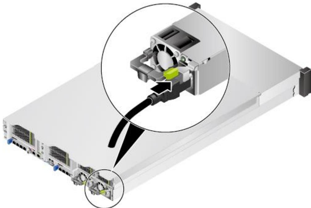
图5-27 36x3.5 英寸硬盘机箱连接电源线缆
