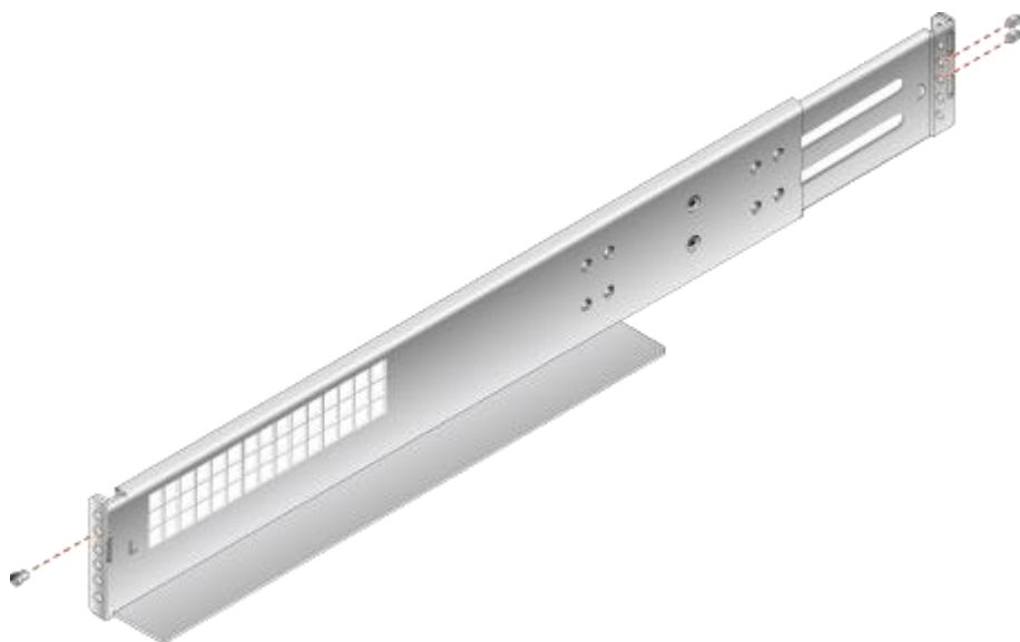
2. 如图 5-12 中①所示，将滑道水平放入规划的位置，根据机柜的长度将滑道向两侧导槽拉伸，使滑道的固定孔与机柜内侧导槽的安装孔对齐，滑道上前后限位销钉穿出方孔，预定位滑道。
