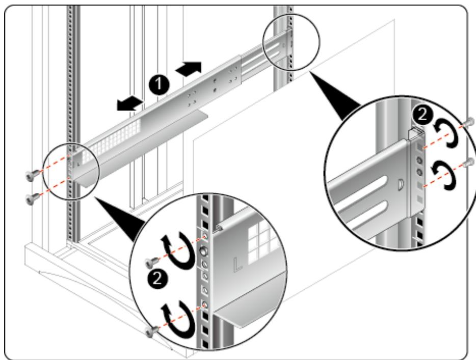
3. 如图 5-12 中②所示，用螺丝刀拧紧滑道的前后 4 颗紧固螺钉。
