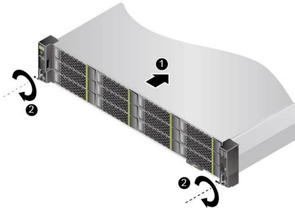
图5-9 36x3.5 英寸硬盘机箱安装服务器
