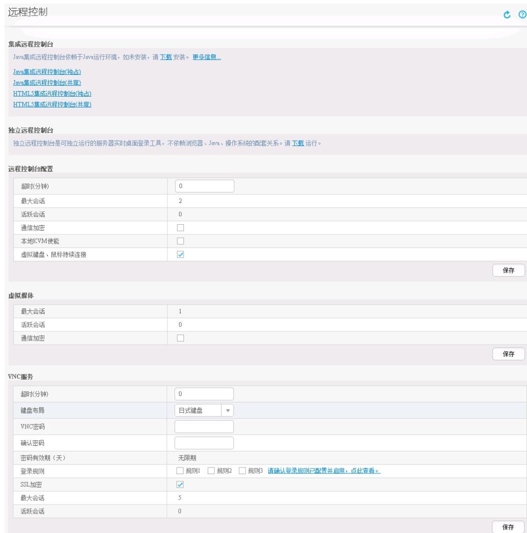
步骤3 单击“Java 集成远程虚拟控制台(独占)”、“Java 集成远程虚拟控制台(共享)”、“HTML5 集成远程控制台(独占)”或“HTML5 集成远程控制台(共享)”，进入服务器的实时操作控制台，如 0 或 0 所示。
