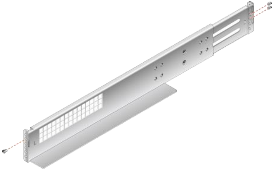
图5-9 安装限位销钉
