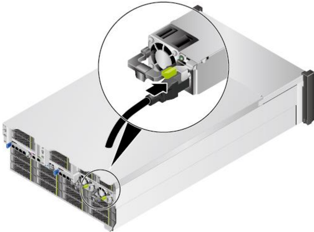
图5-19 连接电源线缆
