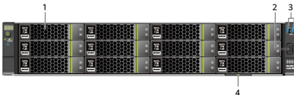
图2-1 12x3.5 英寸硬盘配置前面板组件
