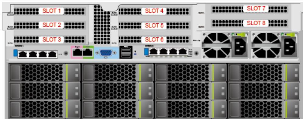
IO 模组 1 提供的槽位为 Slot 1 ~ Slot 3；IO 模组 2 提供的槽位为 Slot 4 ~ Slot 6；IO 模组 3 提供的槽位为 Slot 7 ~ Slot 8。
