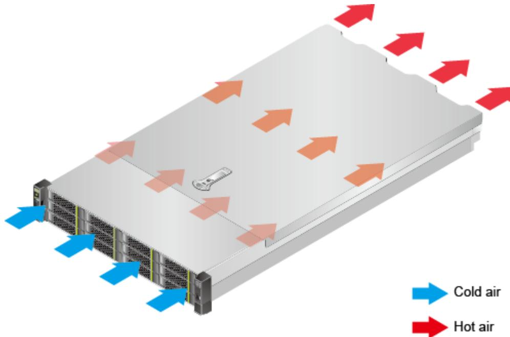
图5-4 36x3.5 英寸硬盘机箱散热气流走向示意图
