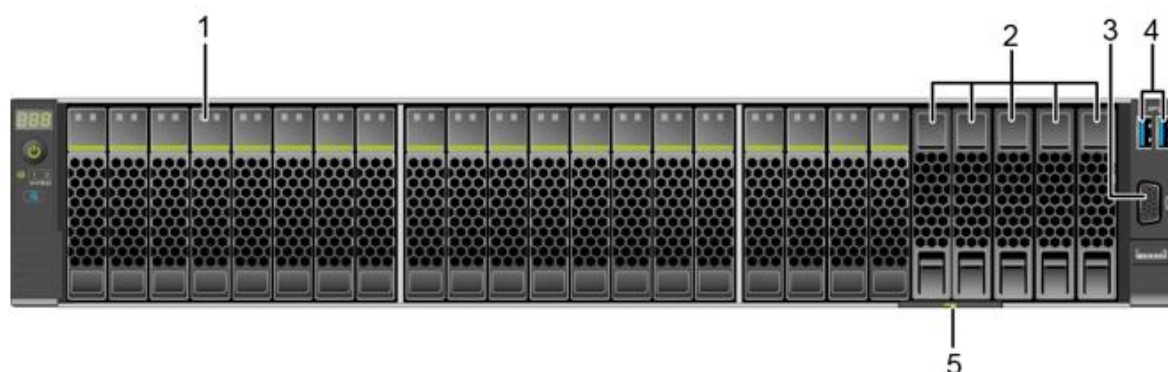
图4-3 8x2.5 SAS/SATA+12x2.5 NVMe 硬盘配置前面板组件
