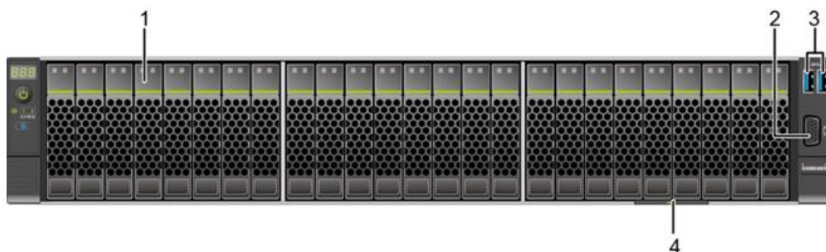
图4-2 25x2.5 英寸硬盘配置前面板组件
