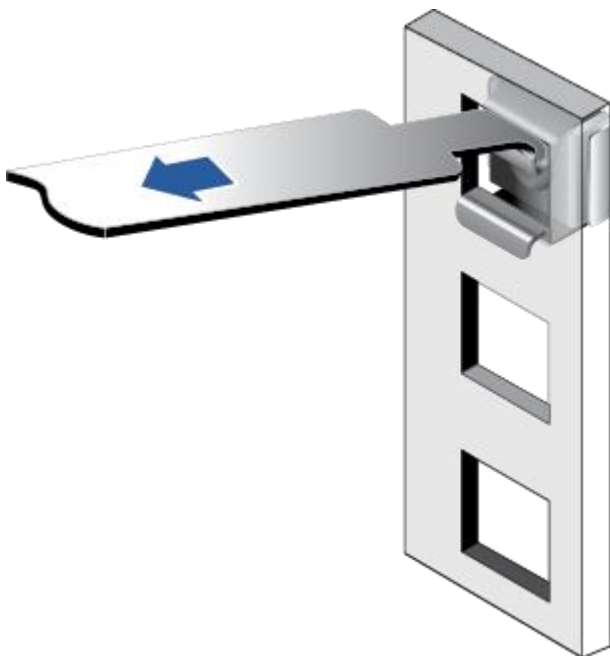
图 5-6 在机柜中安装浮动螺母
