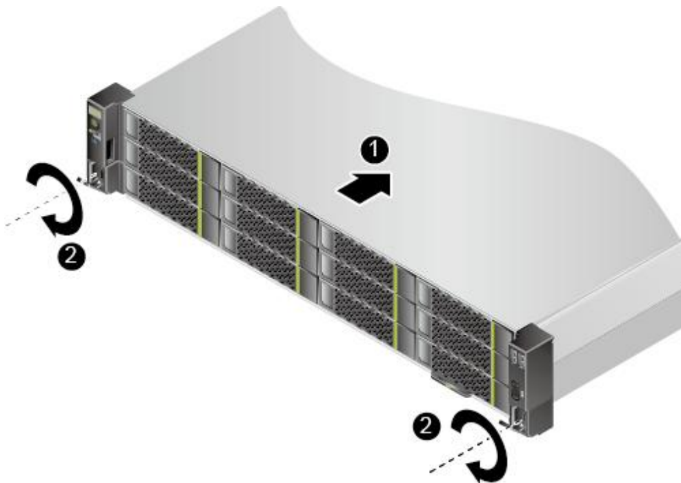
图 5-10 安装服务器
