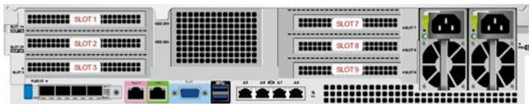
图 4-12 PCIe 插槽
