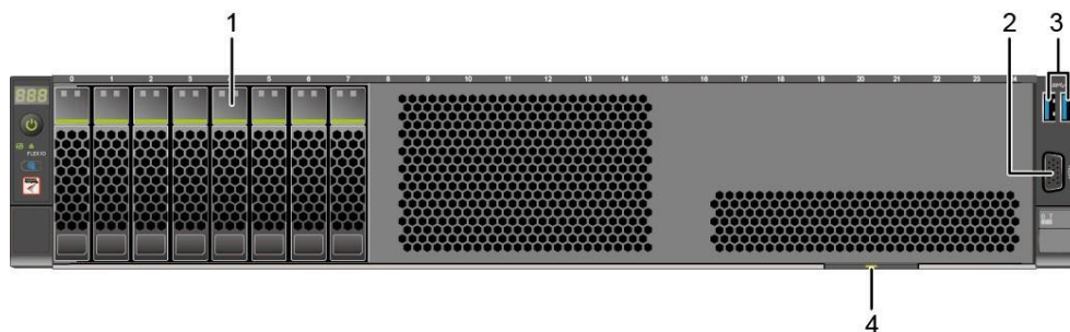
图 4-1 8x2.5 英寸硬盘配置前面板组件
