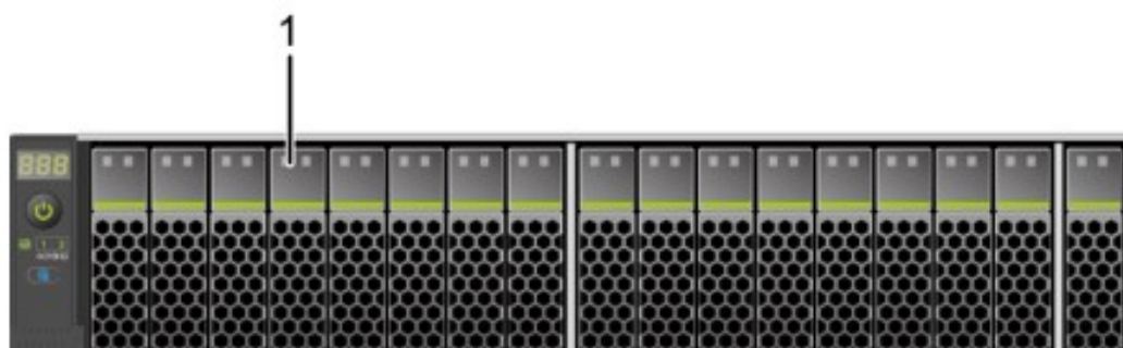
图4-3 8x2.5 SAS/SATA+12x2.5 NVMe 硬盘配置前面板组件
