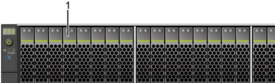
图4-4 24x2.5 SAS/SATA 直通硬盘配置前面板组件
