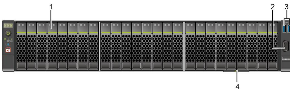
图 4-2 25x2.5 英寸硬盘配置前面板组件
