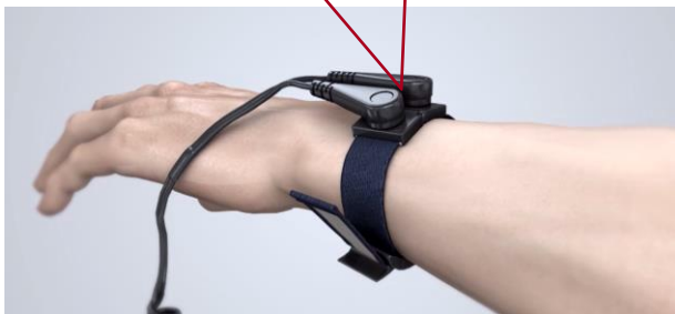
拆卸硬盘佩戴静电腕带
