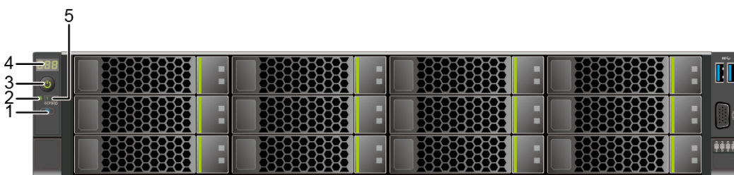
图4-4 12x3.5 英寸硬盘配置前面板指示灯和按钮
