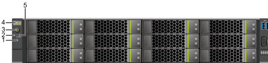
图2-3 12x3.5 英寸硬盘配置前面板指示灯和按钮
