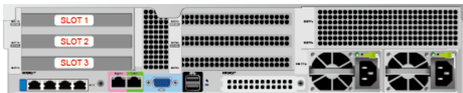
图2-12 PCIe 插槽
