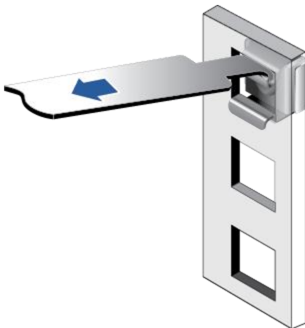
图 6-6 在机柜中安装浮动螺母
