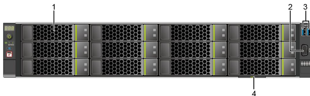
图 3-1 12x3.5 英寸硬盘配置前面板组件
