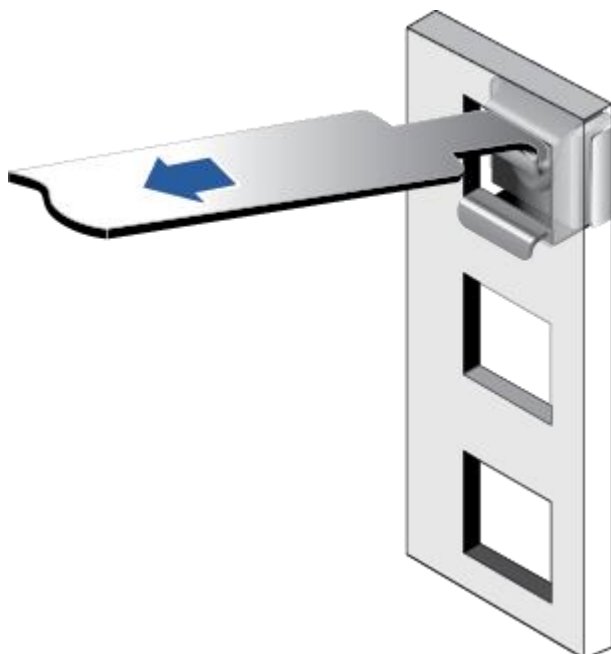
图 6-4 在机柜中安装浮动螺母
