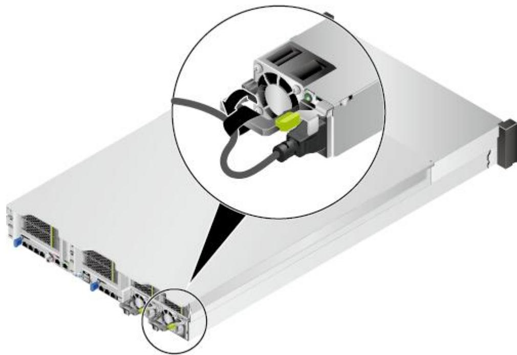
步骤 4 将电源线的另一端插入机柜的交流插线排。
