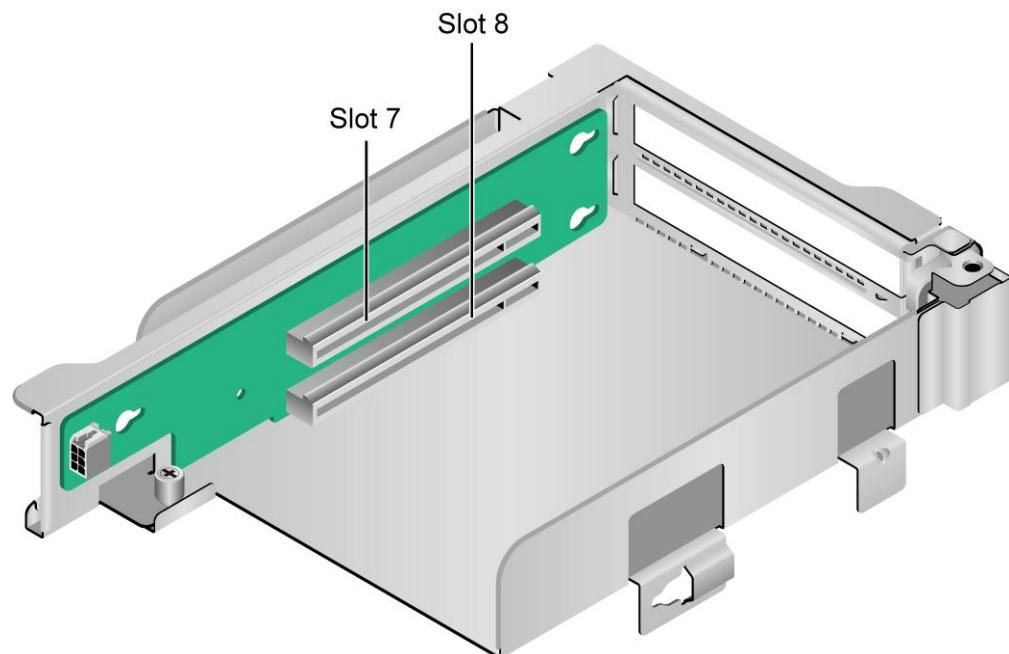
服务器的 PCIe 插槽分布后视图如图 5-33 所示。
