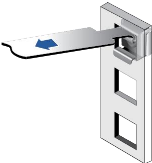
图 5-7 在机柜中安装浮动螺母
