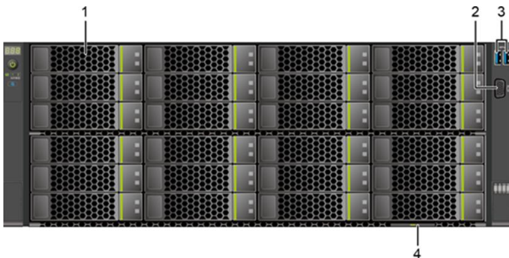
图 2-3 36x3.5 英寸硬盘配置前面板组件
