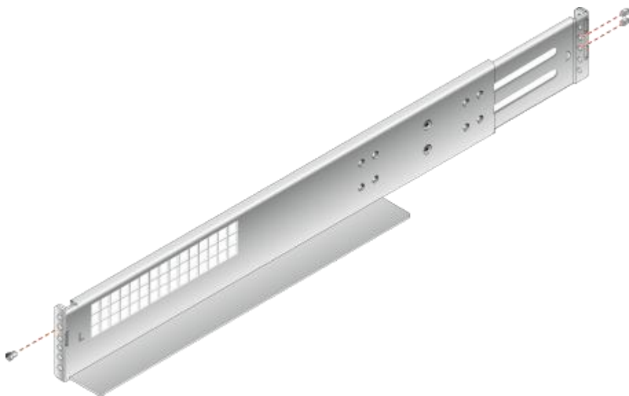
图 5-9 安装限位销钉
