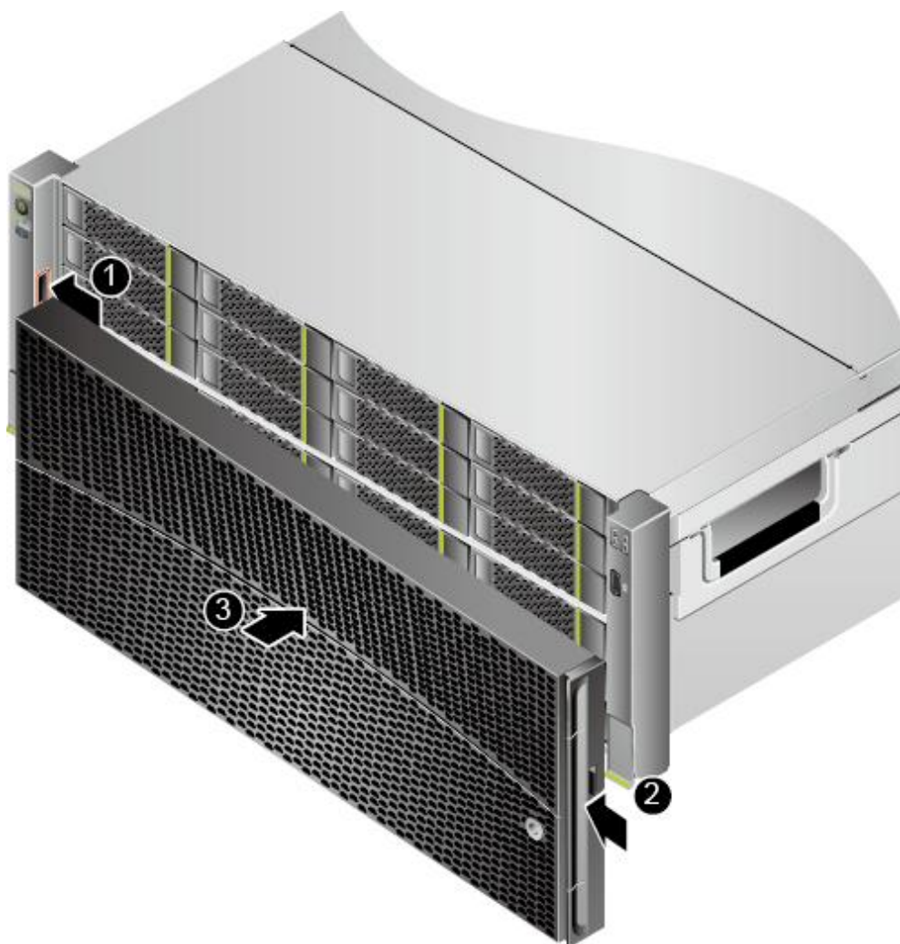
图 5-18 安装安全面板
