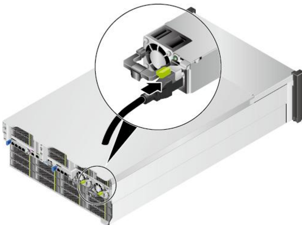
图 5-20 连接电源线缆
