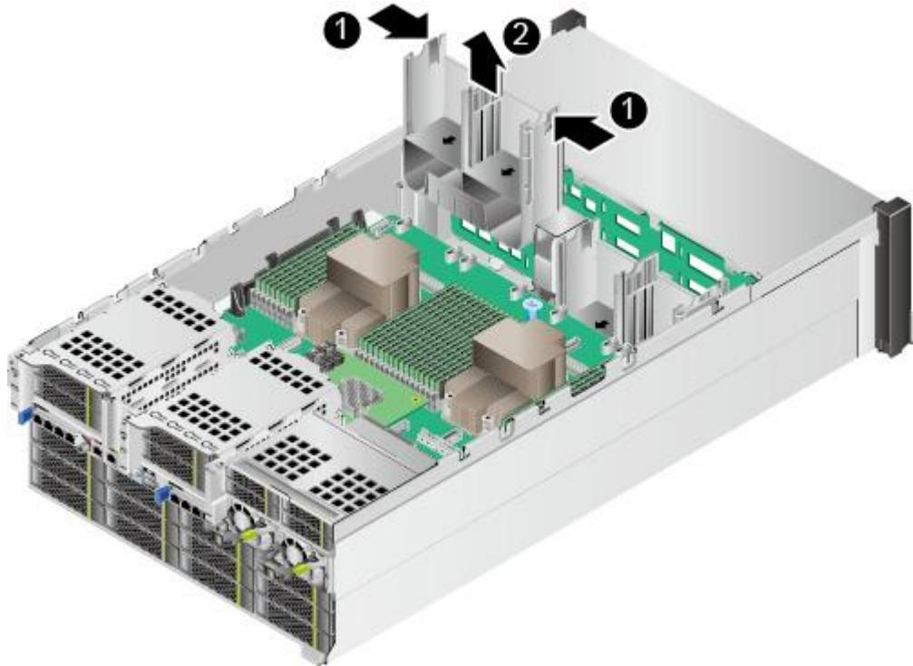
步骤 9 拆除后置硬盘背板连接到主板、前置硬盘背板、RAID 控制卡和 NVMe 转接适配卡的线缆，详细信息请参见 3 内部布线。
