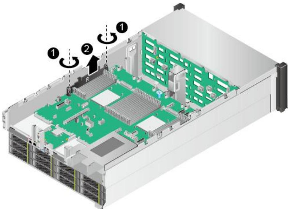
步骤 21 使用十字螺丝刀拧开主板松不脱螺钉，如图 5-113 中①所示。
