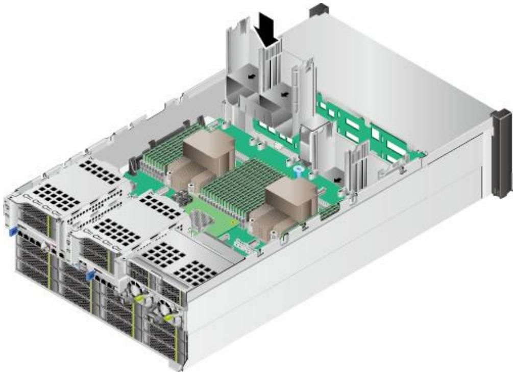
步骤 9 安装所有风扇模块。具体操作方法请参见 5.10 风扇模块。
