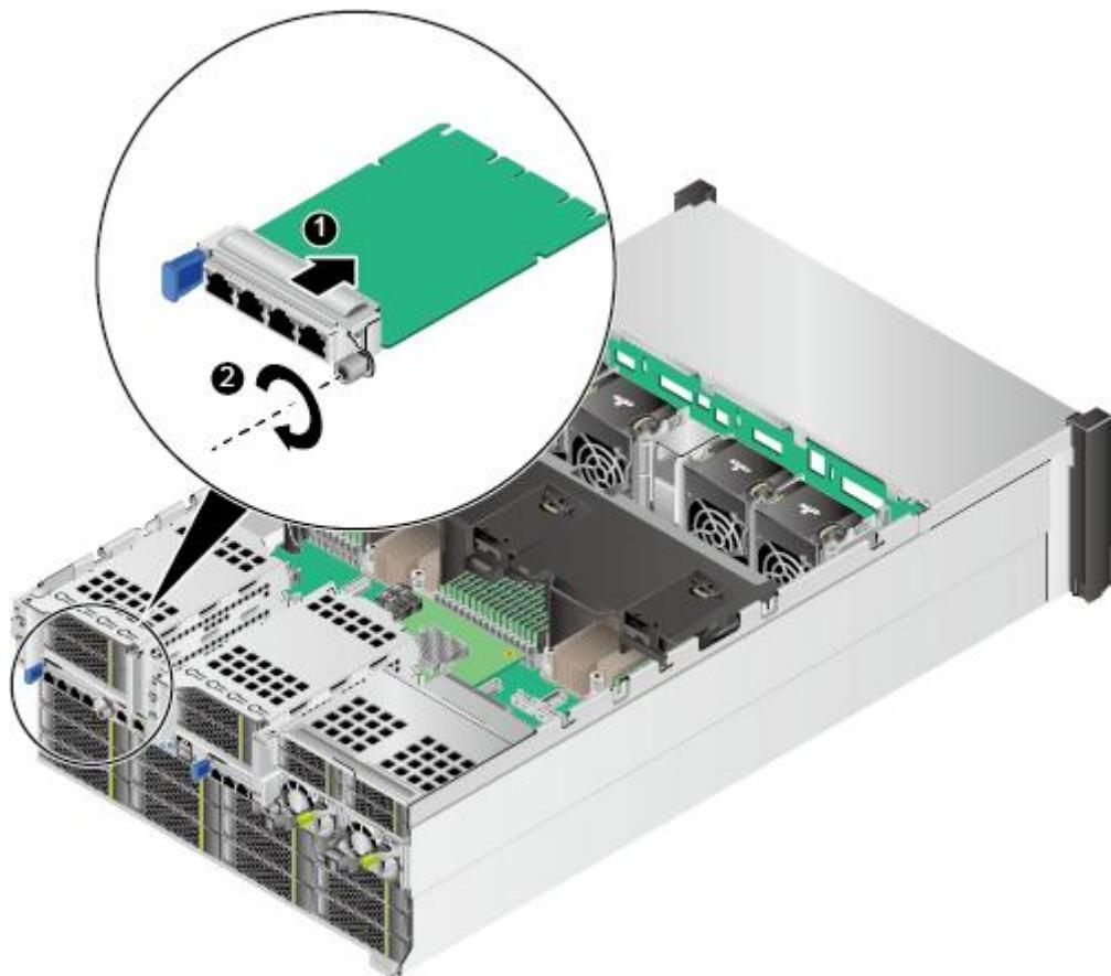
步骤 8 用十字螺丝刀拧紧灵活 I/O 卡的固定螺钉，如图 5-83 中②所示。
