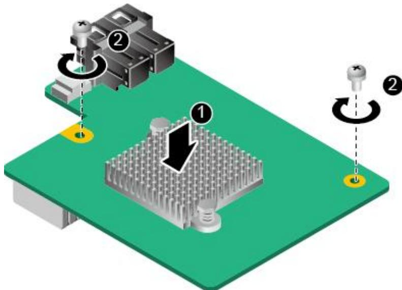
步骤 11 拧紧 RAID 控制扣卡固定螺钉，固定 RAID 控制扣卡，如图 5-70 中②所示。
