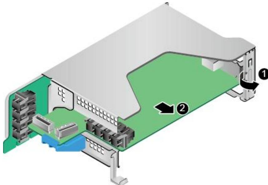
步骤 9 拔出 IOB 卡，如图 5-61 中②所示。
