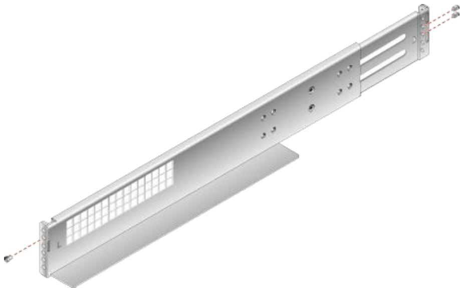
2. 如图 5-9 中①所示，将滑道水平放入规划的位置，根据机柜的长度将滑道向两侧导槽拉伸，使滑道的固定孔与机柜内侧导槽的安装孔对齐，滑道上前后限位销钉穿出方孔，预定位滑道。
