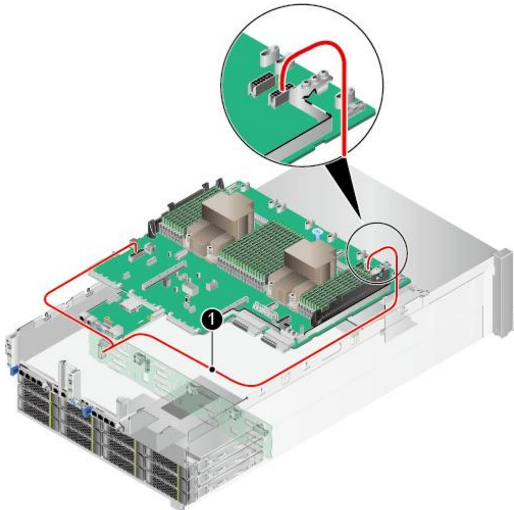
表 3-6 后置 12 盘硬盘背板的电源线
