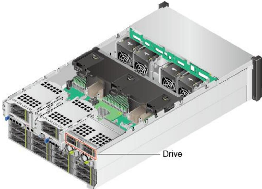
步骤 8 拧开固定后置硬盘组件的螺钉，如图 5-93 中①所示。
