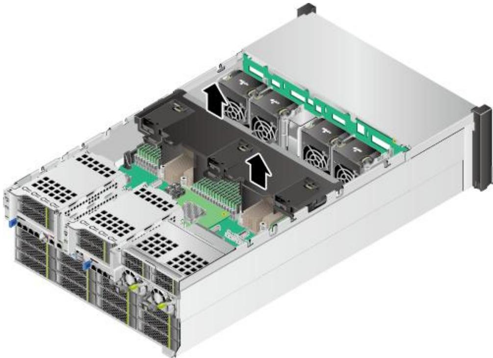
步骤 9 将拆下的导风罩放入防静电包装袋内。
