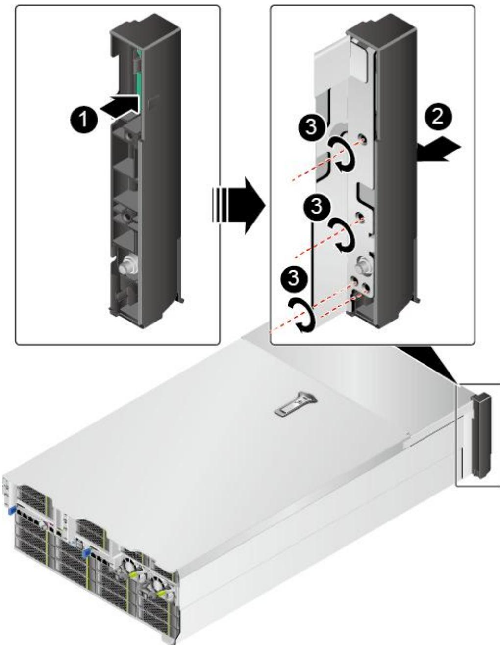
步骤 7 连接左挂耳板上的信号线缆。
