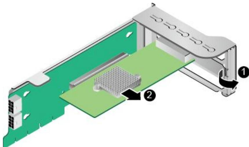
步骤 8 拔出 PCIe 卡，如图 5-57 中②所示。
