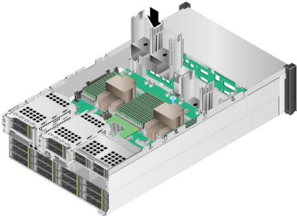
步骤 15 安装所有风扇模块。具体操作方法请参见 5.10 风扇模块。
