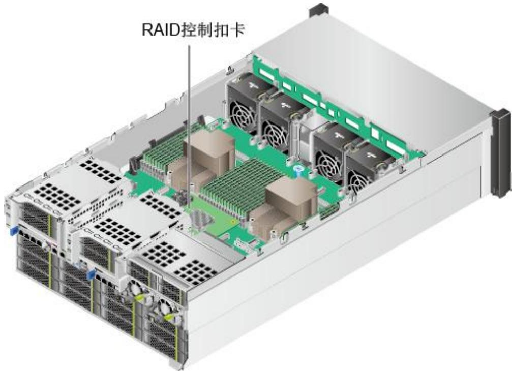
步骤 10 对准 RAID 控制扣卡和主板相对应的接口，向下缓慢用力插入 RAID 控制扣卡，如图 5-70 中①所示。
