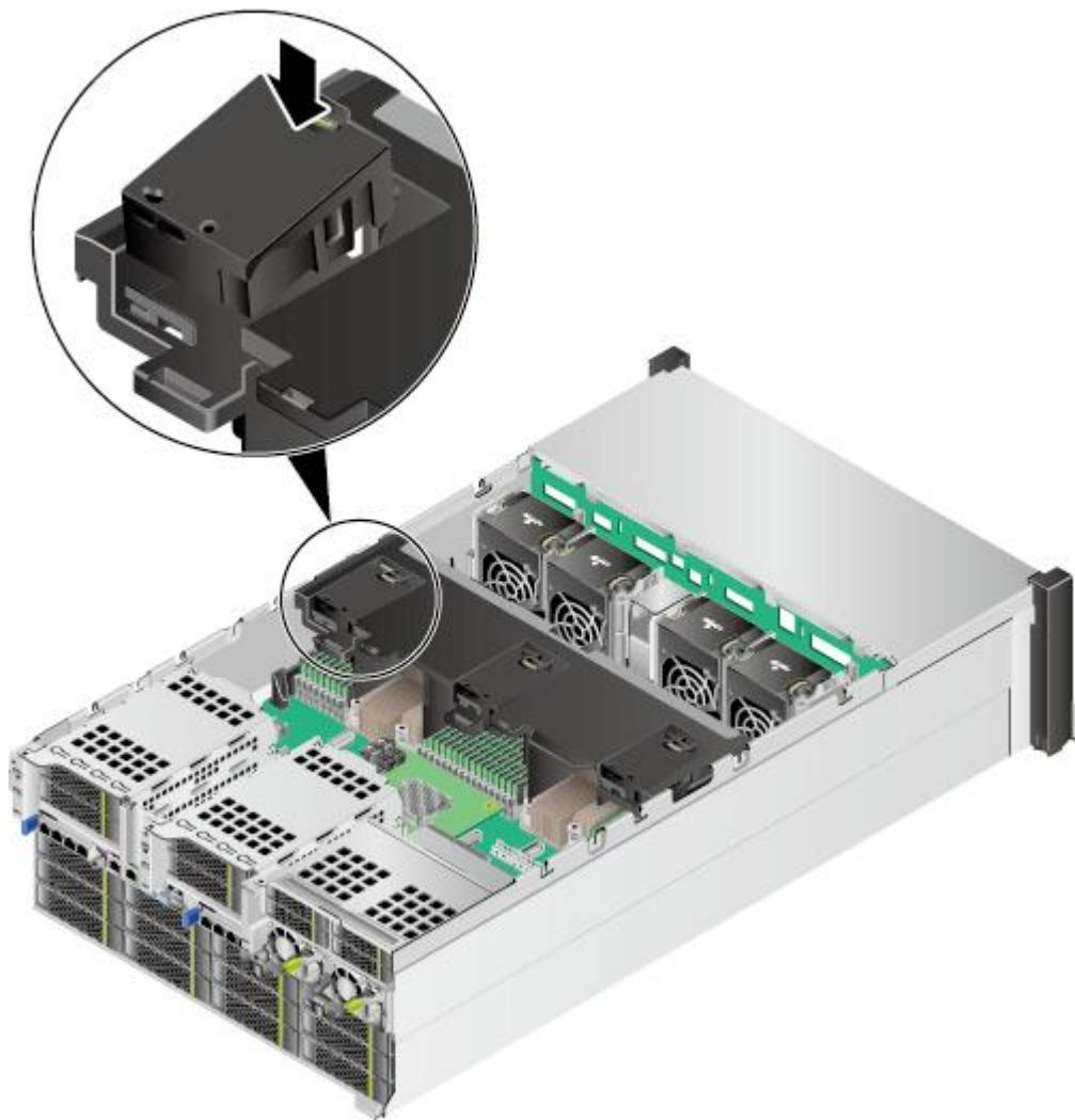
步骤 9 将超级电容线缆插入 RAID 卡超级电容线缆接口，如图 5-76 所示。
