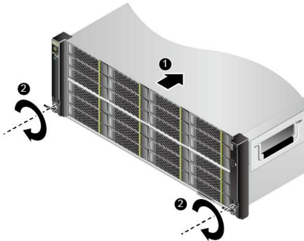
3. 如图 5-10 中②所示，将服务器两侧挂耳紧贴方孔条，按顺时针方向拧紧挂耳上的松不脱螺钉，固定服务器。
