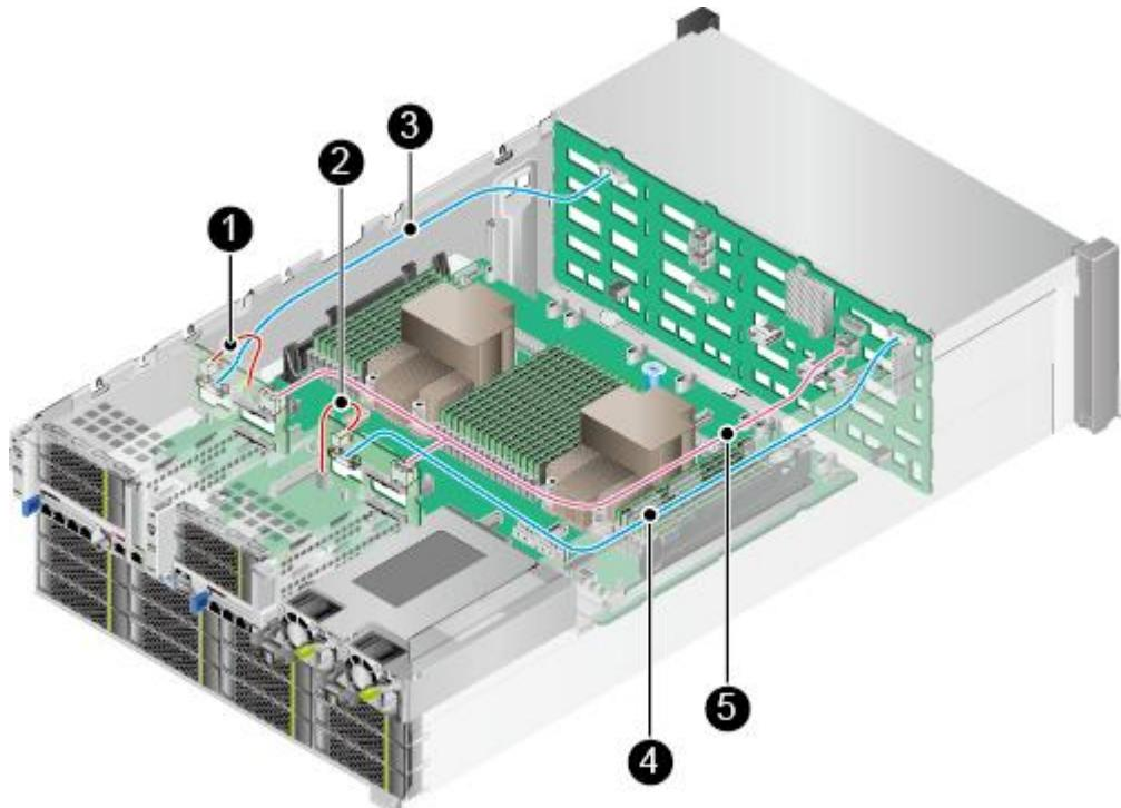
表 3-7 I/O 模组 1 和 I/O 模组 2 硬盘背板连线
