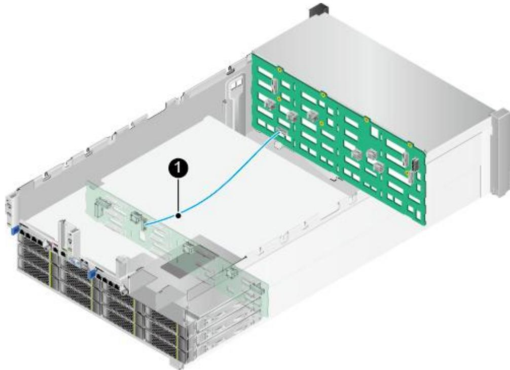
表 3-14 后置 12 盘硬盘背板的低速信号线
