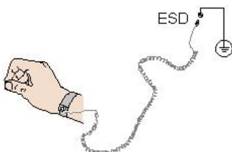
步骤 2 拉紧锁扣，确认防静电腕带与皮肤接触良好。
