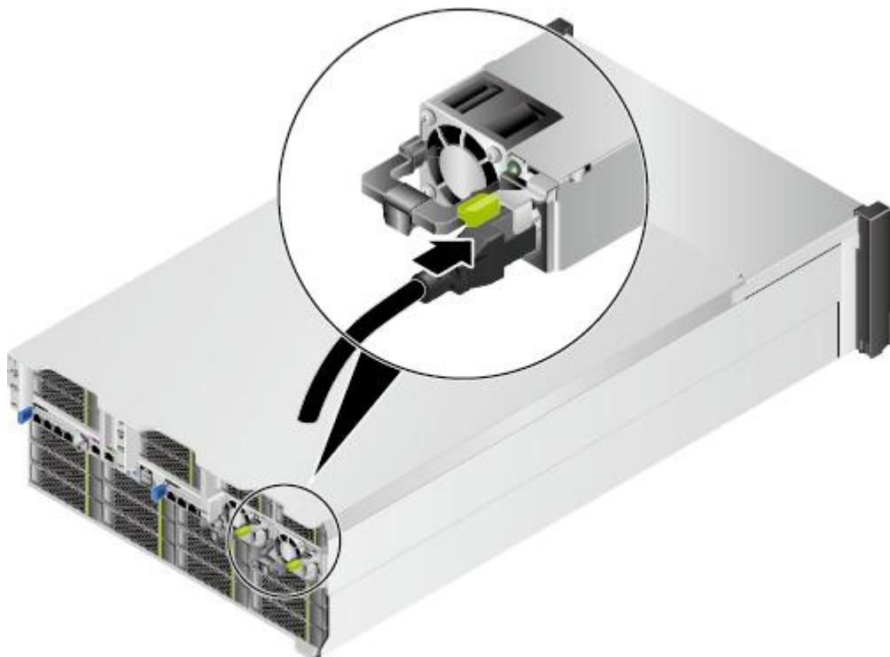
步骤 6 用魔术贴固定好电源线缆，如图 5-28 所示。
