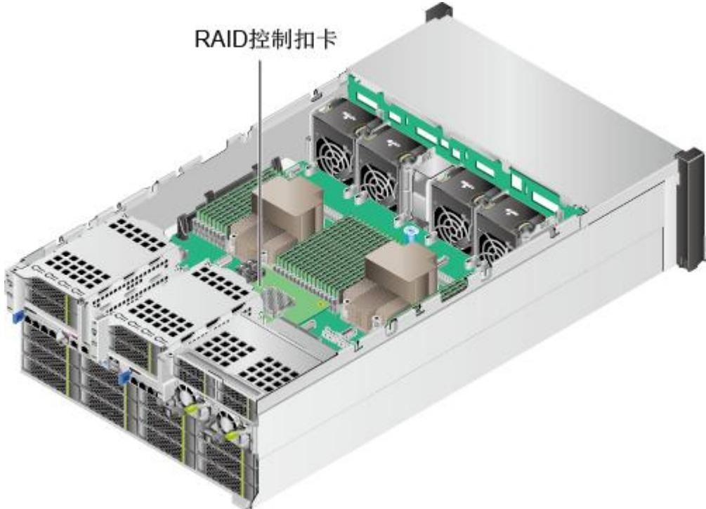
步骤 9 按住 RAID 控制扣卡线缆的卡扣并向外拔出线缆，详细信息请参见 3 内部布线。
