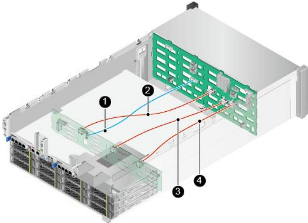
表 3-5 后置 12 盘硬盘背板的 SAS 信号线和低速信号线
