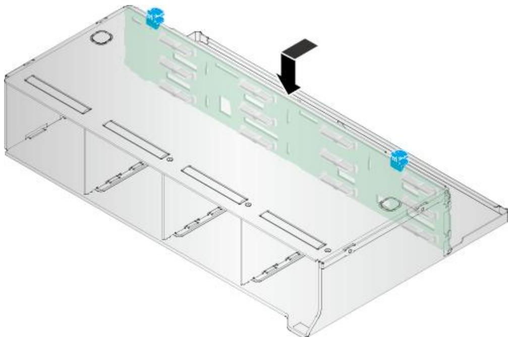
步骤 4 连接后置硬盘背板线缆。详细信息请参见 3 内部布线。
