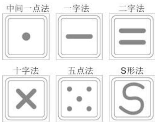
导热硅脂的厚度大约为一张普通纸的厚度。最终涂抹效果如图 5-119 所示，要保证导热硅脂涂抹均匀并且涂满。
