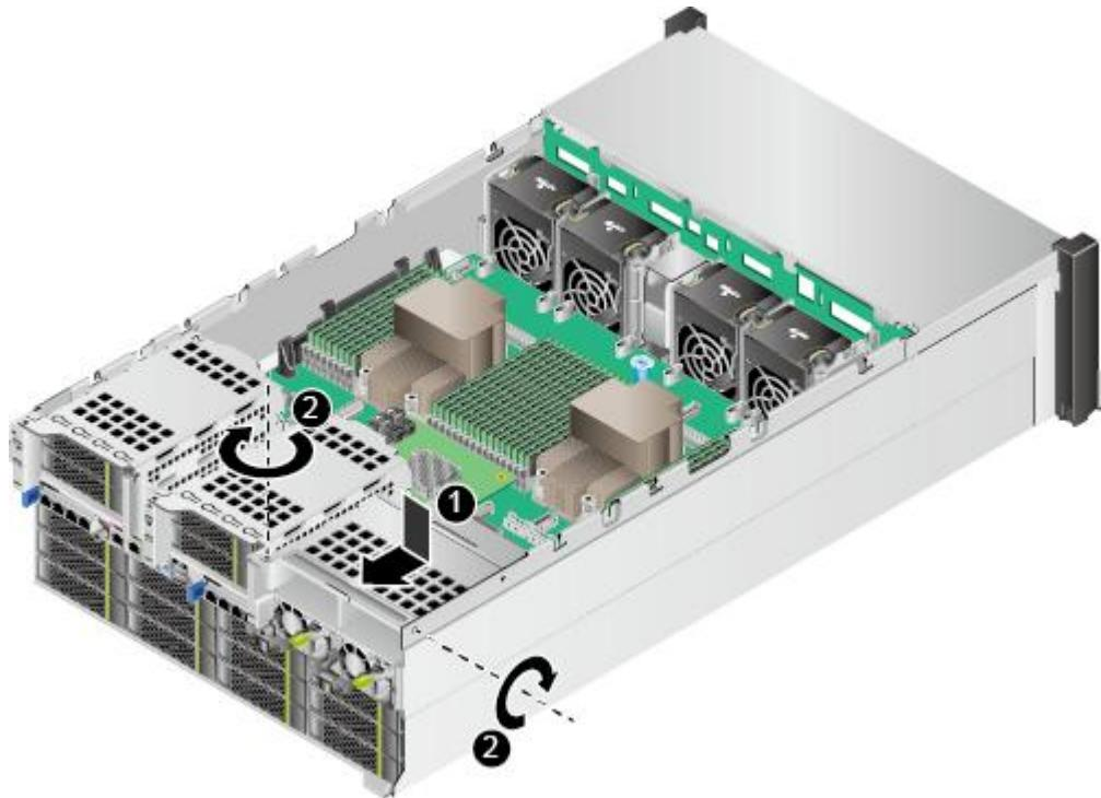
步骤 8 确认后置硬盘模组中硬盘的位置，如图 5-95 所示。安装后置硬盘模组中的所有硬盘。
