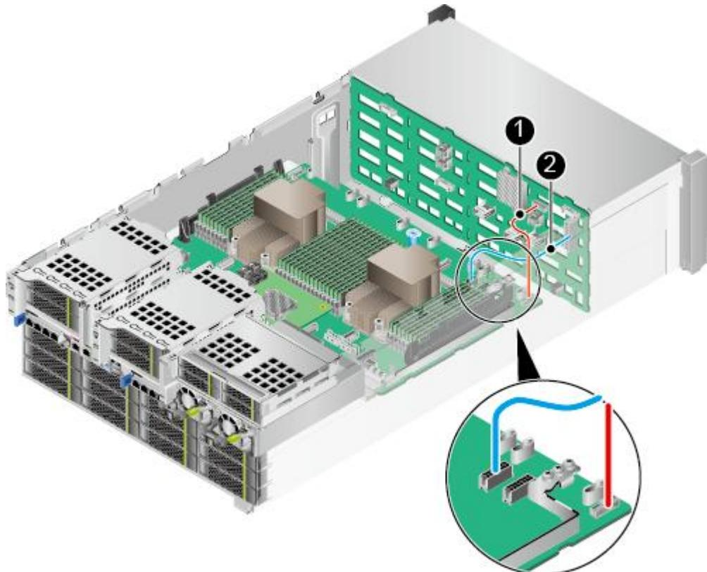
表 3-3 前置硬盘背板的电源线和低速信号线
