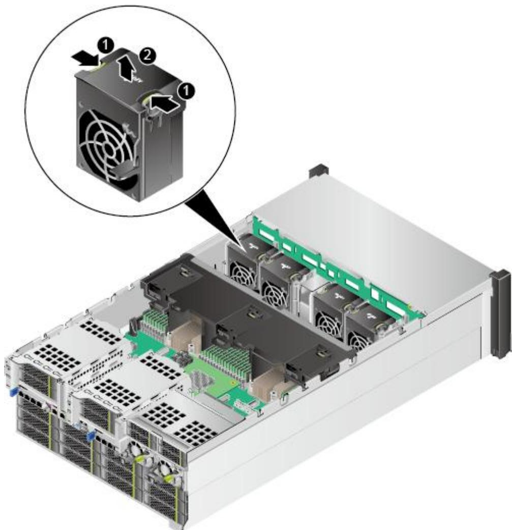
步骤 7 向上缓缓用力提起风扇模块，待风扇模块松动后，向上完全拆除风扇模块，如图 5-41 中②所示。
