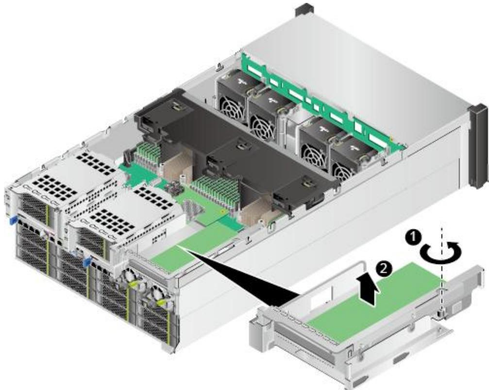
图 5-47 拆卸 Riser 模组 3 的下托架
