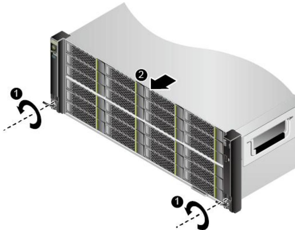
2. 如图 5-11 中②所示，沿滑轨向远离机柜的方向缓慢拉出服务器。
