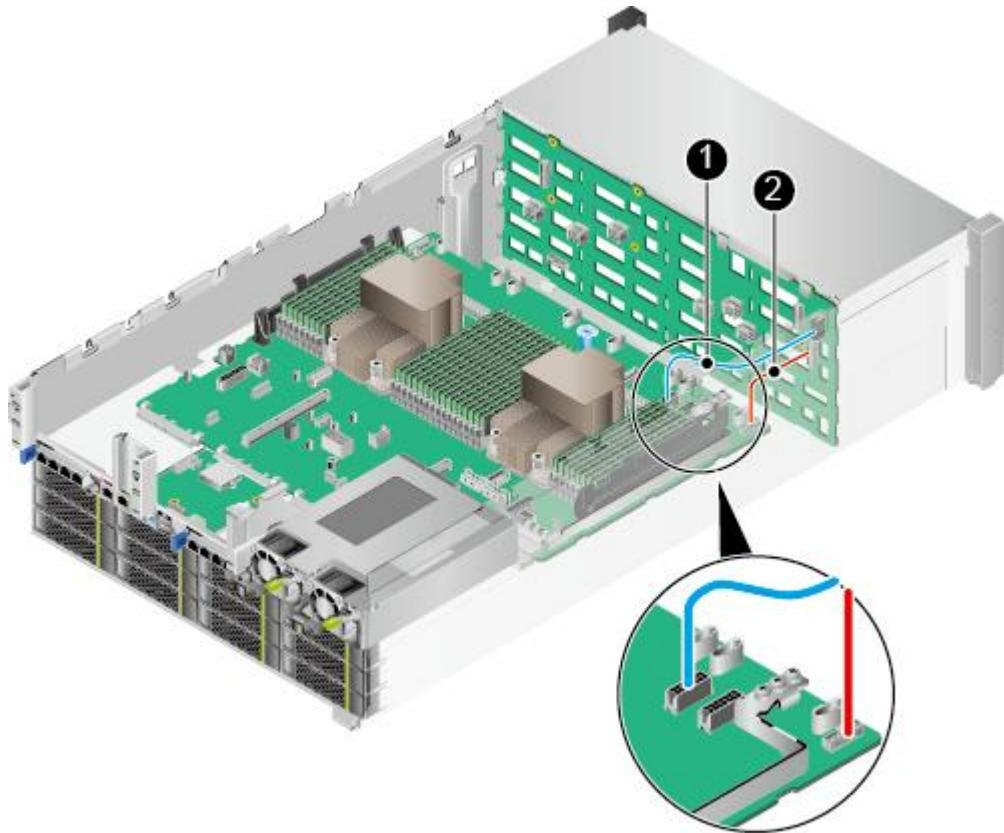
表 3-11 前置硬盘背板的电源线和低速信号线
