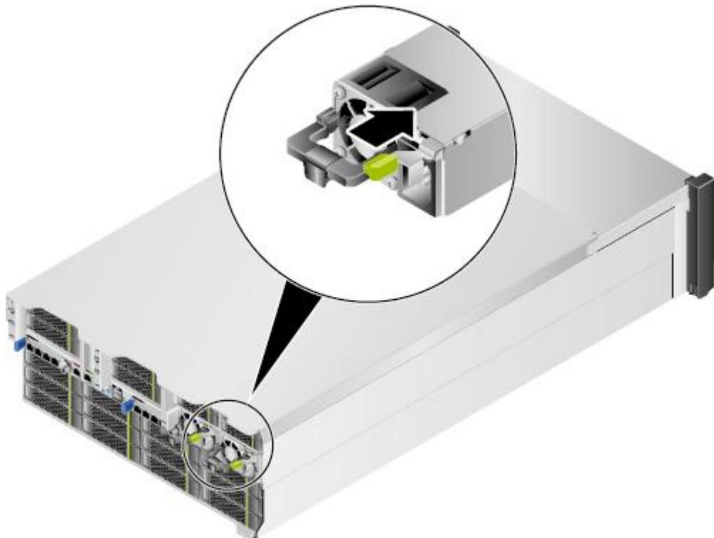
步骤 5 将电源线缆的一端插入服务器交流电源模块的线缆接口，如图 5-27 所示。
