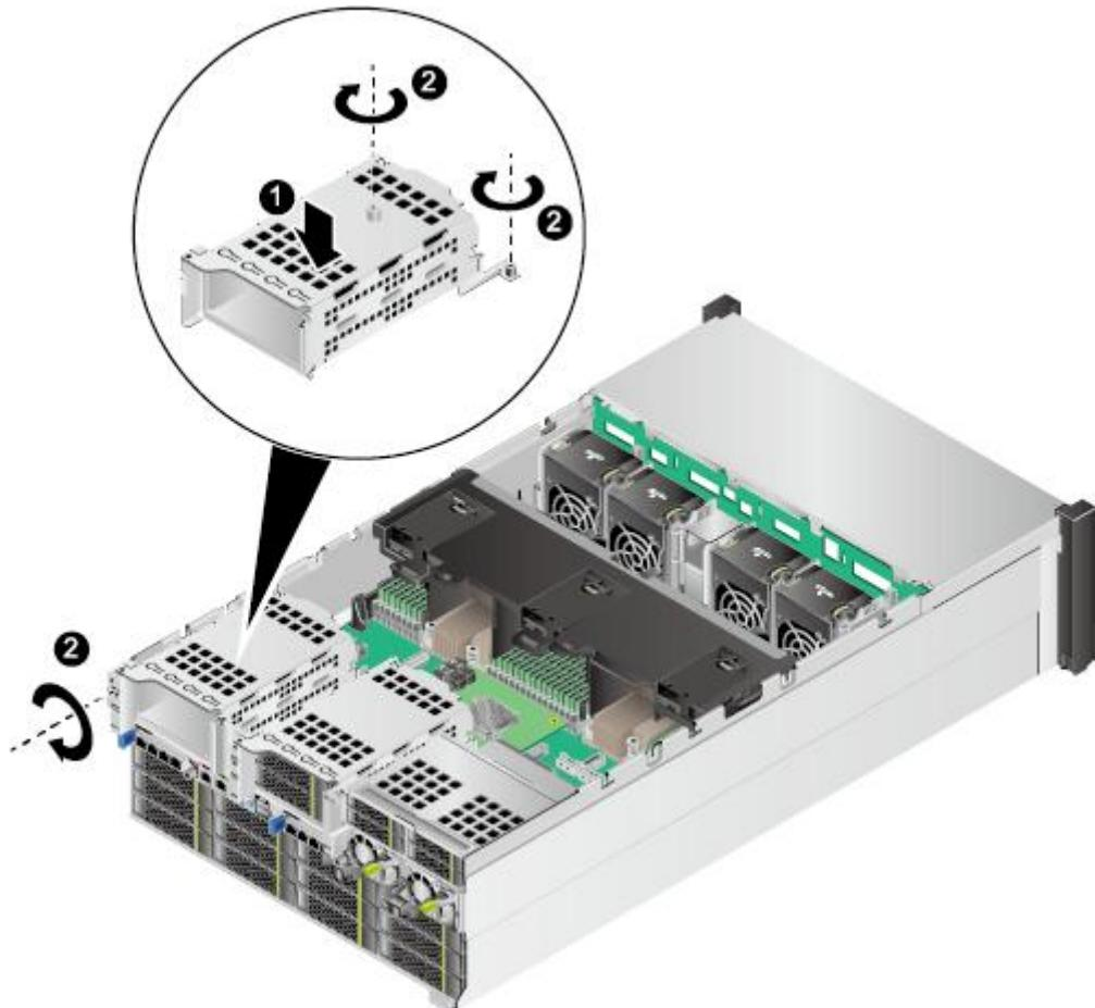
步骤 8 确认后置硬盘模组中硬盘的位置，如图 5-91 所示。安装后置硬盘模组中的所有硬盘。
