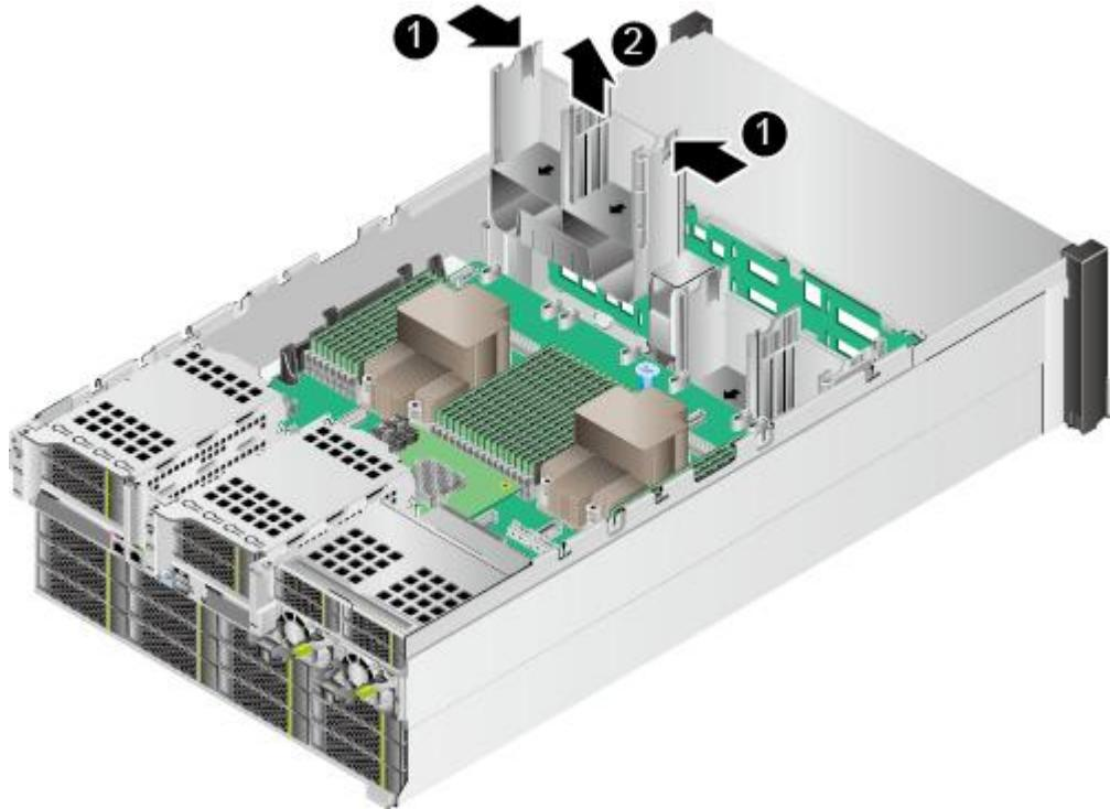
步骤 13 拨出连接到主板上的所有线缆。详细信息请参见 3 内部布线。
