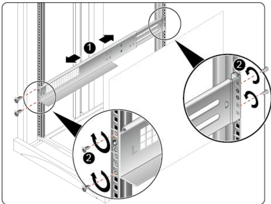
3. 如图 5-9 中②所示，用螺丝刀拧紧滑道的前后 4 颗紧固螺钉。
