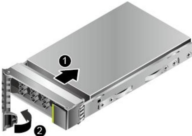
步骤 6 待硬盘扳手已经扣住机箱横梁，闭合硬盘扳手，利用扳手和机箱之间的切合力将硬盘完全推入机箱，如图 5-20 中②所示。
