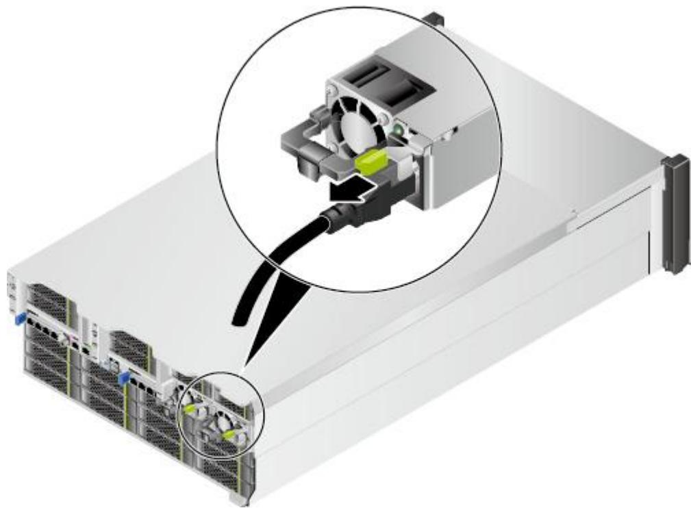
步骤 6 沿箭头方向按住电源模块弹片，同时用力拉住扳手，向外拔出电源模块，如图 5-23 所示。
