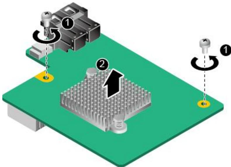
步骤 11 向上缓慢用力拔出 RAID 控制扣卡，如图 5-68 中②所示。
