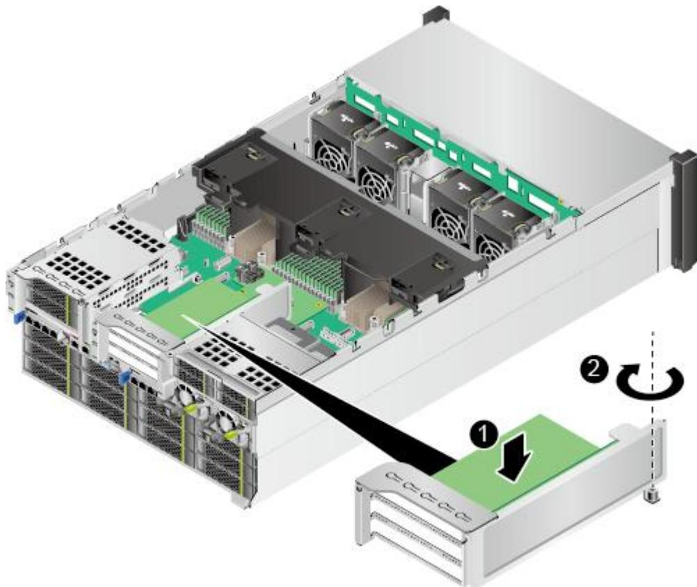
步骤 10 安装 Riser 模组 3 时，需要先安装 Riser 模组下托架，如图 5-55 所示，将下托架固定好之后，向下放入 Riser 模组上托架，并拧紧支架的固定螺钉，如图 5-56 所示。
