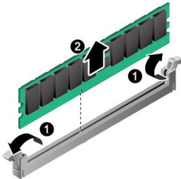
步骤 8 将 DIMM 从插槽中取出，如图 5-77 中②所示。
