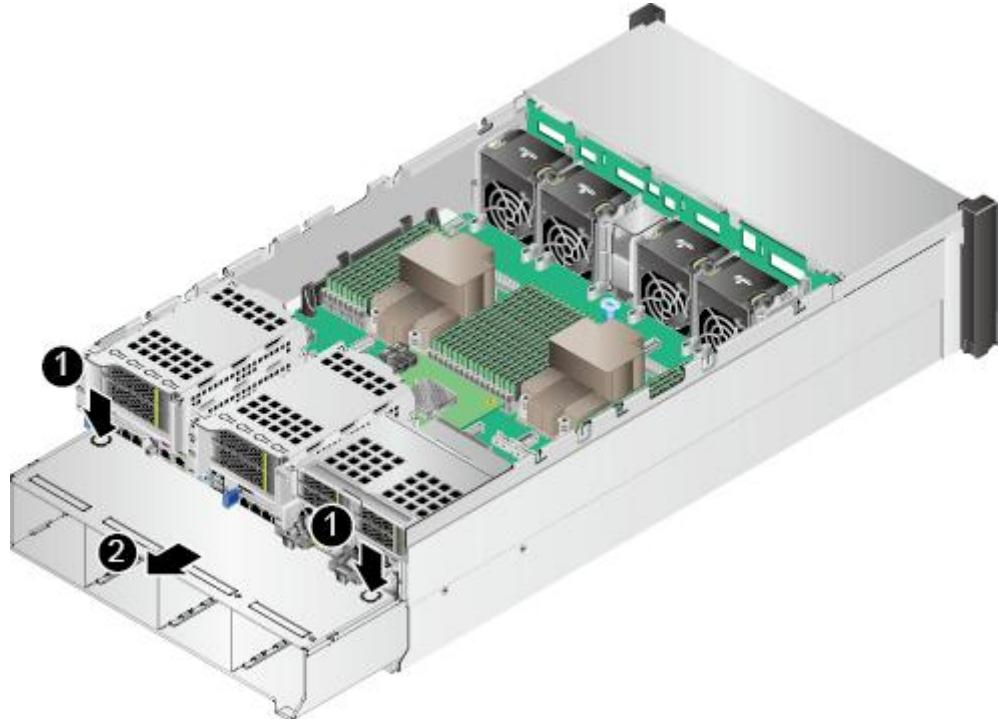
步骤 14 拆卸后置硬盘背板上的线缆。详细信息请参见 3 内部布线。
