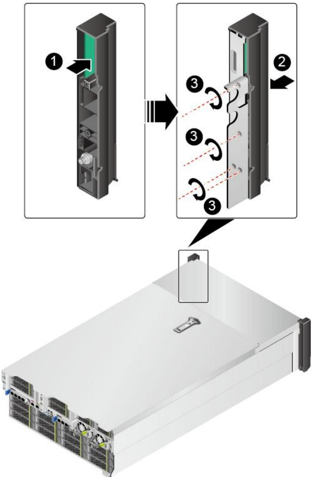
步骤 8 安装右挂耳，并使用螺丝刀拧紧右挂耳固定螺钉，如图 5-108 中②和③所示。
