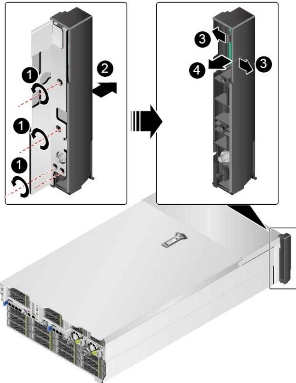
步骤 7 拔出左挂耳板上的信号线缆。
