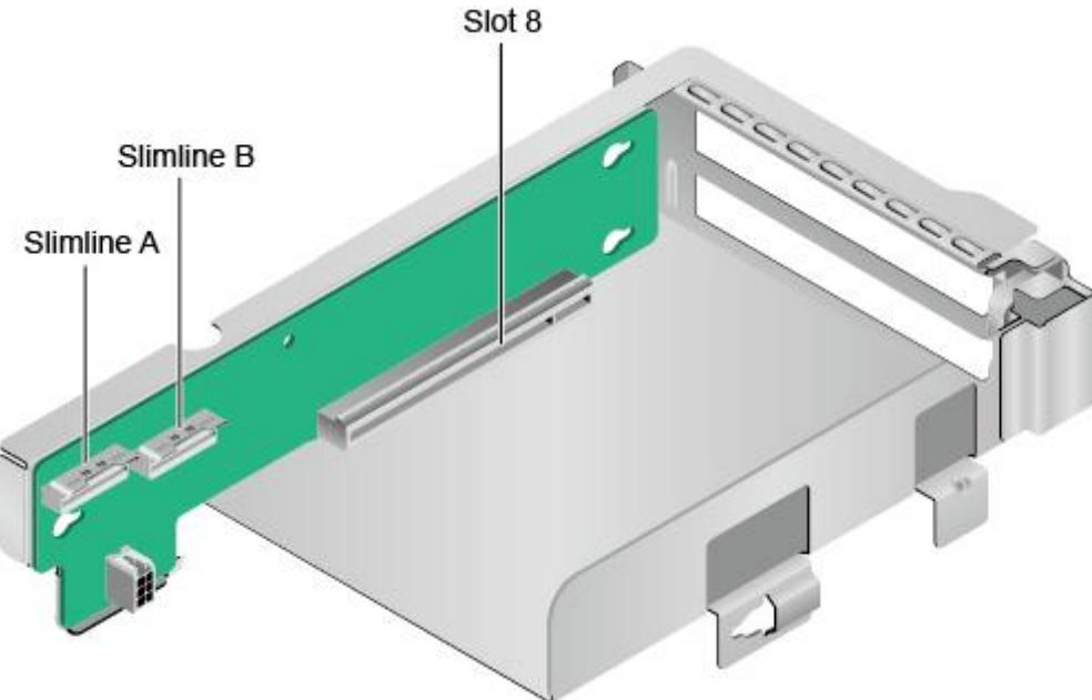
PCIe 插槽分布后视图如图 2-28 所示。
