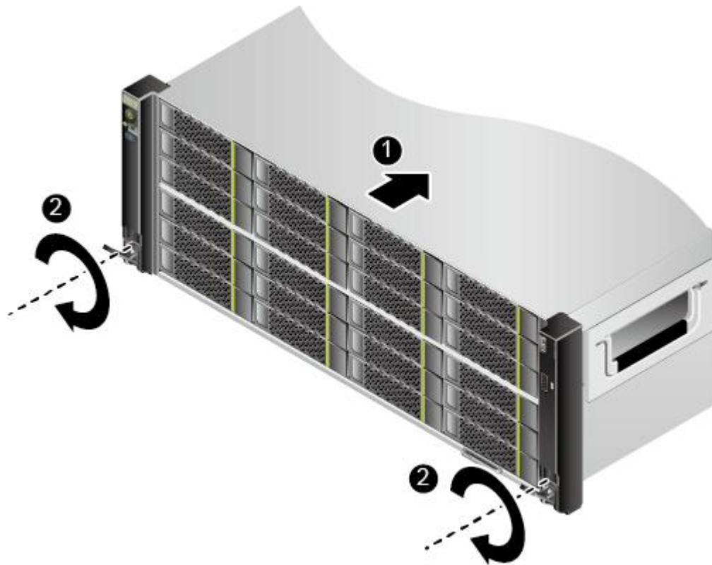
3. 如图 5-6 中②所示，将服务器两侧挂耳紧贴方孔条，按顺时针方向拧紧挂耳上的松不脱螺钉，固定服务器。
