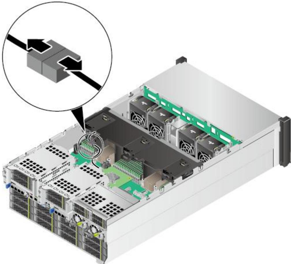
步骤 8 根据导风罩上的提示手位标识向上抬起导风罩，如图 5-38 所示。
