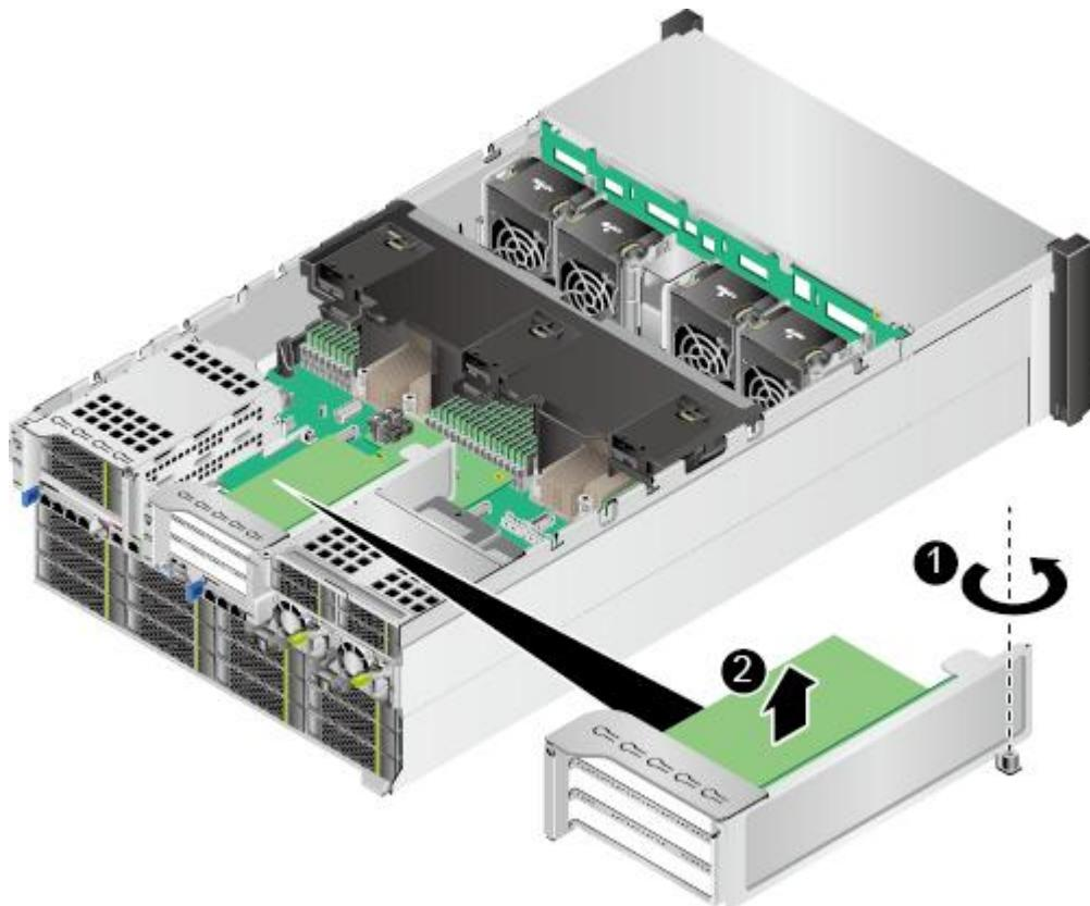
步骤 7 拆卸 Riser 模组 3 时，需要先拆卸 Riser 模组上托架，拧开固定 Riser 模组上托架的螺钉并向上抬起，如图 5-45 所示，取出 Riser 模组上托架后，再拆卸剩下的 Riser 模组下托架，如图 5-46 所示。
