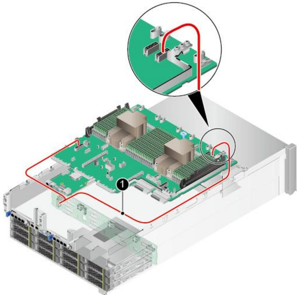
表 3-15 后置 12 盘硬盘背板的电源线
