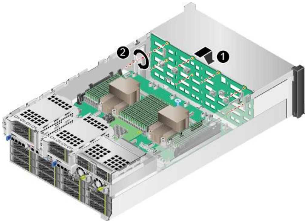
步骤 4 拧紧前置硬盘背板的固定螺钉，如图 5-86 中②所示。
