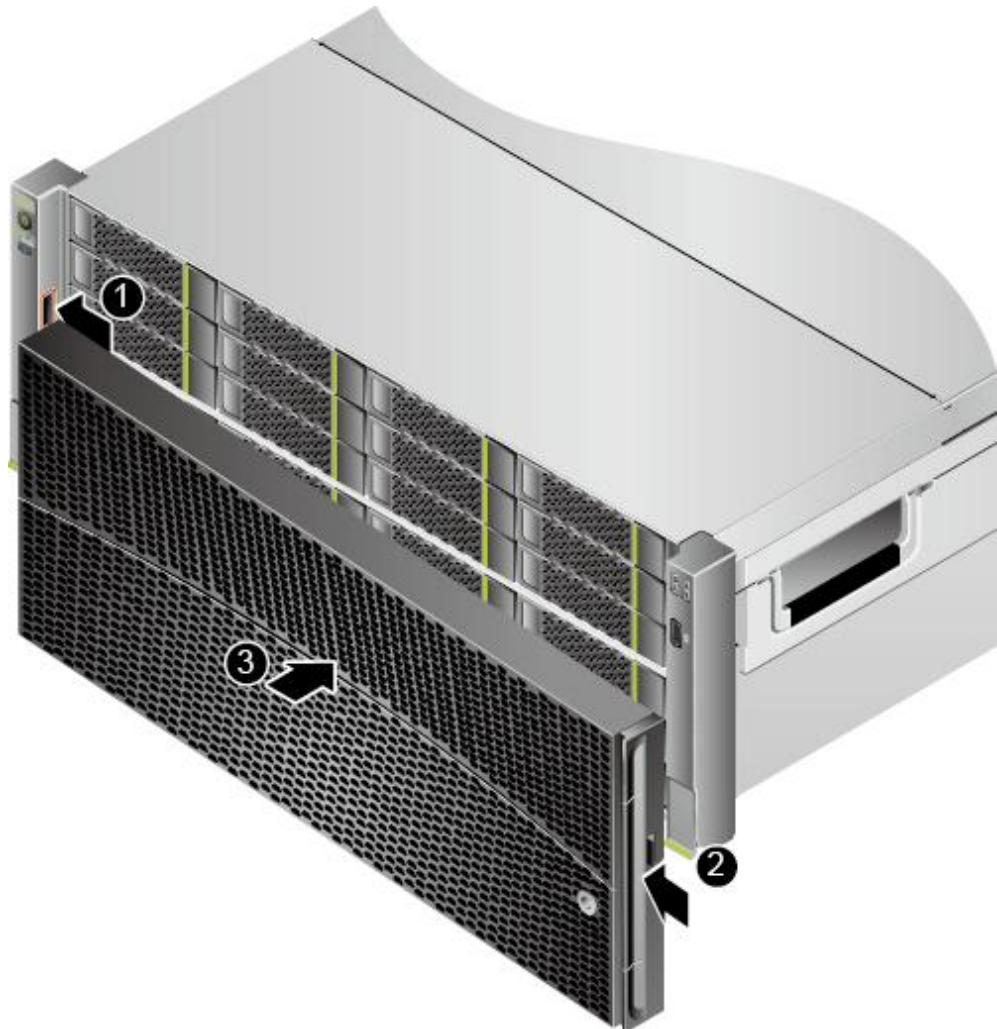
步骤 3 插入钥匙，逆时针旋转锁上安全面板，拔出钥匙，如图 5-18 中①、②所示。
