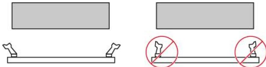
步骤 9 将 DIMM 的缺口与插槽导轨上的凸起对齐，并插入 DIMM 插槽中，如图 5-79 所示。
