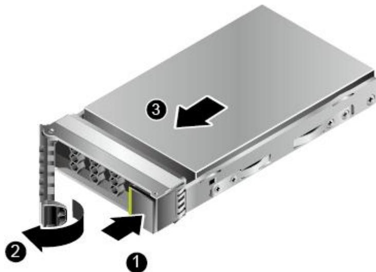
步骤 4 拉住硬盘托架扳手，将硬盘向外拔出约 3cm，硬盘脱机，如图 5-19 中②所示。对于 SAS/SATA 硬盘，硬盘脱机后，等待至少 30 秒，硬盘完全停止转动后再将硬盘拔出服务器；对于 NVMe 硬盘，硬盘脱机后，直接将硬盘拔出服务器，如图 5-19 中③所示。
