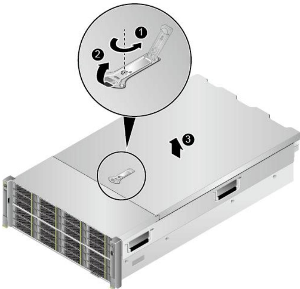
步骤 6 打开机箱盖扳手，向后推开机箱盖，如图 5-35 中②所示。
