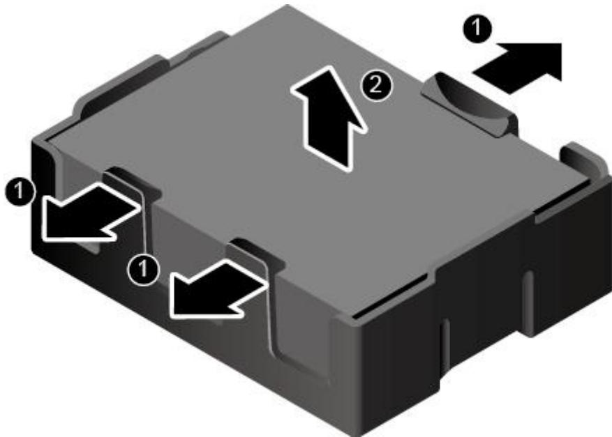
步骤 9 向上均匀用力将超级电容拔离托架，如图 5-73 中②所示。
