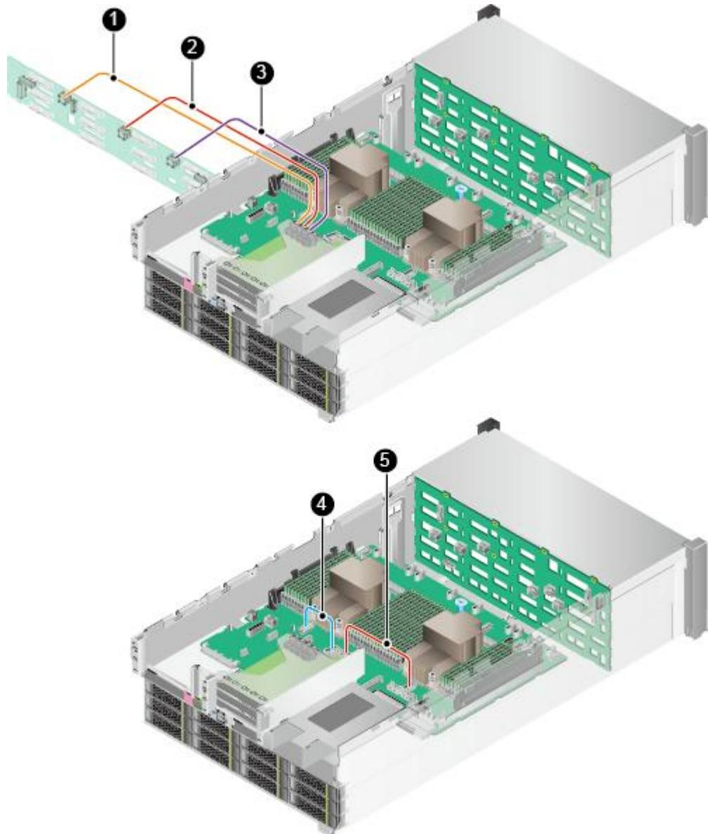
表 3-16 后置 12 盘硬盘背板和 IOB 卡的信号线
