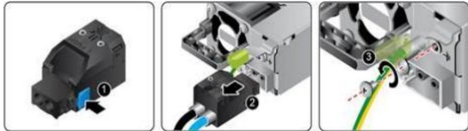
2. 使用十字螺丝刀拧下接地孔连接螺钉，将套在螺钉上的接地线拔下，如图8-41中③所示。
