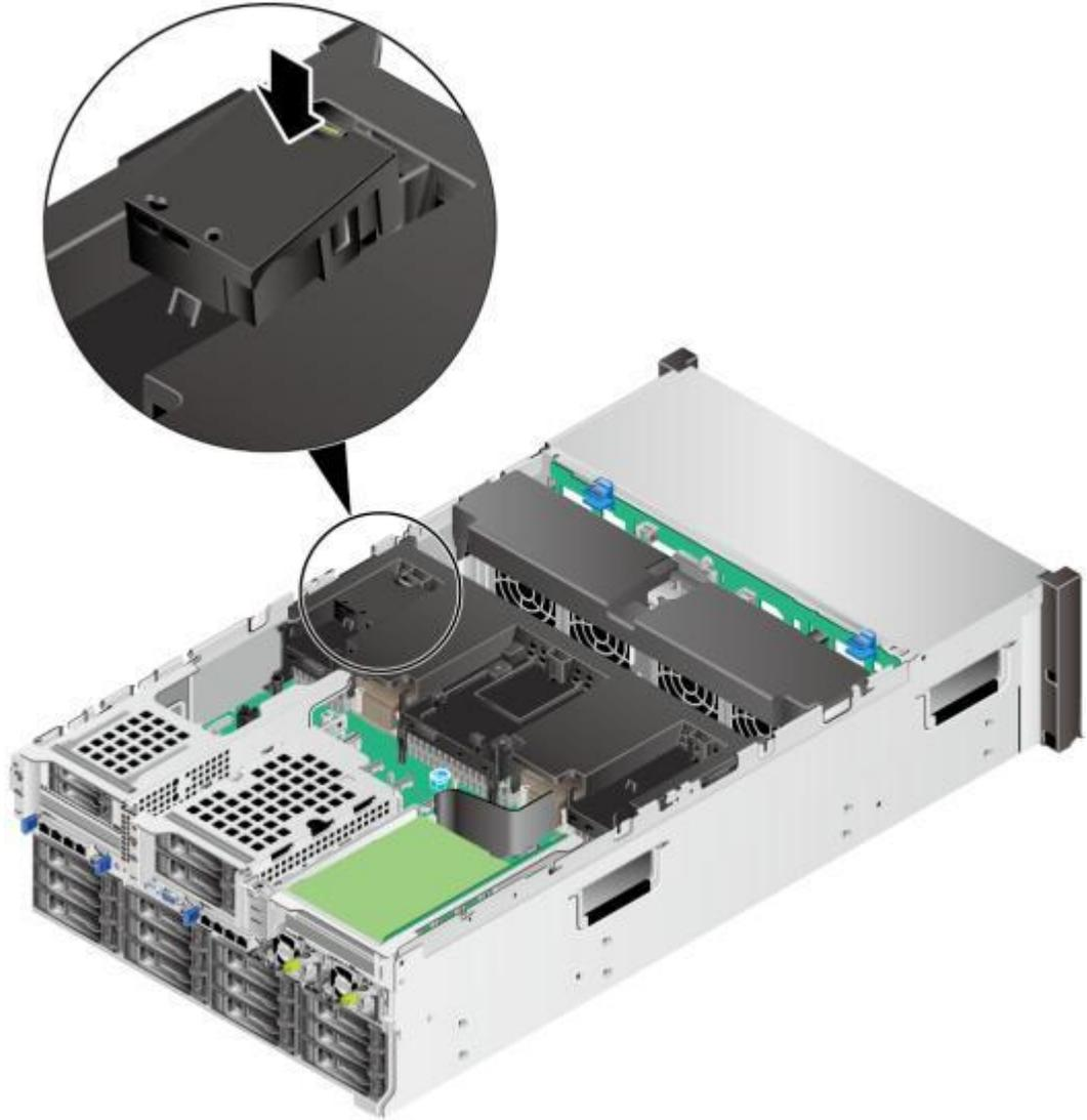
**步骤5** 连接超级电容与RAID标卡之间的连线，如图8-101所示。
