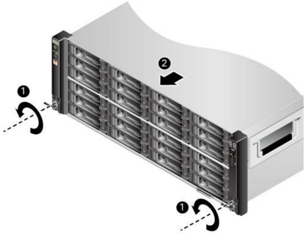
2. 如图8-5中②所示，沿滑轨向远离机柜的方向缓慢拉出服务器。
