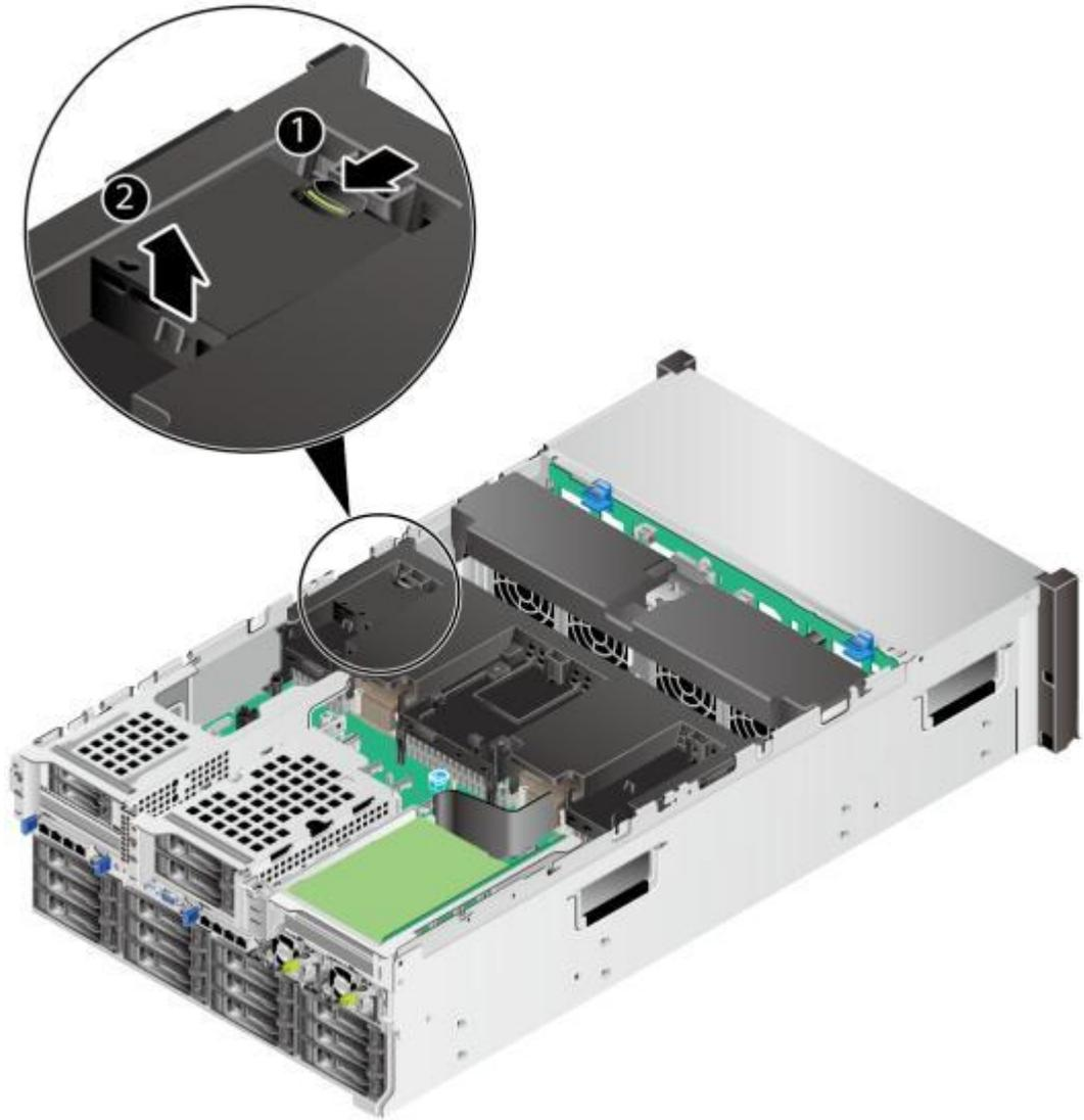
**步骤3** 沿水平方向掰开固定超级电容的塑料卡扣，如**图8-98**中①所示。
