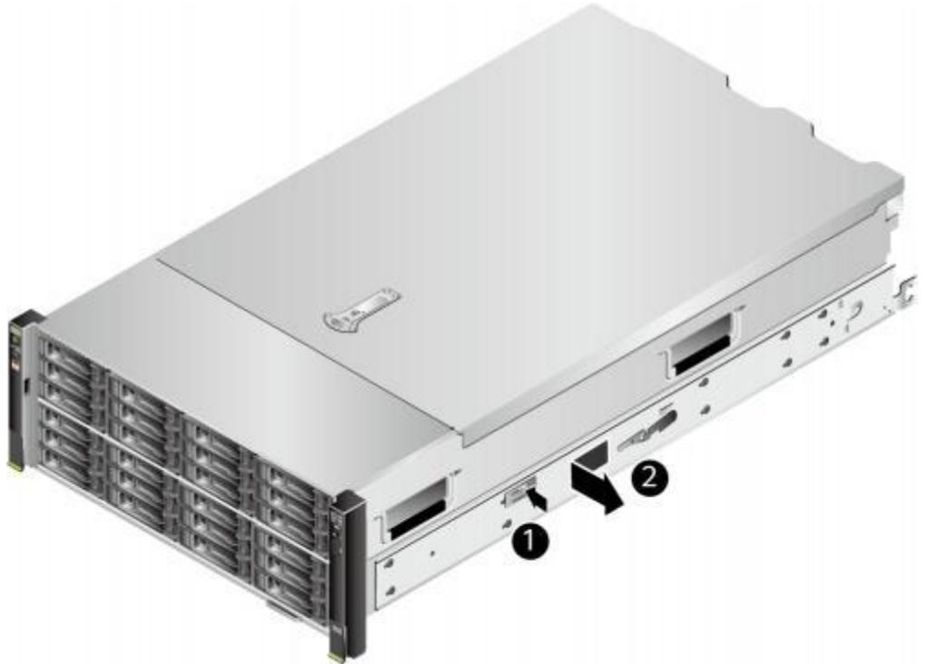
6. 将拆卸的内轨插入中轨。抬起拨杆，推动内轨，使其完全进入轨道。如图8-11 ① ②所示。
