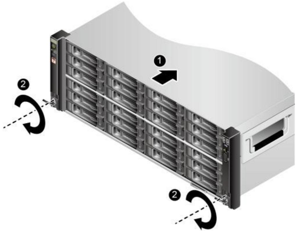
3. 如图8-18中②所示，将服务器两侧挂耳紧贴方孔条，按顺时针方向拧紧挂耳上的松不脱螺钉，固定服务器。
