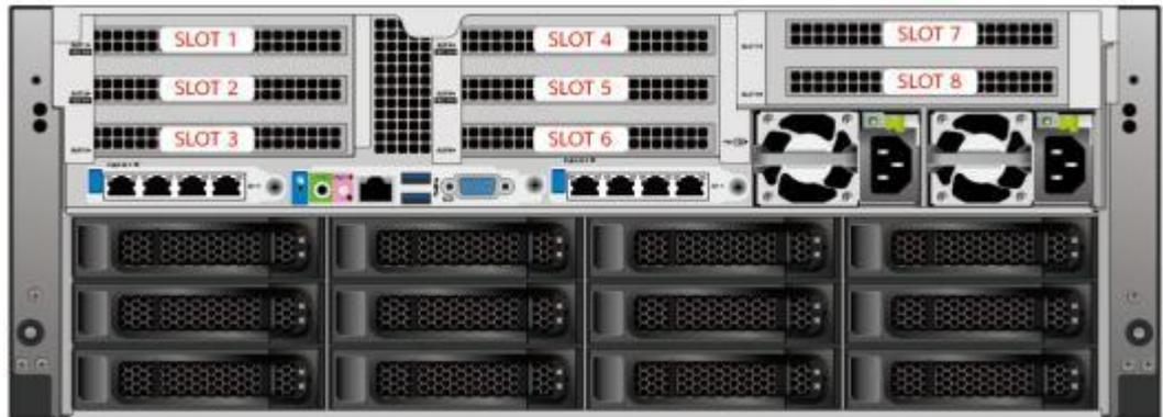
IO模组1提供的槽位为Slot 1 ~ Slot 3; IO模组2提供的槽位为Slot 4 ~ Slot 6; IO模组3提供的槽位为Slot 7 ~ Slot 8。
