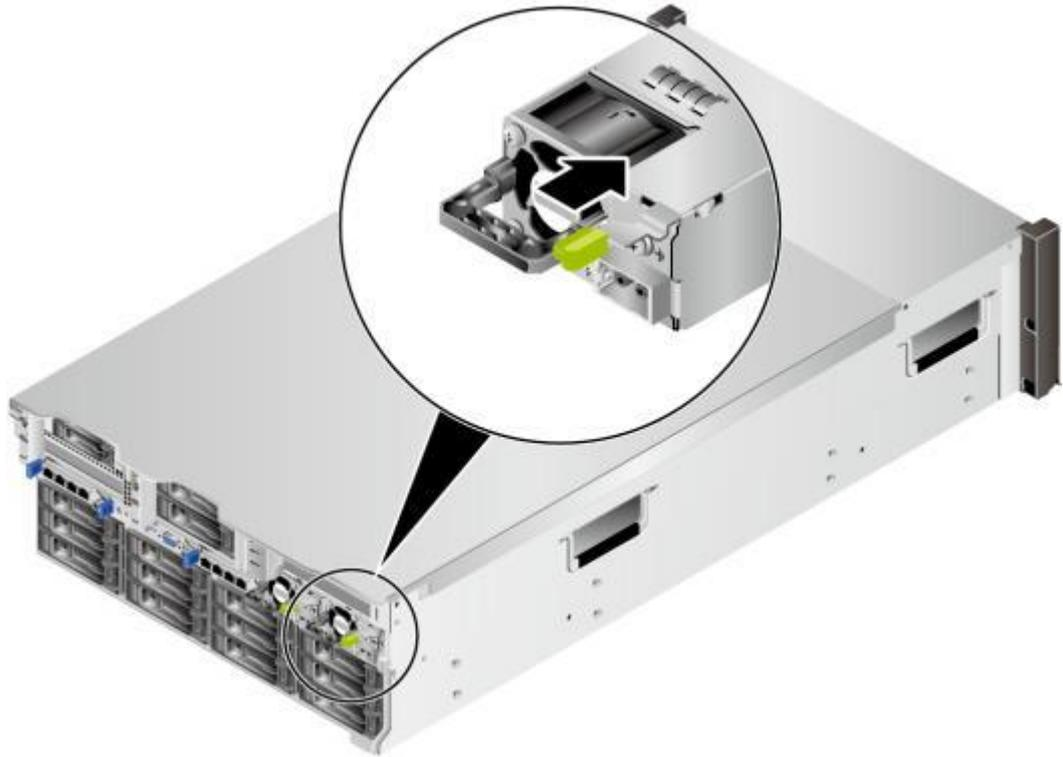
**步骤5** 安装电源模块线缆。
