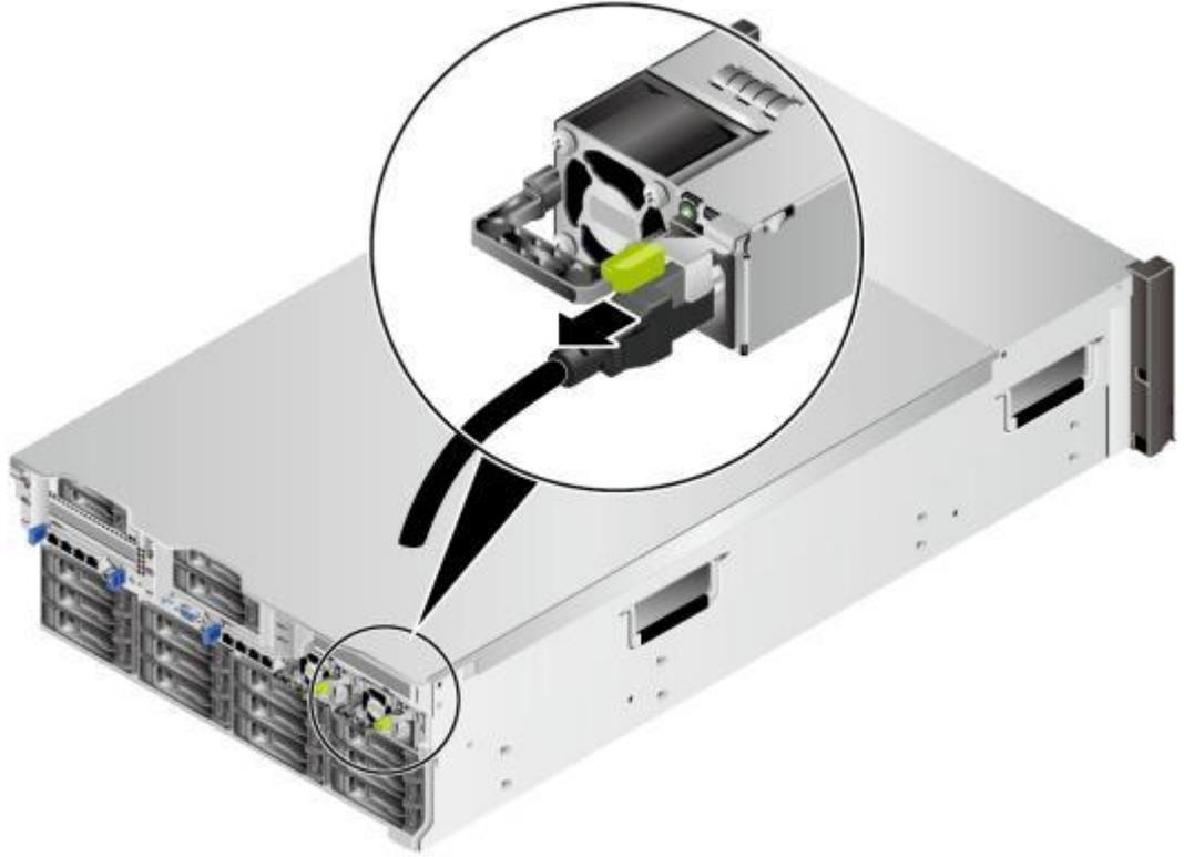
**步骤6** 沿箭头方向按住电源模块弹片，同时用力拉住扳手，向外拔出电源模块，如图8-35所示。
