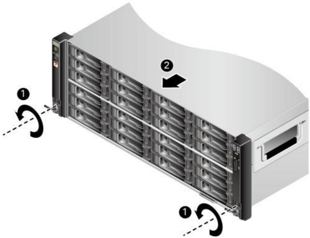
2. 如**图8-8**中②所示，沿滑轨向远离机柜的方向缓慢拉出服务器。
