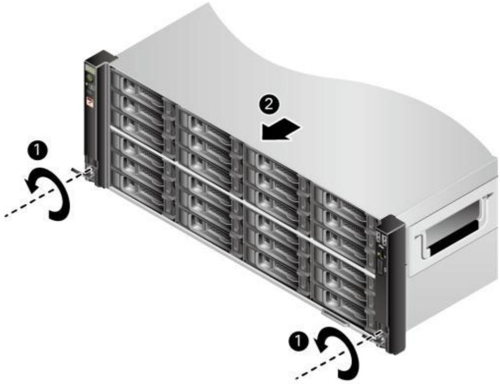
2. 如图8-3中②所示，沿滑轨向远离机柜的方向缓慢拉出服务器。
