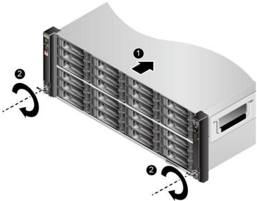
3. 如图8-16中②所示，将服务器两侧挂耳紧贴方孔条，按顺时针方向拧紧挂耳上的松不脱螺钉，固定服务器。
