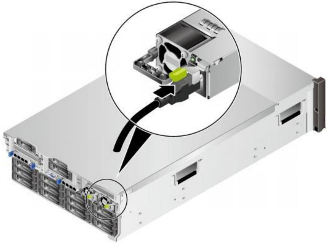
**步骤6** 用魔术贴固定好电源线缆，如[图8-40](#)所示
