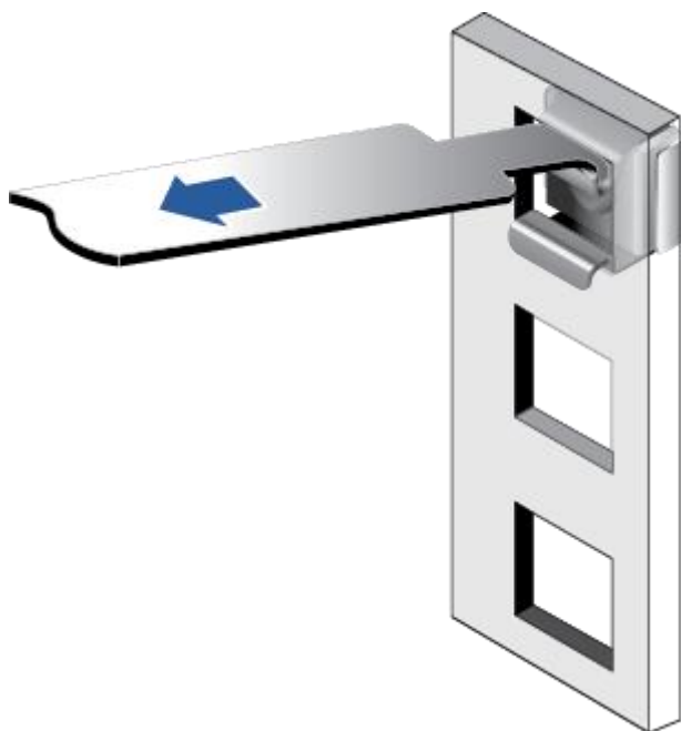
图 6-6 在机柜中安装浮动螺母
